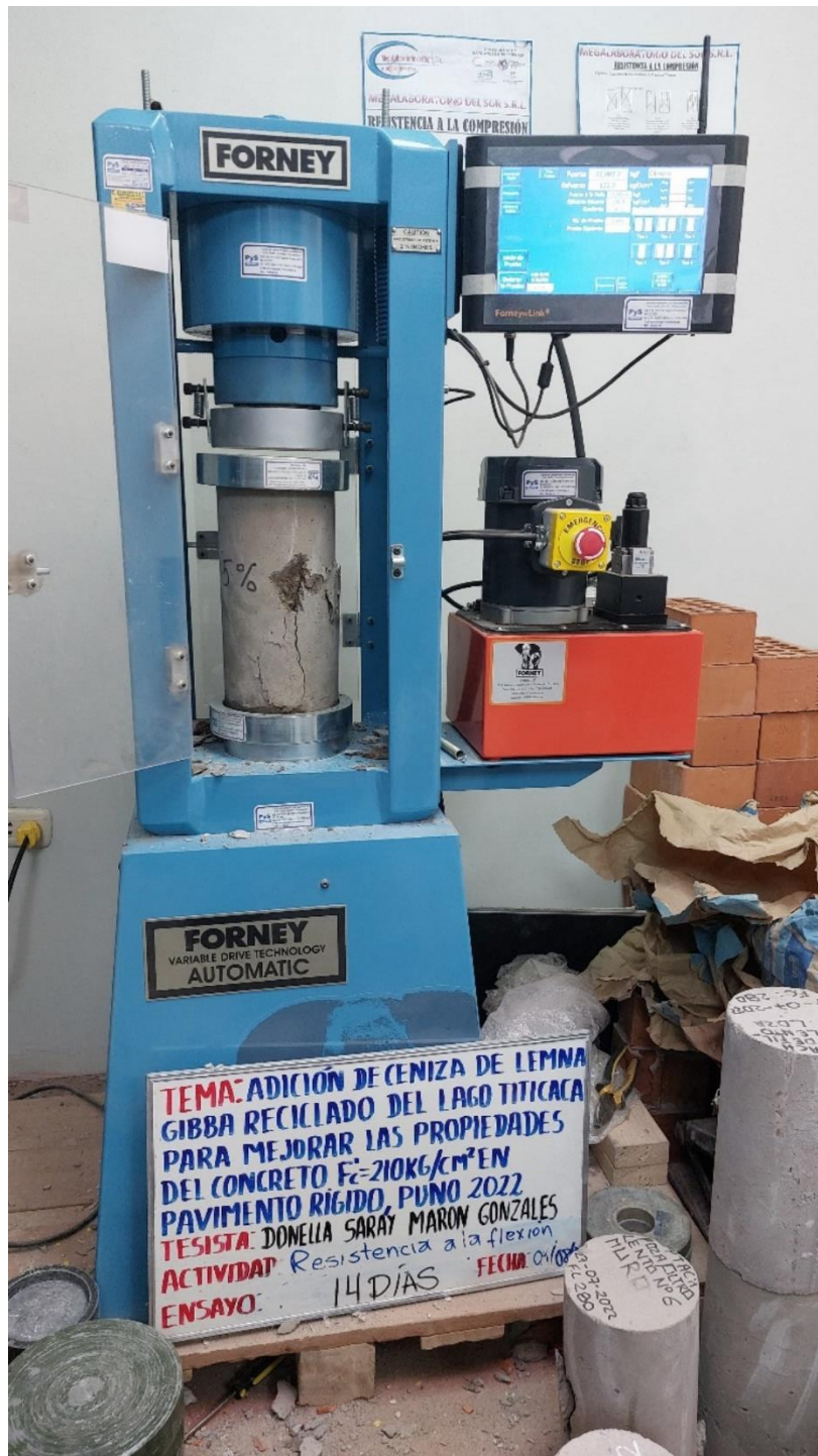
Fotografía 22. Realización de ensayo de compresión de testigo con 5% de ceniza, con una edad de 14 días.
