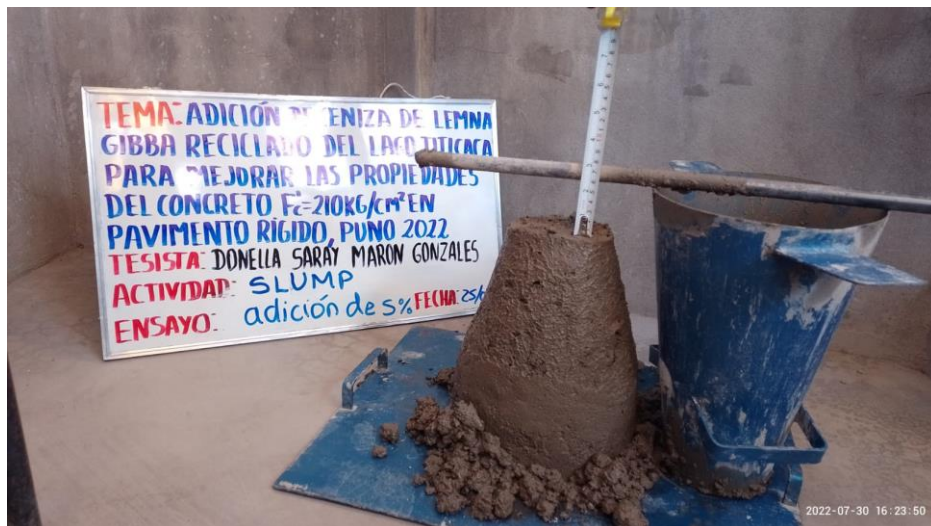
Figura 12. Prueba de Slump
