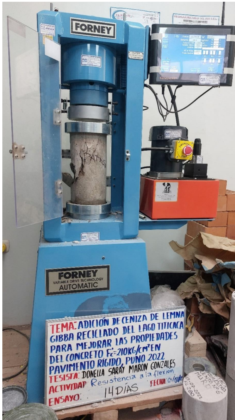
Fotografía 20. Realización de ensayo de compresión de testigo patron, con una edad de 14 días.
