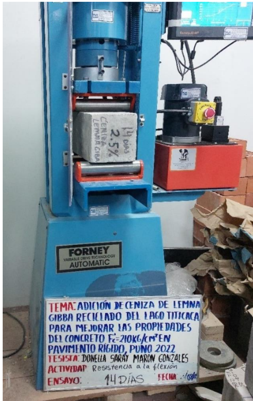
Fotografía 15. Ensayo de Flexión a testigo con 2.5% de ceniza, con una edad de 14 días.
