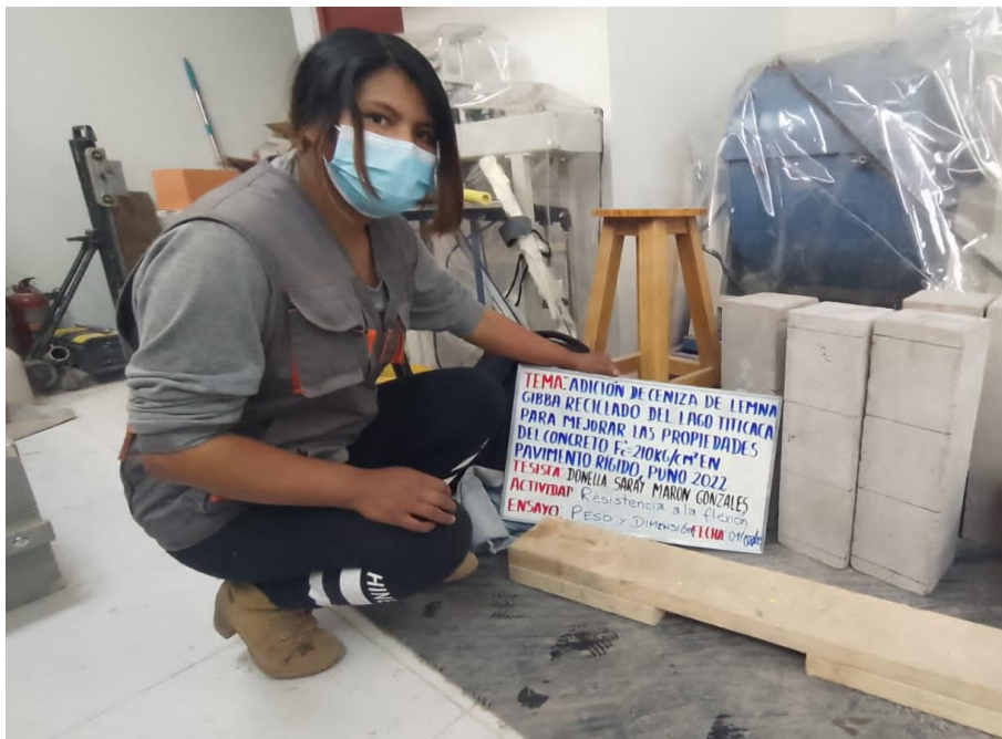
Figura 18. Muestra para ensayos de flexión. Fuente: Elaboración propia.
