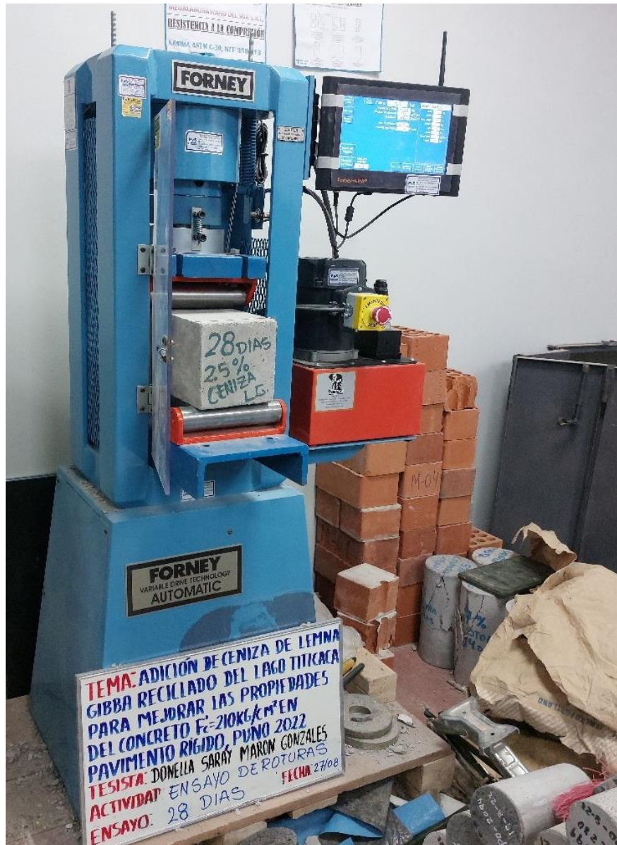
Fotografía 28. Realización de ensayo de flexión a testigo con 2.5% de ceniza, con una edad de 28 días.
