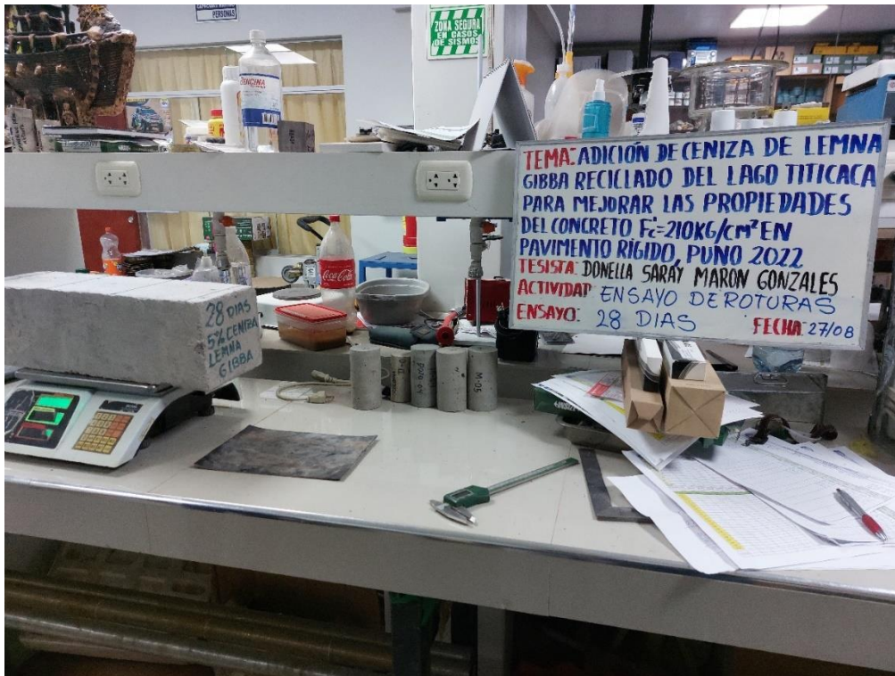
Fotografía 26. Realización toma de pesado a testigo con 5% de ceniza, con una edad de 28 días.
