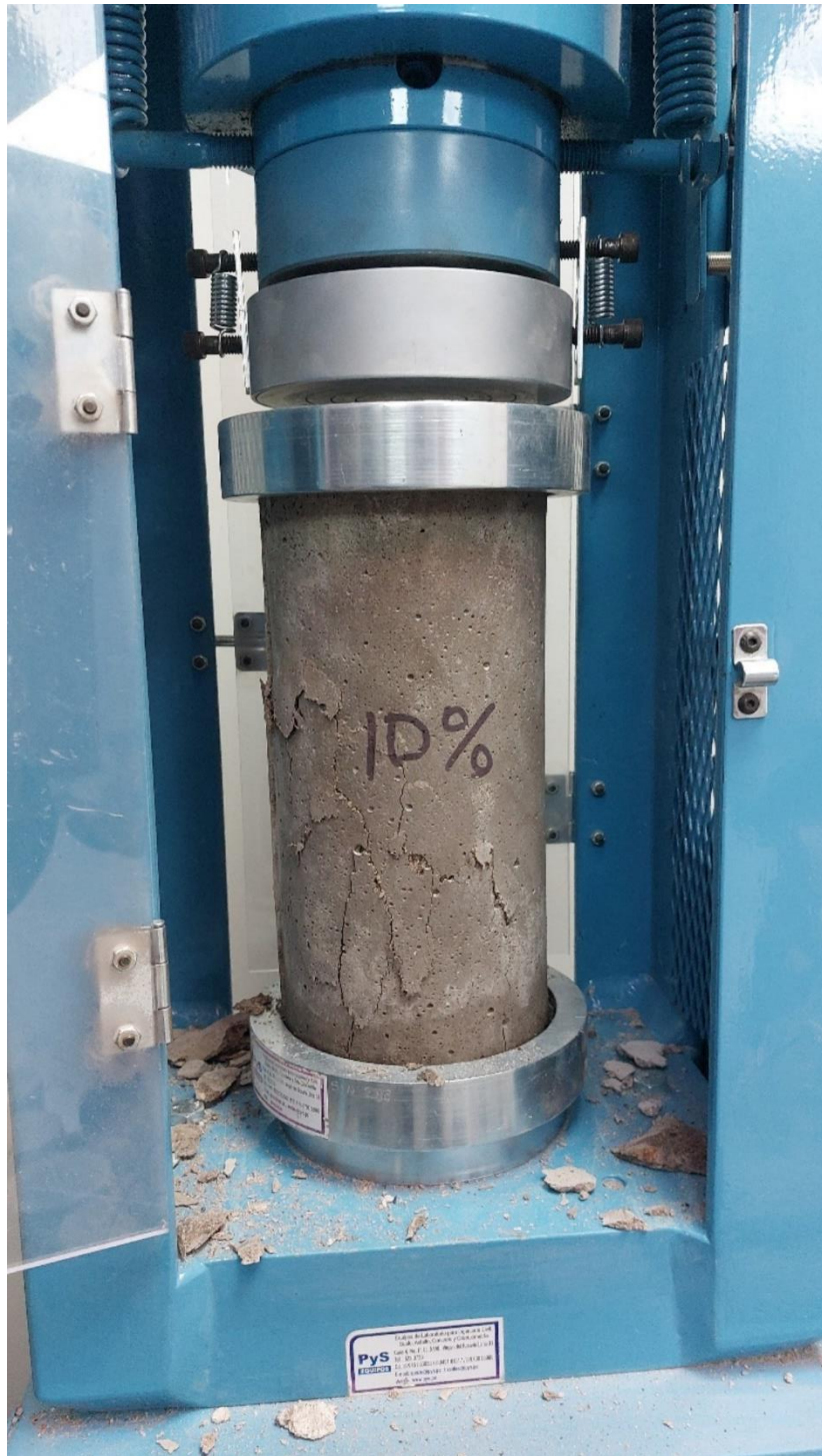
Fotografía 23. Realización de ensayo de compresión de testigo con 10% de ceniza, con una edad de 14 días.
