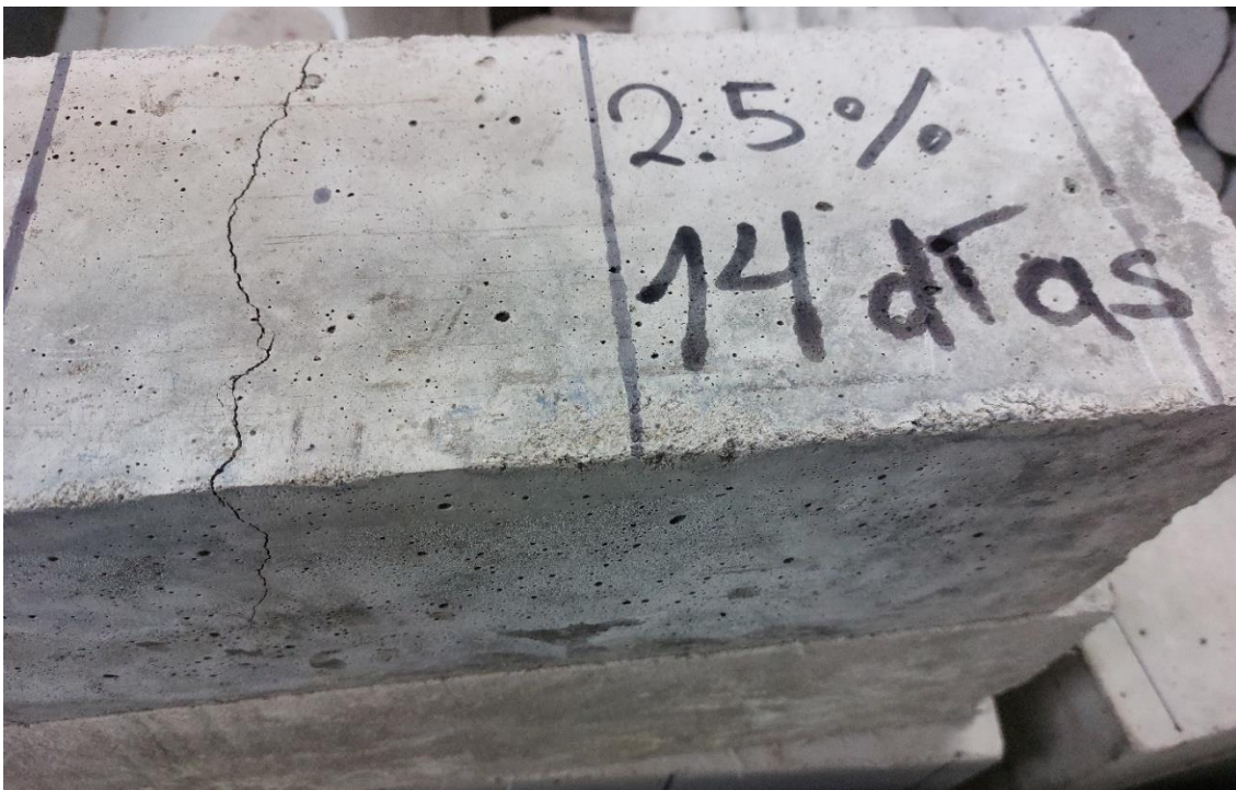
Fotografía 11. Testigo con 2.5% de ceniza con una edad de 14 luego de haber realizado el ensayo de flexión el laboratorio.
