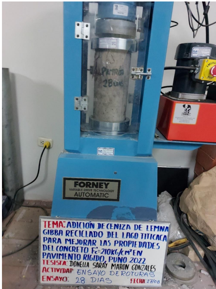
Fotografía 33. Realización de ensayo de Compresión a testigo patron, con una edad de 28 días.
