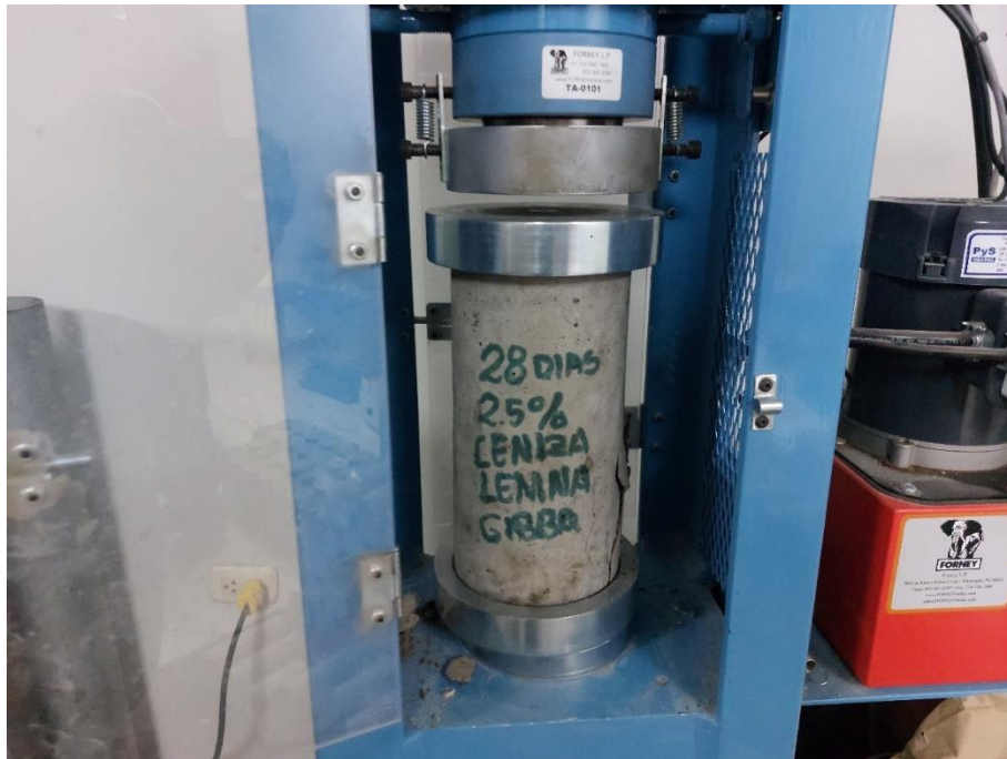
Fotografía 34. Realización de ensayo de Compresión a testigo con 2.5% de ceniza, con una edad de 28 días.
