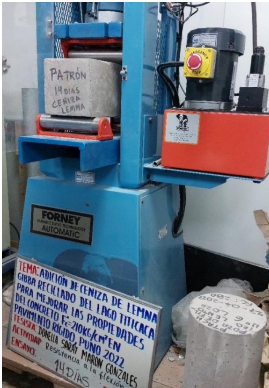
Fotografía 14. Ensayo de Flexión a testigo patrón con una edad de 14 días.
