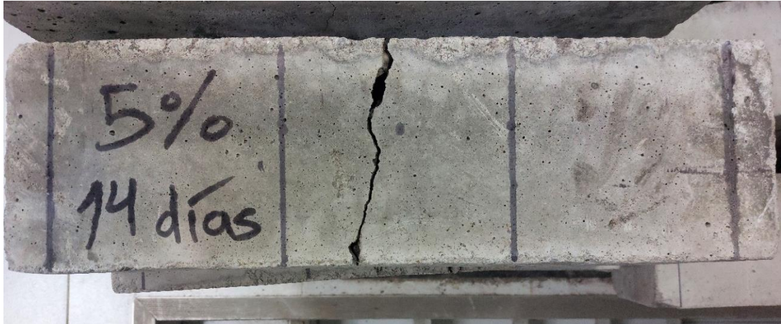
Fotografía 12. Testigo con 5% de ceniza con una edad de 14 luego de haber realizado el ensayo de flexión el laboratorio.
