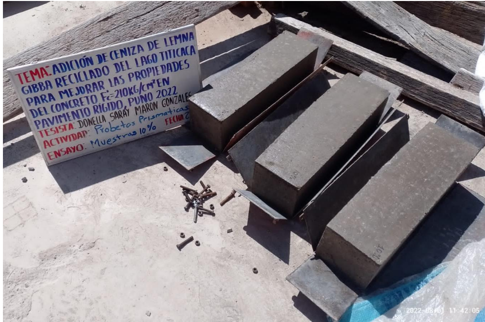
Figura 17. Testigos para el ensayo de flexión Fuente: Elaboración propia.
