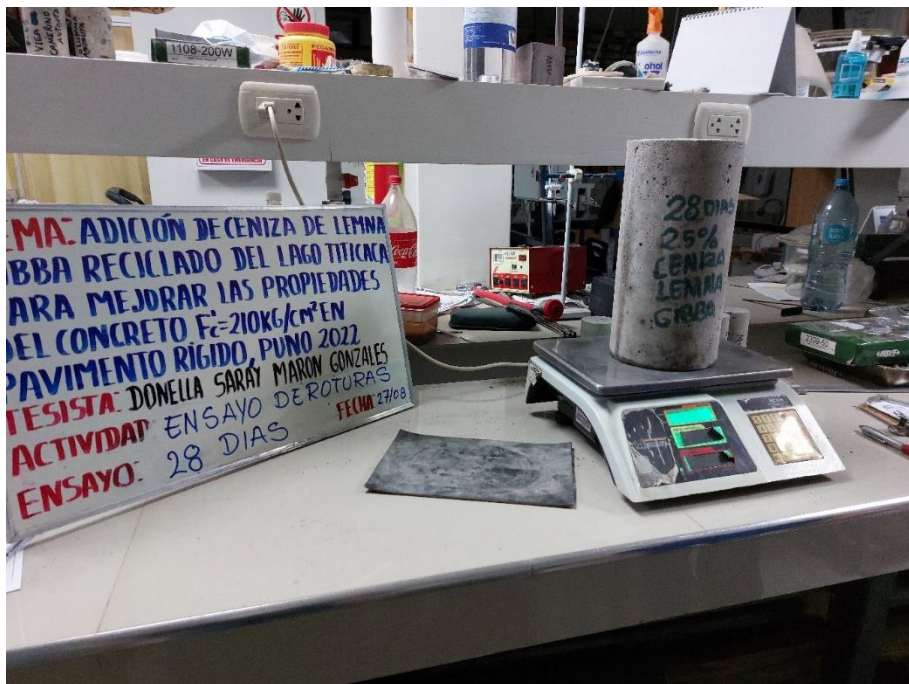
Fotografía 32. Realización toma de pesado a testigo con 2.5% de ceniza, con una edad de 28 días.
