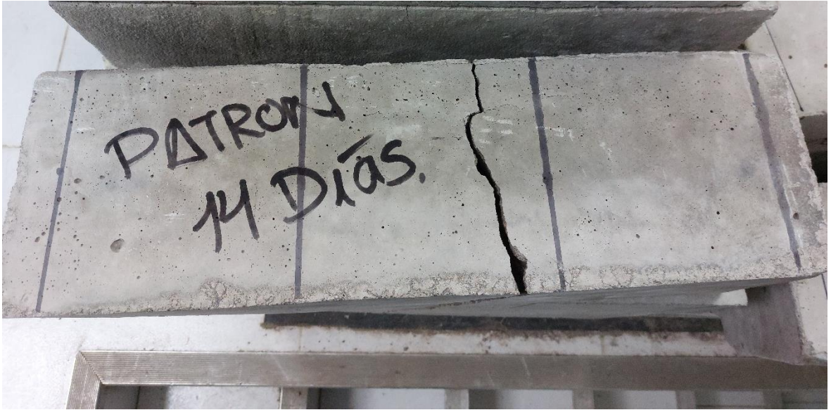
Fotografía 10. Testigo patrón con una edad de 14 luego de haber realizado el ensayo de flexión el laboratorio.
