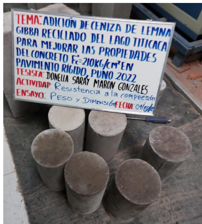
Figura 15. Testigos para el ensayo de compresión Fuente: Elaboración propia.
