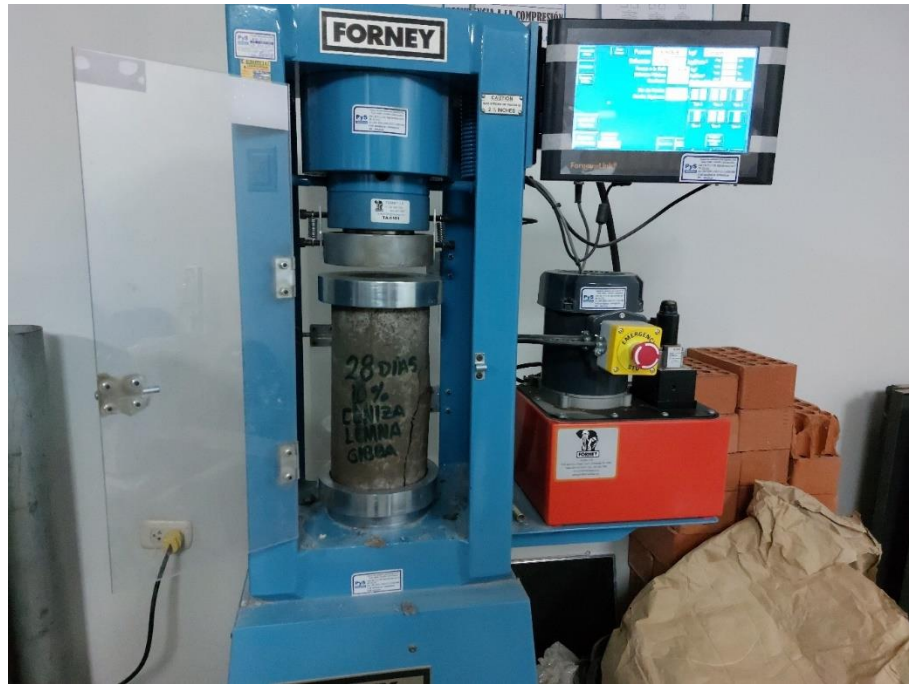
Fotografía 36. Realización de ensayo de Compresión a testigo con 10% de ceniza, con una edad de 28 días.
