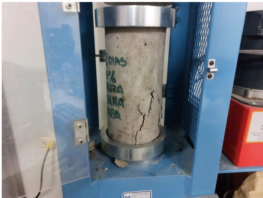
Fotografía 35. Realización de ensayo de Compresión a testigo con 5% de ceniza, con una edad de 28 días.
