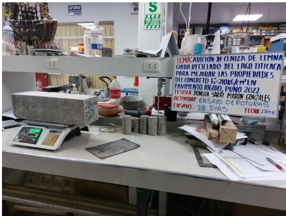
Fotografía 24. Realización de pesado a testigo con 2.5% de ceniza, con una edad de 28 días.
