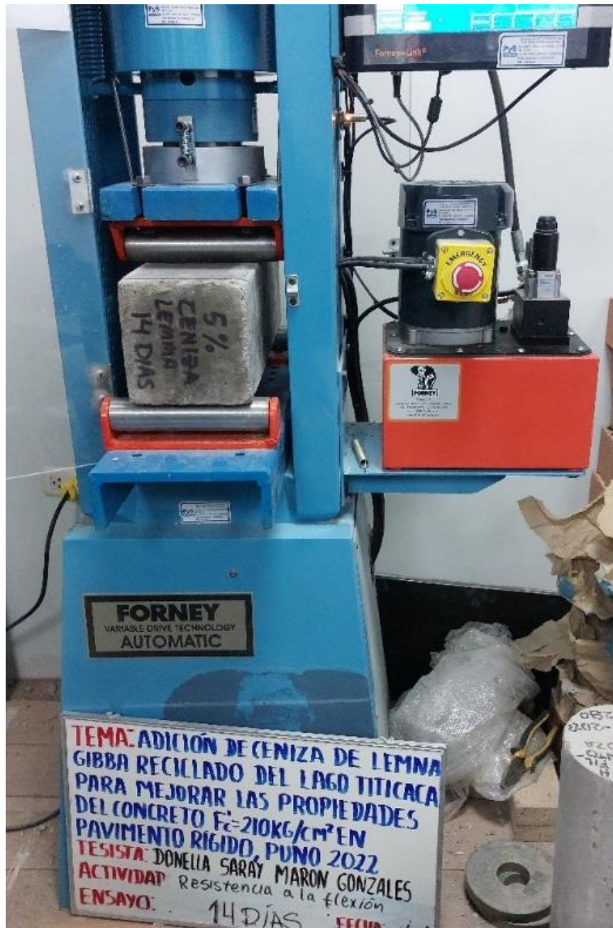
Fotografía 16. Ensayo de Flexión a testigo con 5% de ceniza, con una edad de 14 días.
