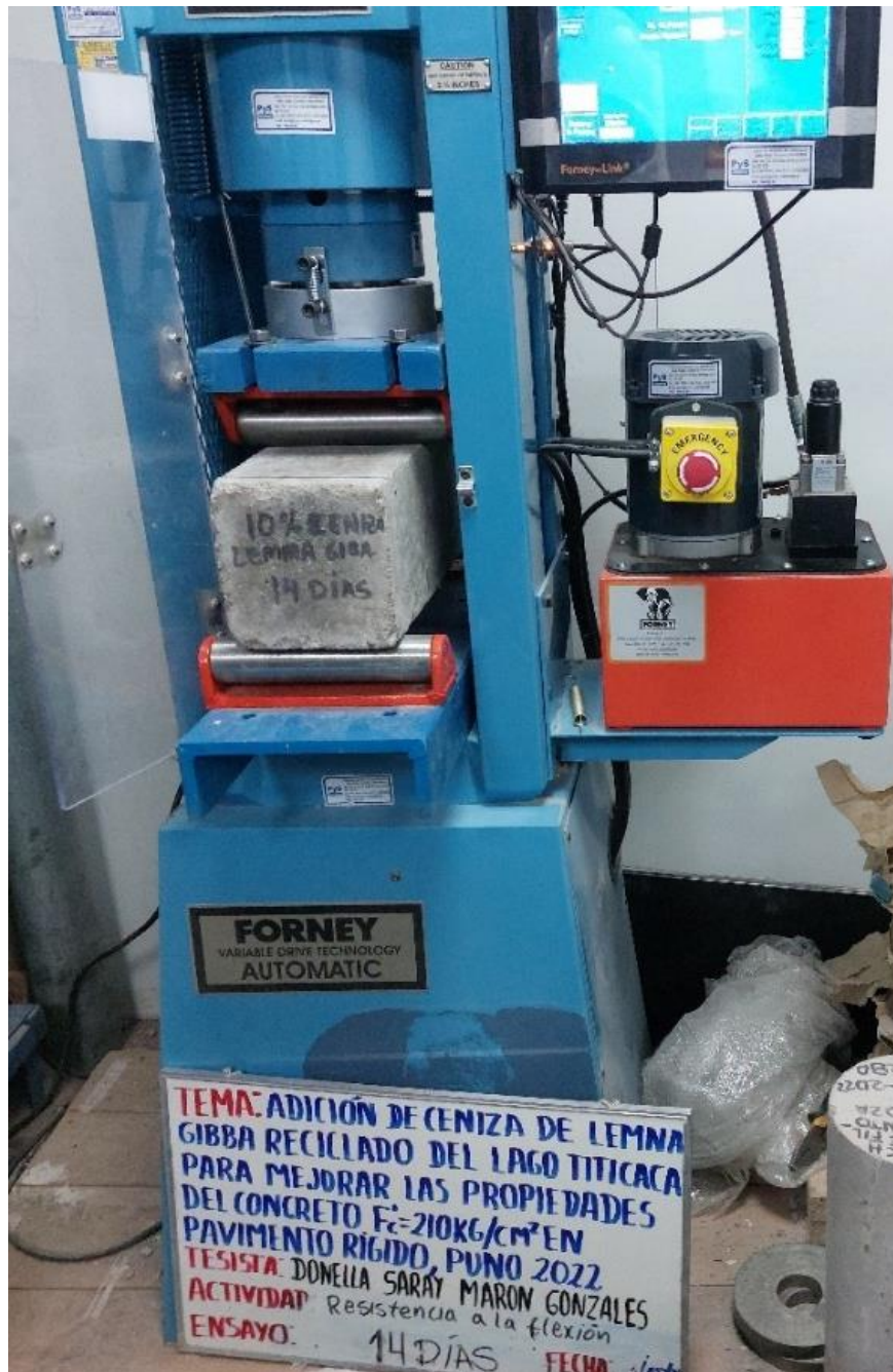
Fotografía 17. Ensayo de Flexión a testigo con 10% de ceniza, con una edad de 14 días.
