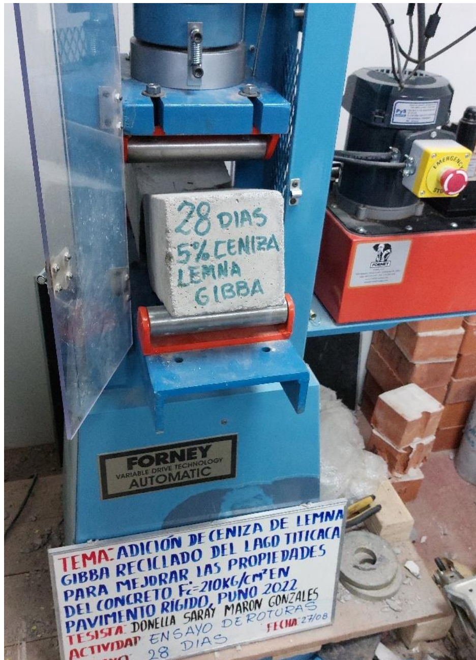
Fotografía 28. Realización de ensayo de flexión a testigo con 5% de ceniza, con una edad de 28 días.
