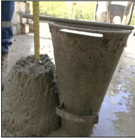
Figura 13. Ensayo de asentamiento del concreto.
