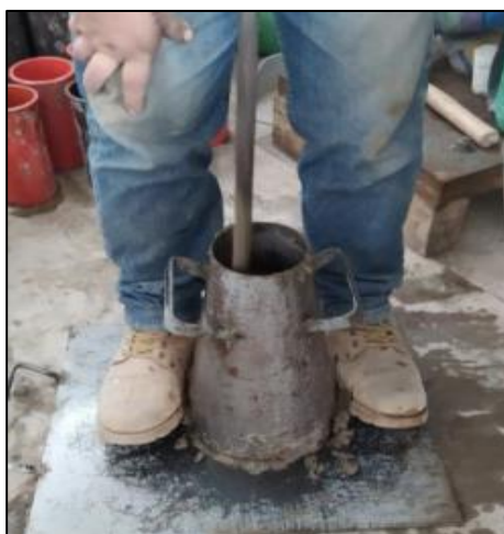
Figura 5. Ensayo de asentamiento.
