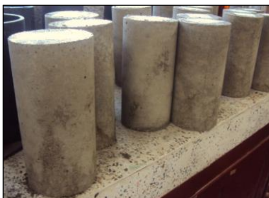
Figura 18. Probetas elaboradas de concreto patrón y con incorporación de las fibras de vástago de plátano.
