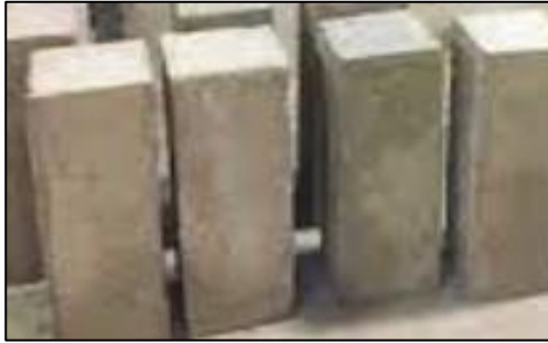
Figura 22. Viguetas elaboradas de concreto patrón y con la incorporación de fibras de vástago de plátano.
