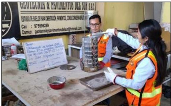
**Figura 10:** Tamizaje del agregado fino
