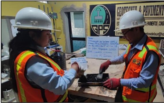
**Figura 12:** Preparación de mezcla asfáltica
