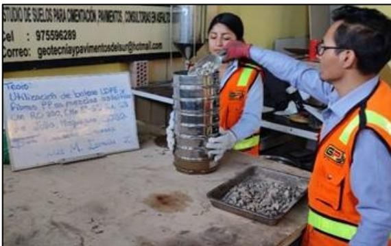
**Figura 9:** Tamizaje del agregado grueso
