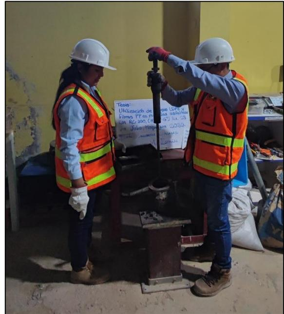
**Figura 13:** Compactación de probeta
