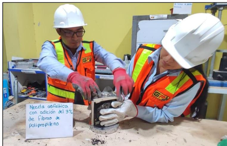
**Figura 15:** Colocando probetas para el ensayo Marshall
