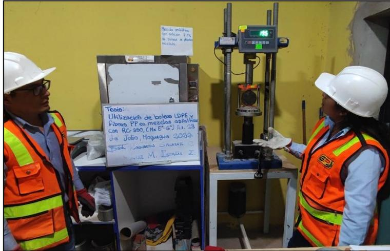
**Figura 16:** Realizando ensayo con equipo Marshall
