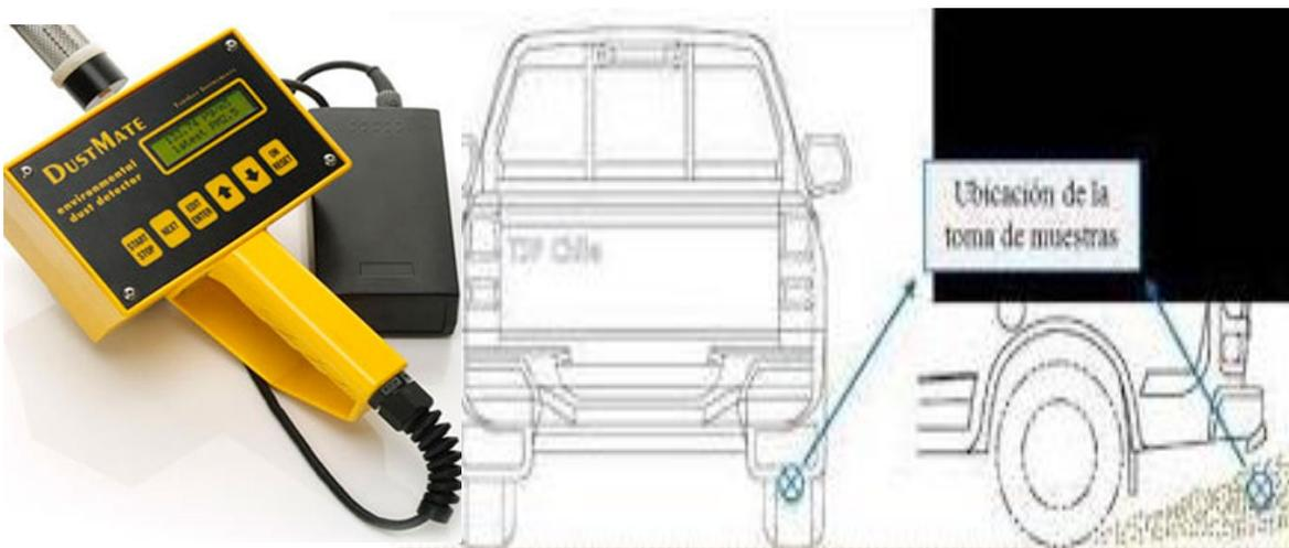
El monitoreo se lleva a cabo detrás de la rueda trasera del vehículo en una distancia de 40 cm de la superficie de rodadura para captar la cantidad de polvo producto de generación de neumáticos en las vías. Para cuantificar la concentración de partículas menores a PM10 a través de un sensor fotométrico laser. Que define la cantidad de pcc PM 1.0  $\mu\text{m}$  ( $\text{m}^3$ ) que posee un centímetro cúbico de aire en suspensión.
