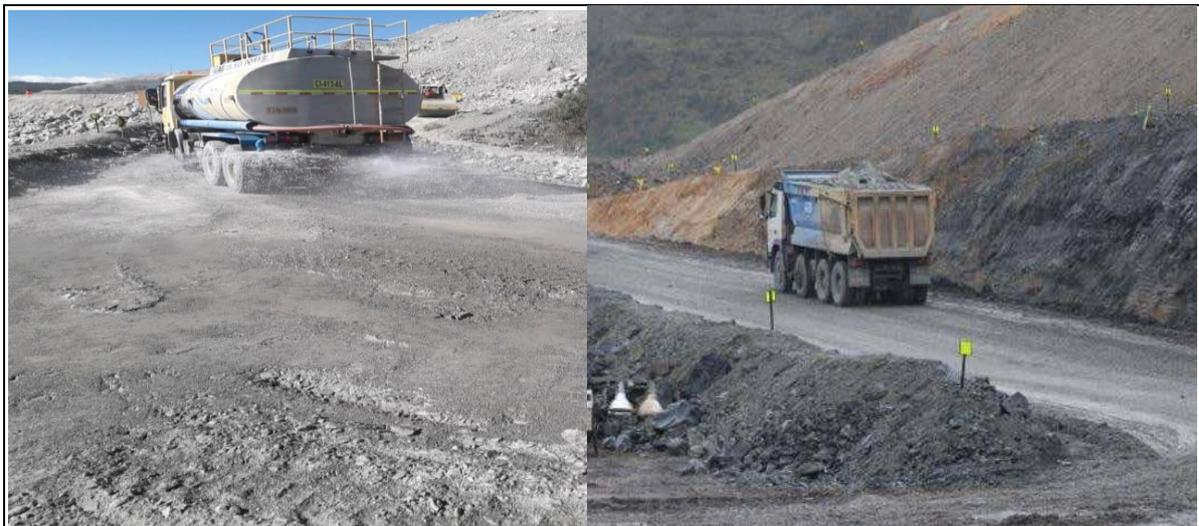
**Figura 4.** Ventajas del supresor dl10 plus en reducción de formación de pozas y barro.
