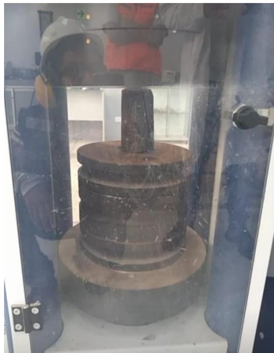
Figura 47: Testigo fragmentado tras el ensayo uniaxial Elaboración propia.
