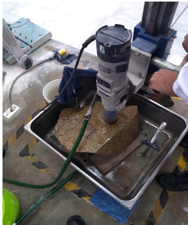
Figura 37: Perforando la roca. Elaboración propia.
