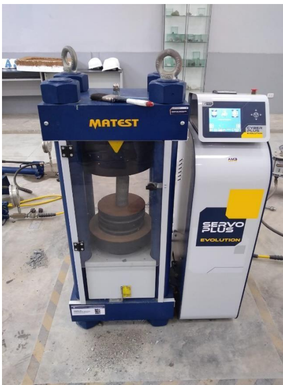
Figura 44: Máquina para realizar el ensayo uniaxial Elaboración propia.
