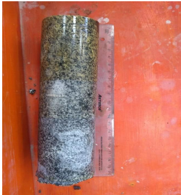
Figura 39: Testigo N° 2 obtenido luego de la perforación Elaboración propia.
