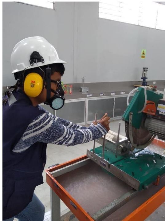
Figura 41: Uso de la maquina cortadora diamantina
