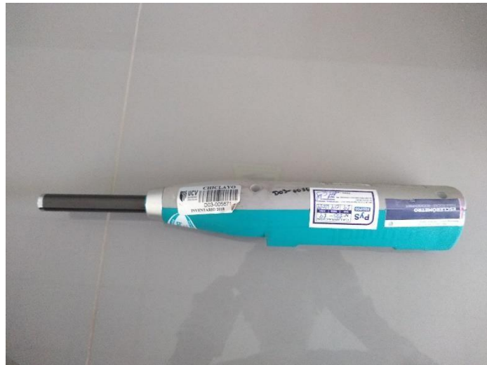
Figura 33: Esclerómetro Silver Schmidt marca Proceq. Elaboración propia.
