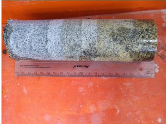
Figura 38: Testigo N° 1 obtenido luego de la perforación Elaboración propia.
