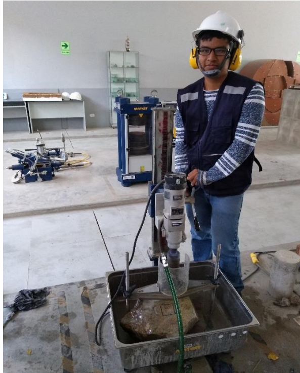
Figura 36: Uso de la perforadora diamantina saca testigos. Elaboración propia.
