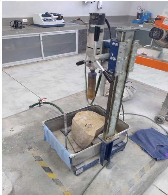
Figura 35: Perforadora diamantina saca testigos. Elaboración propia.
