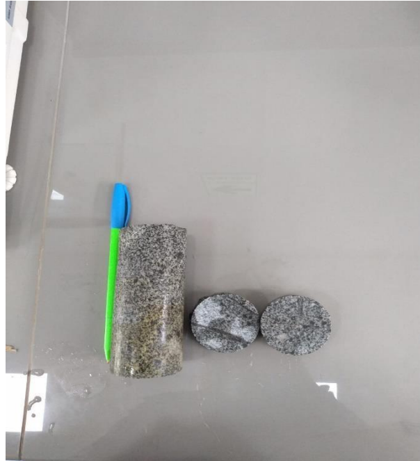
Figura 42: Trozas de roca obtenidos luego de usar la maquinacortadora diamantina Elaboración propia.
