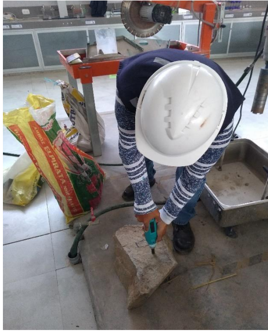
Figura 34: Uso del esclerómetro. Elaboración propia.
