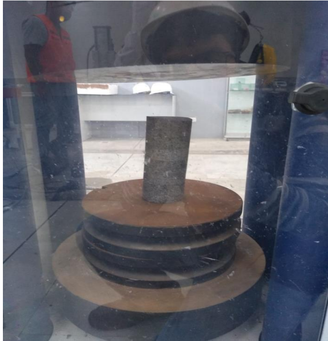
Figura 46: Testigo a punto de ser sometido a un ensayo uniaxial Elaboración propia.
