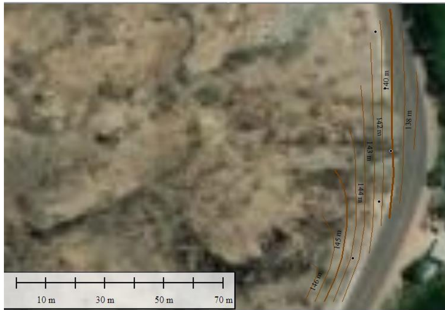
Figura 76: Curvas de nivel plasmadas en la zona de estudio Fuente: Global Mapper
