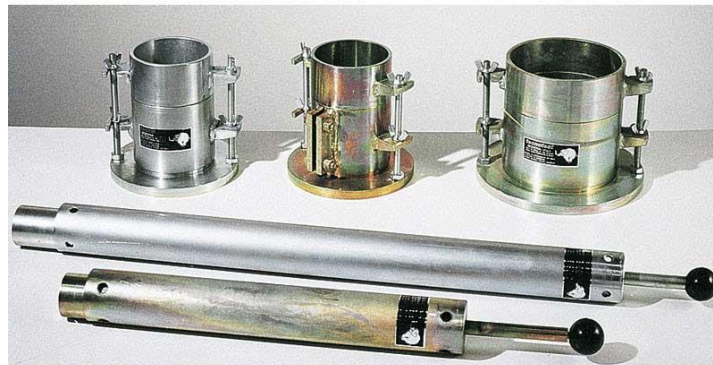
Figura 5. Moldes para los Pruebas Proctor estándar y modificado.
