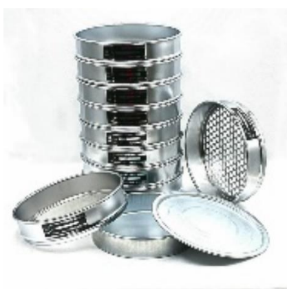
Figura 3. Tamices para la granulometría.
