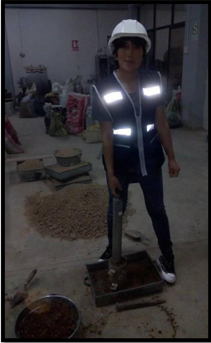
Se hizo la compactación para la prueba del Proctor Modificado de la tierra sin aditivo y con aditivos (residuos de conchas de mejillón y la cal viva).
