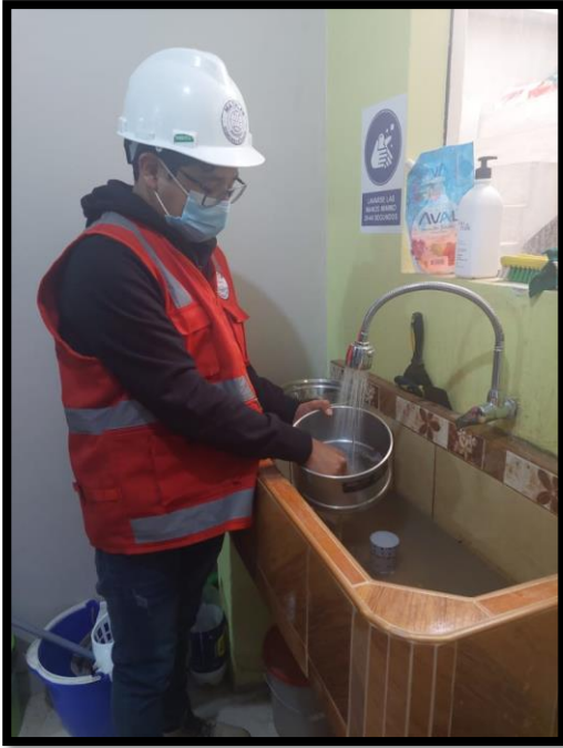
Se realizo el lavado del material para la granulometría de los materiales finos.
