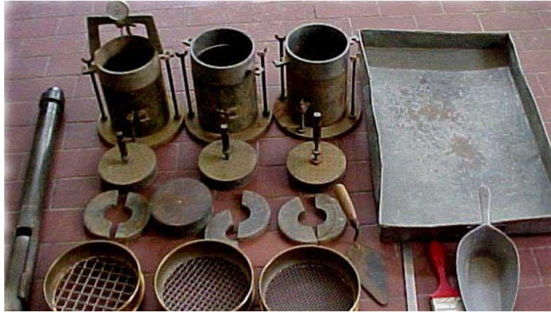
Figura 6. Moldes para el ensayo de CBR.
