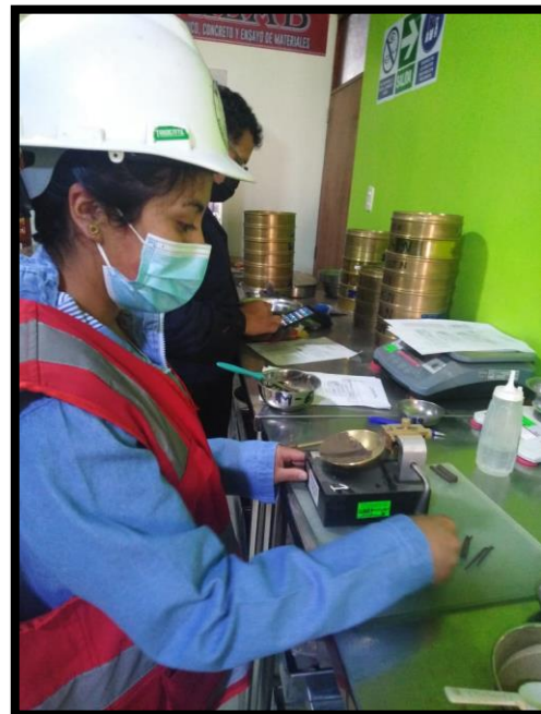
Se determino el límite liquido mediante el uso del instrumento Casa Grande.
