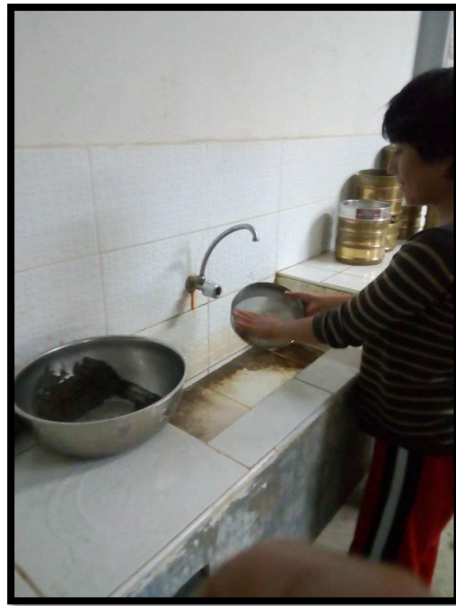
Se realizo el lavado del material para la granulometría de los materiales finos.
