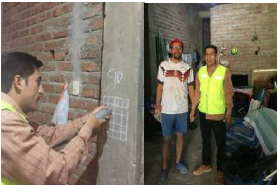
Haciendo las pruebas con esclerometría y encontrar los números de rebotes en columnas
