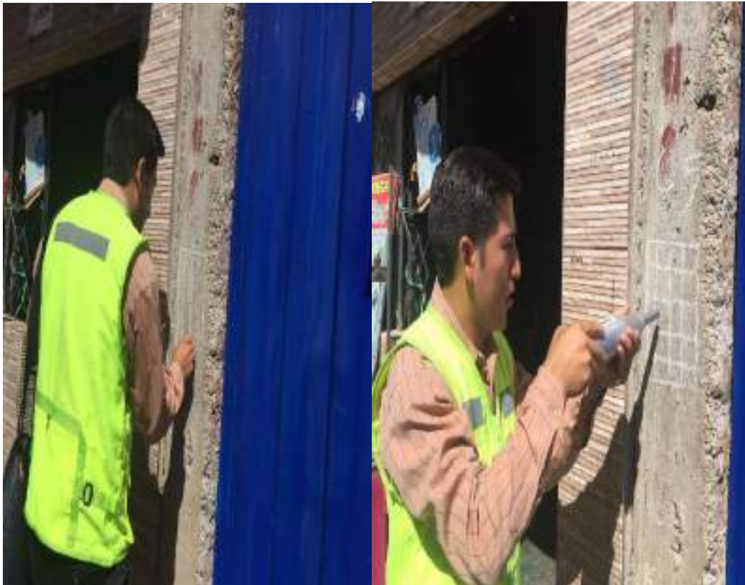
Medición con wincha para el ensayo donde se va hacer los numero de rebotes
