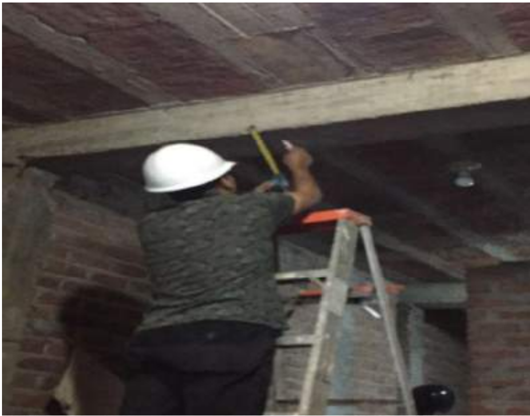
Evaluacion en vigas con esclerometria en viviendas seleccionadas
