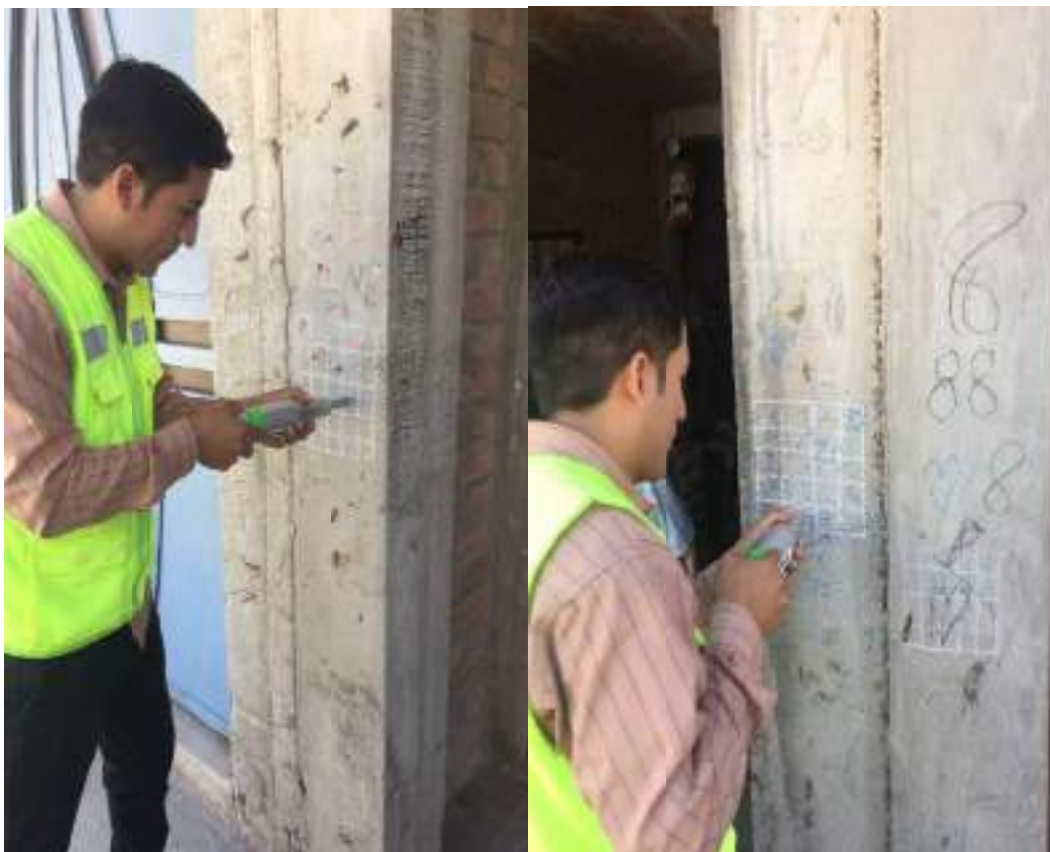
Haciendo las pruebas con esclerometría y encontrar los números de rebotes en columnas
