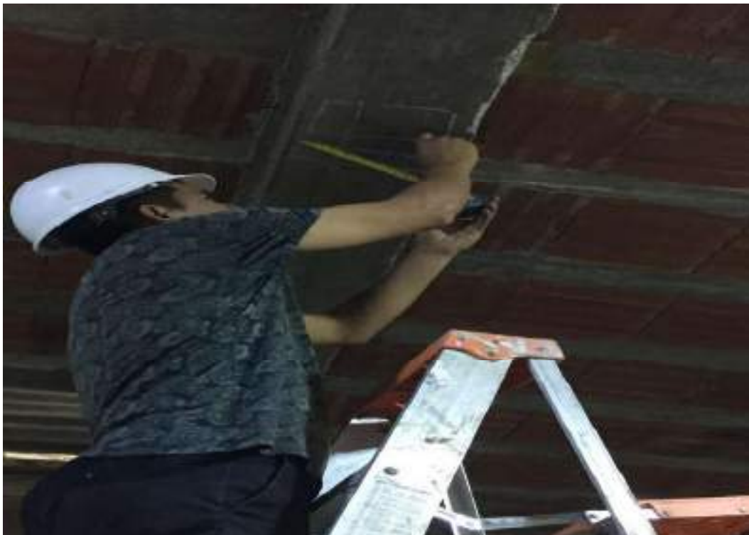
Medición con wincha para el ensayo donde se va hacer los numero de rebotes
