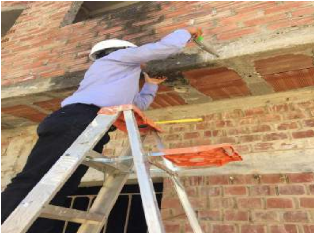
Evaluacion en vigas con esclerometria en viviendas seleccionadas
