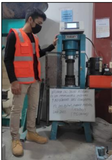
Ensayo de resistencia a la compresión
