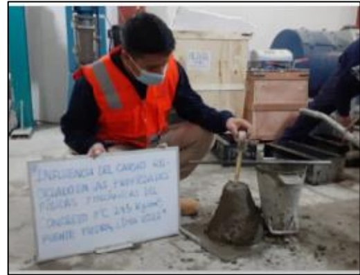
Ensayo de slump
