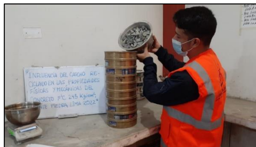
Figura 7. Granulometría del agregado grueso Fuente: Elaboración propia
