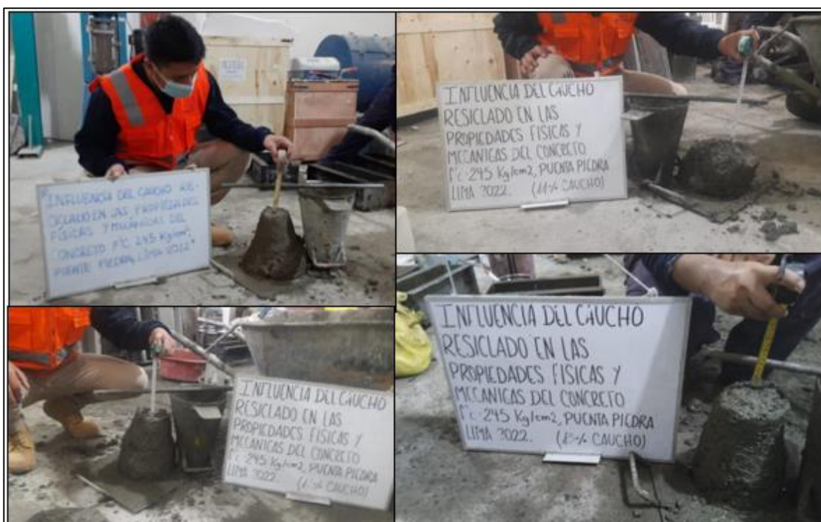
Figura 17. Ensayo de asentamiento
