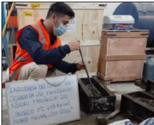
Elaboración de las vigas
