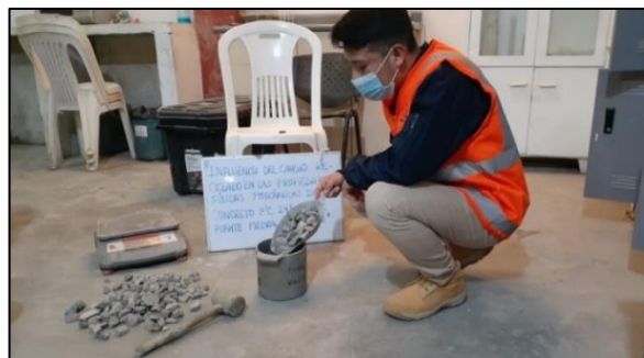
Figura 8. Peso Unitario Compactado del agregado grueso Fuente: Elaboración propia
