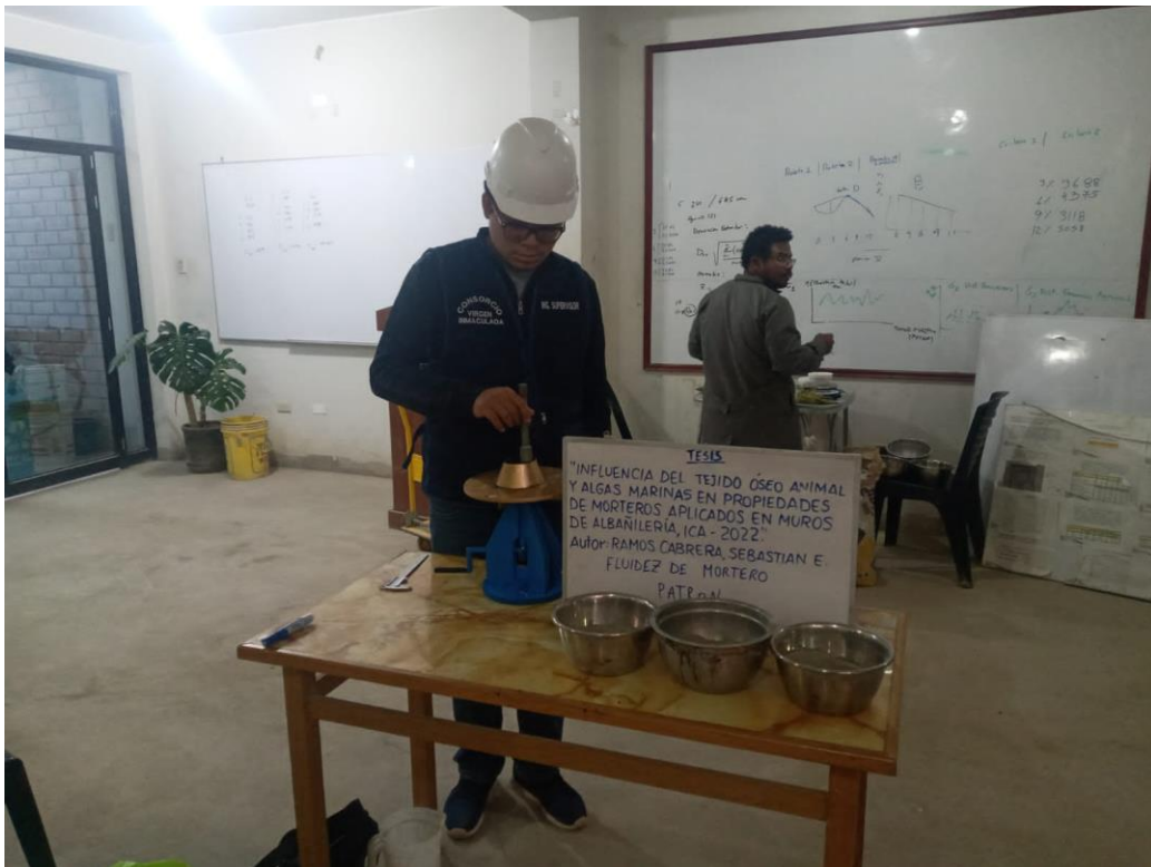
LLENADO EN LA SEGÚNDA CAPA DEL MOLDE DE LA MESA DE FLUJO PARA ENSAYAR AL MORTERO
