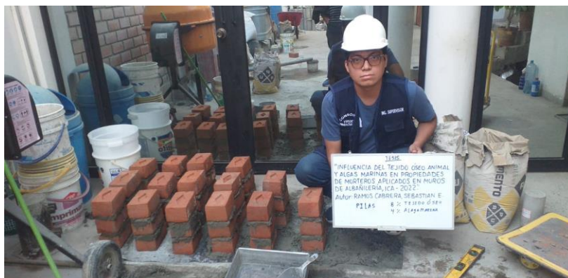
Figura 22. Prismas con mortero patrón y con adición de 3%, 6%, 9% y 12%
