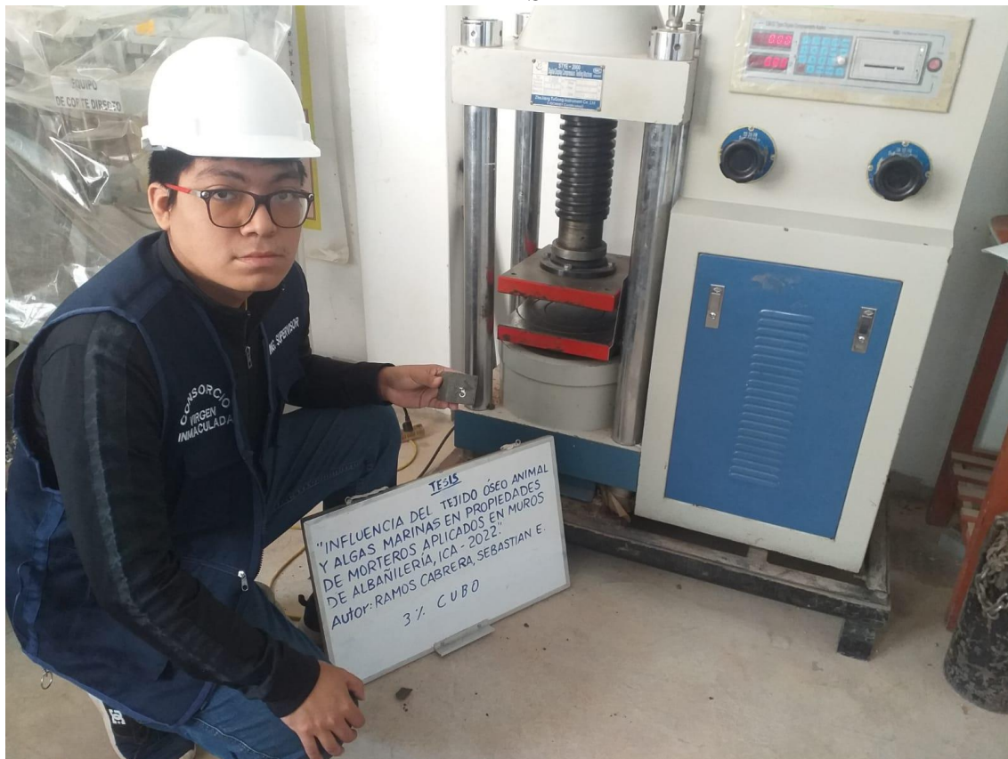
ENSAYO DE COMPRESIÓN AL 3% DE ADICIÓN AL MORTERO EN DIFERENTES DÍAS
