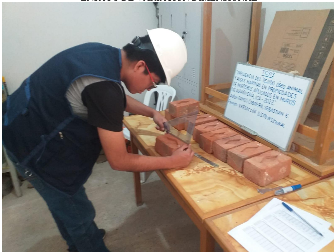
MEDICIÓN DE LA SUPERFICIE DE LA UNIDAD DE ALBAÑILERIA
