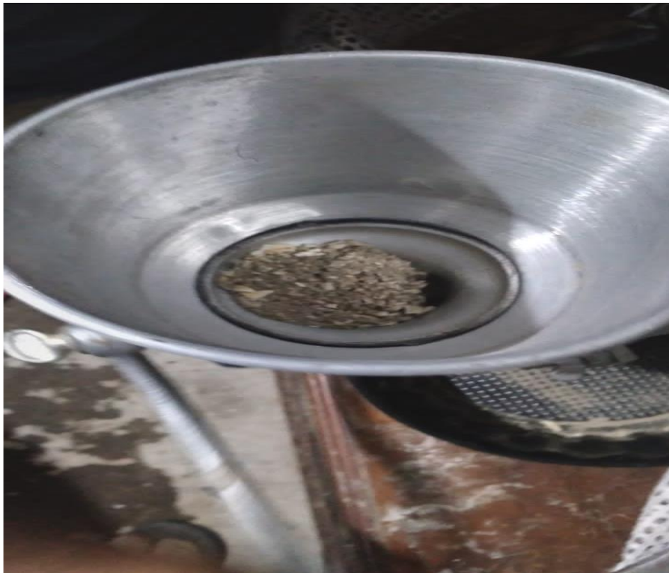
TRITURACIÓN DEL TEJIDO OSEO CON MOLIENDA PARA PONERLO EN GRANULOMETRIA FINA
