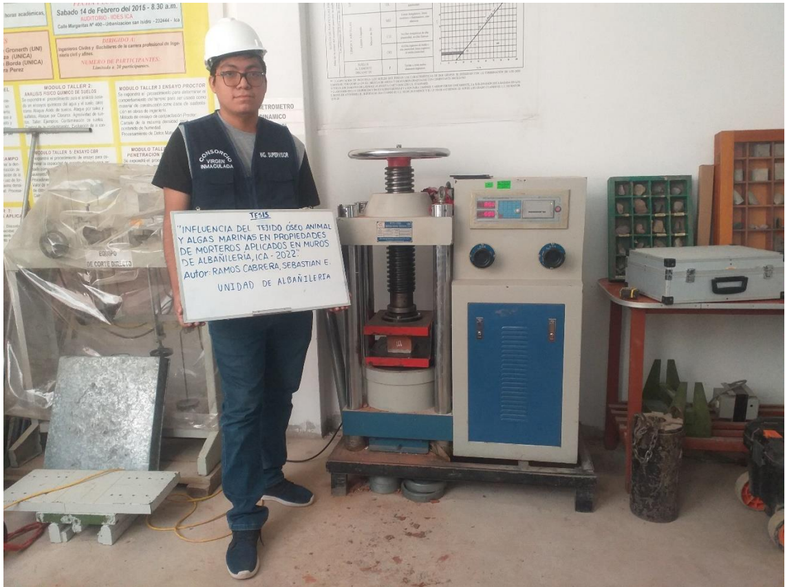
ENSAYO DE COMPRESIÓN A LA UNIDAD DE ALBAÑILERÍA PARA LAS MUESTRA 2 Y 3
