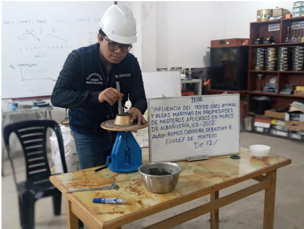
LLENADO DE MOLDE PARA ENSAYO DE MORTERO AL 12%
