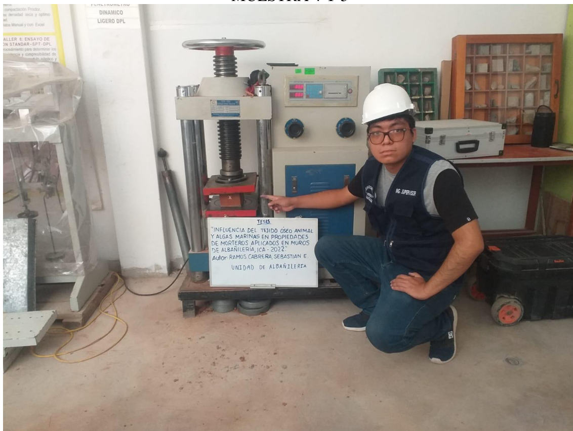
ENSAYO DE COMPRESIÓN A LA UNIDAD DE ALBAÑILERIA PARA LAS MUESTRA 4 Y 5
