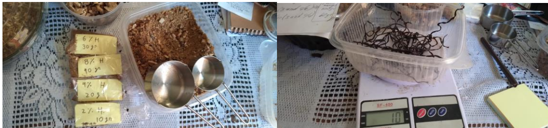
Figura 17. Pesado de tejido óseo y alga marina para las dosificaciones de mortero
