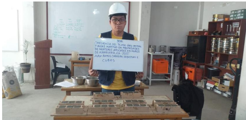
Figura 24. Elaboración de cubos de mortero patrón y adicionados de 3%, 6%, 9% y 12% de tejido óseo y alga marina
