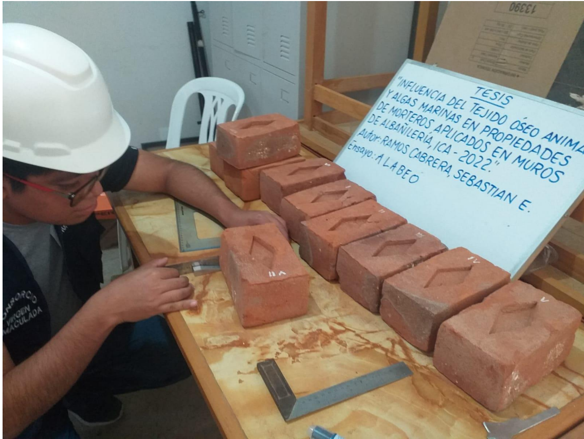
ENSAYO DE ALABEO PARA LA SEGUNDA MUESTRA
