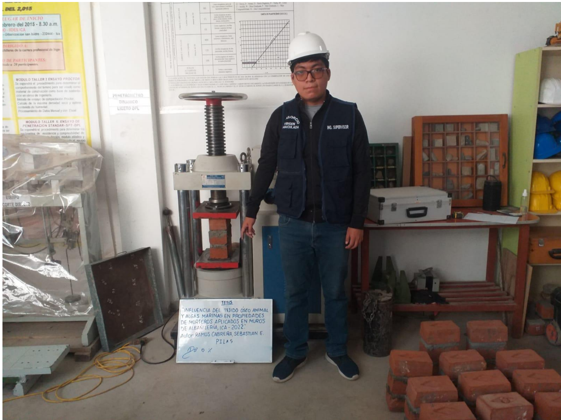
ULTIMO ENSAYO A LA UNIDAD DE ALBAÑILERIA Y ENSAYO A LA COMPRESIÓN DE LAS PILAS F'm
