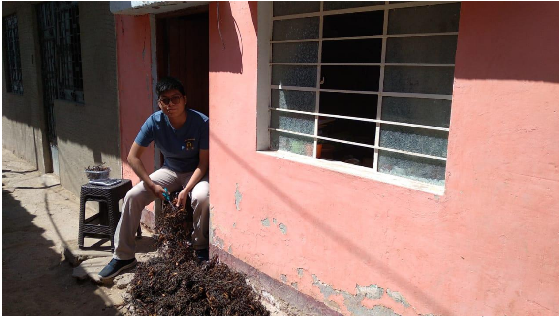
CORTE DE LA FIBRA DE ALGA DE 5cm PARA LA ELABORACIÓN DEL MORTERO
