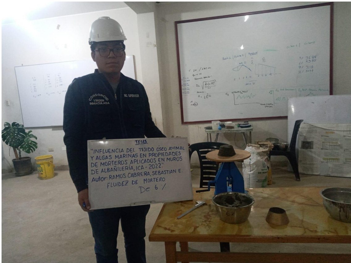
DEENCOFRADO DEL MORTERO DEPUÉS DE ESPERA 1 MINUTO PARA SER ENSAYADO
