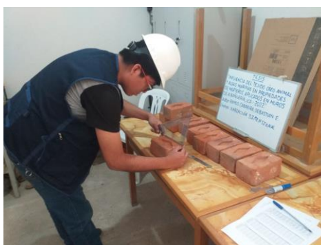
Figura 20. Verificación de medidas del mampuesto artesanal.
