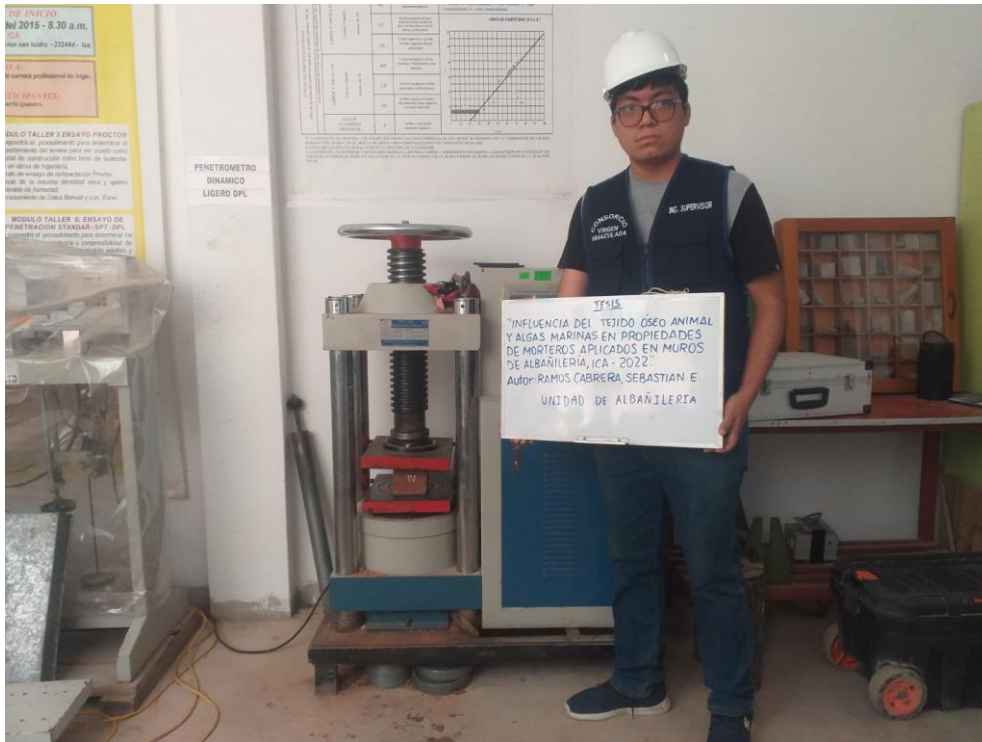
ENSAYO DE COMPRESIÓN A LA UNIDAD DE ALBAÑILERIA PARA LAS MUESTRA 4 Y 5
