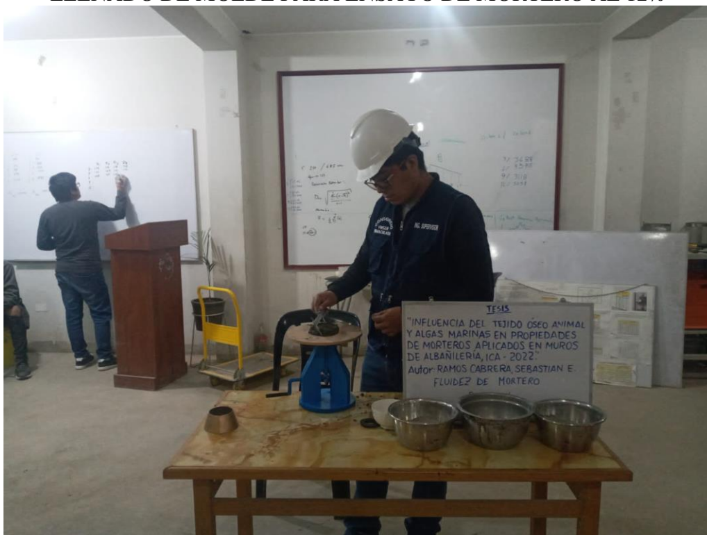
MEDICIÓN DEL MORTERO ANTES DE ENSAYAR EN LA MESA DE FLUIDEZ
