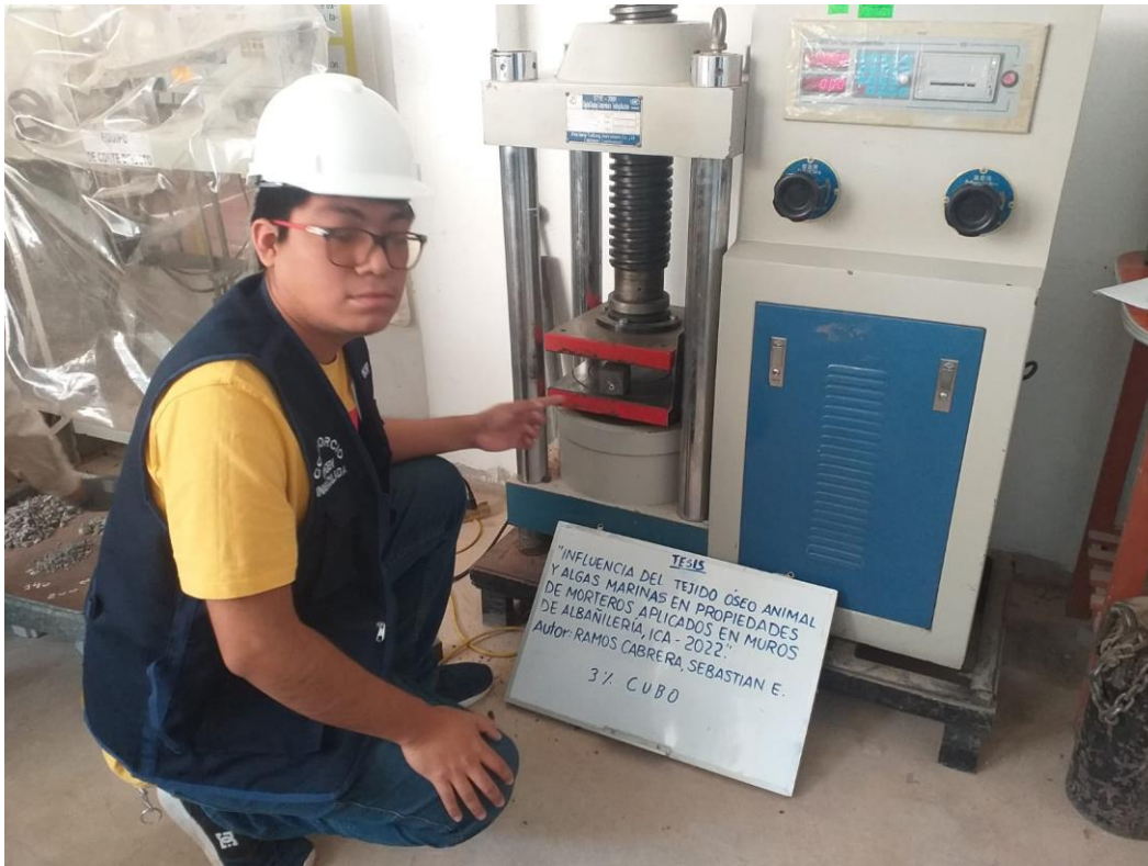
ENSAYO DE COMPRESIÓN AL 3% DE ADICIÓN AL MORTERO EN DIFERENTES DÍAS
