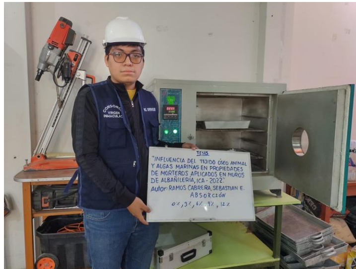
Figura 25. Ensayo de absorción para los cubos de mortero patrón y sus adiciones 3%, 6%, 9% y 12% de tejido óseo y alga marina
