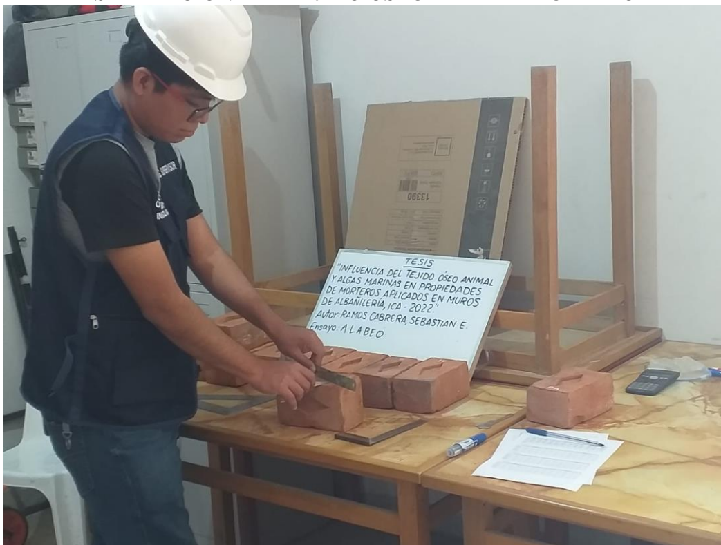
ENSAYO DE ALABEO PARA MANPUESTO ARTESANAL
