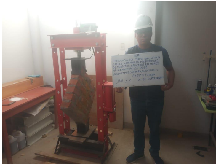
Figura 23. Ensayo de Compresión Diagonal con mortero 2% de tejido óseo y 1% de alga marina.
