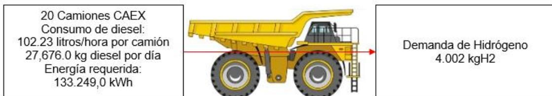
En la figura 7, se muestra la conversión de la cantidad de energía de los equipos diesel, 133.249,0 kWh para los 20 camiones y la cantidad de kilogramos de H<sub>2</sub>V. necesarios para atender la demanda de los veinte camiones mineros.
