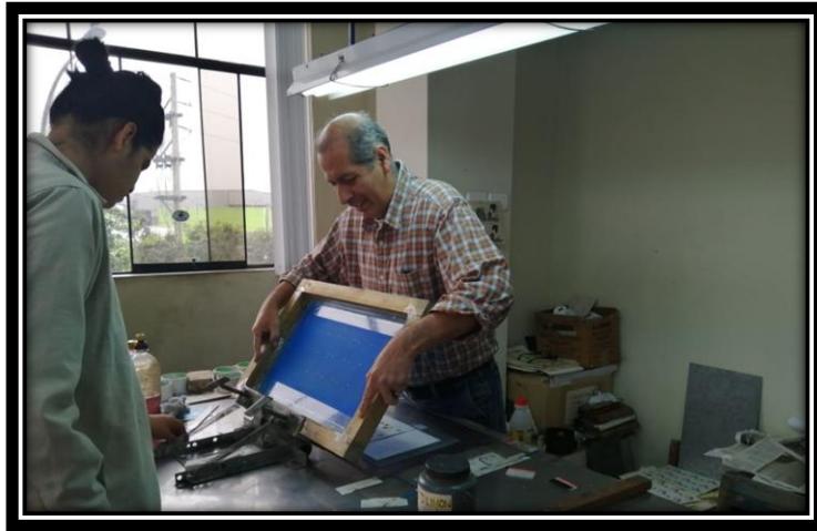
Figura 22: Impresor coloca el cliché en el portamarco
