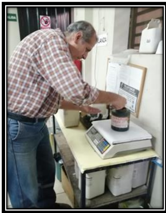
Figura 26: Operario mezcla pigmento en polvo y aceite.
