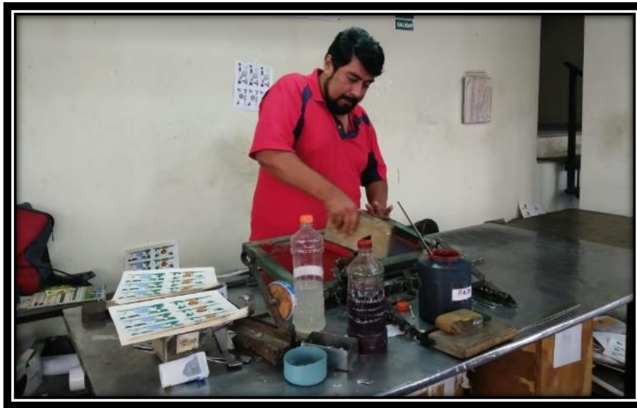
Figura 27: Operario imprime calcomanía con raqueta.
