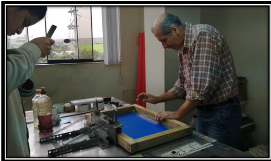
Figura 25: Impresor verifican y acomoda el registro del calzado de líneas guías
