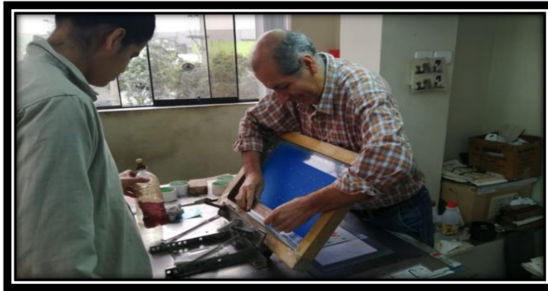
Figura 23: Impresor pega la cinta en el cliché
