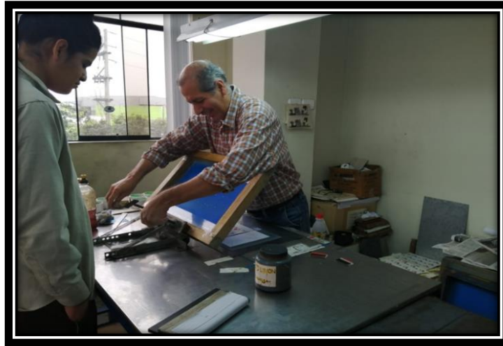
Figura 20: Impresor ajusta el portamarco y escuadra
