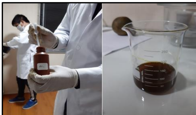
Figura 20. Incorporación de Amoníaco en la disolución del \text{FeCl}_3
