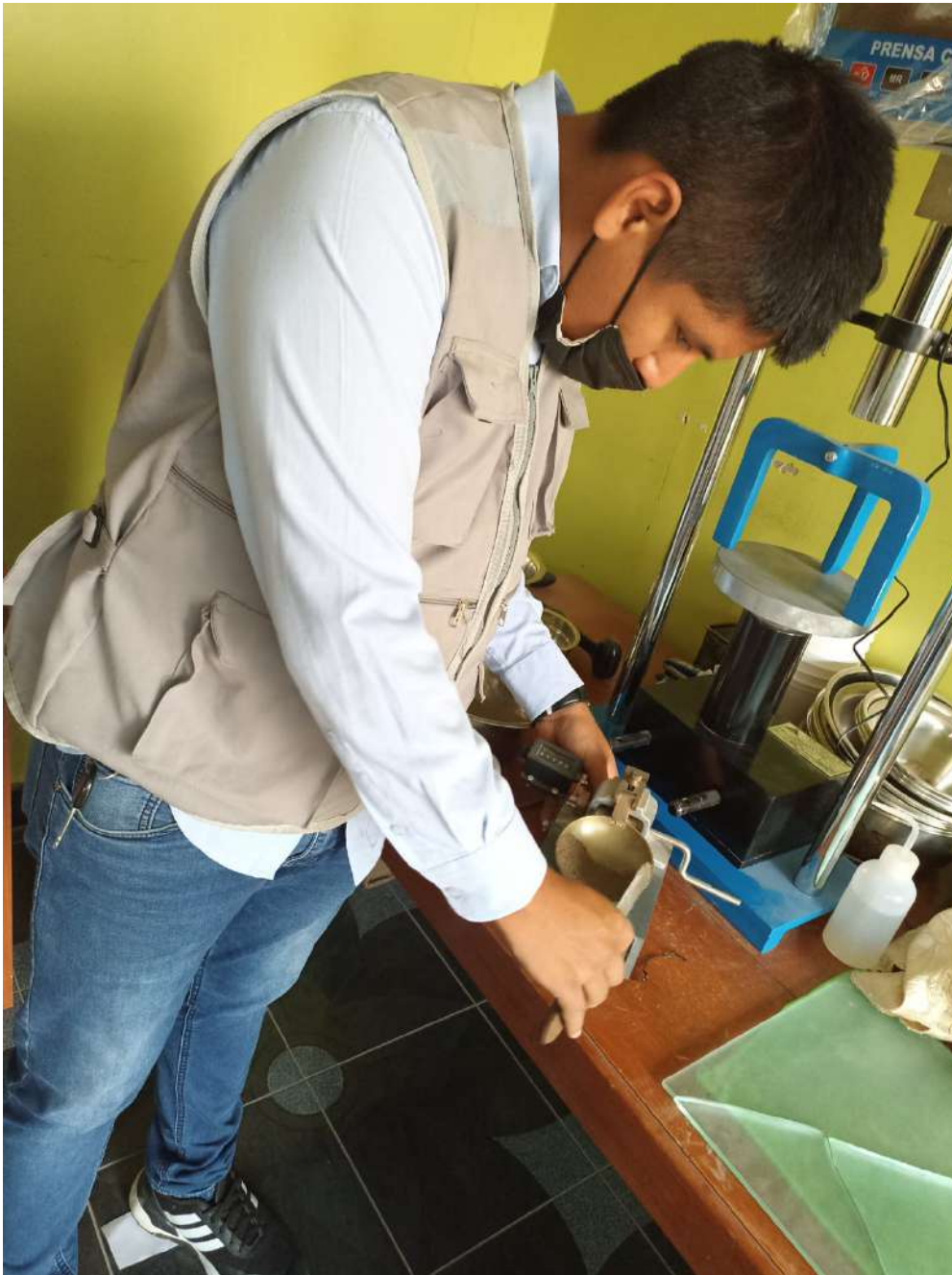
Figura 64. Ensayos de laboratorio utilizando Casagrande para hallar limite líquido.
