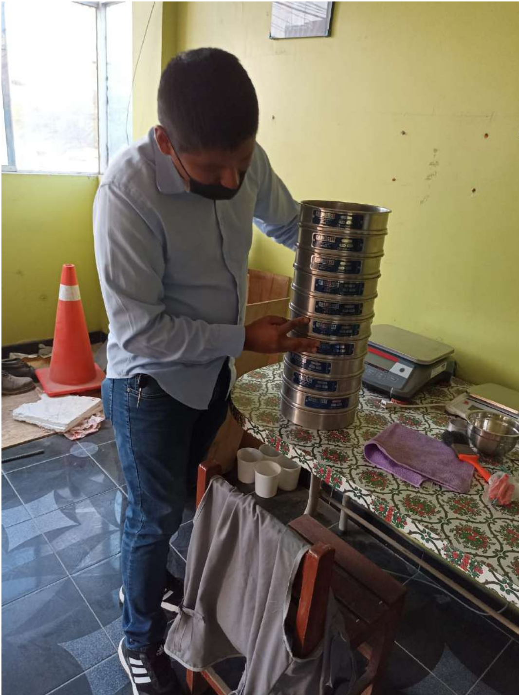
Figura 63. Ensayos de laboratorio utilizando el tamiz para la clasificación de suelos.
