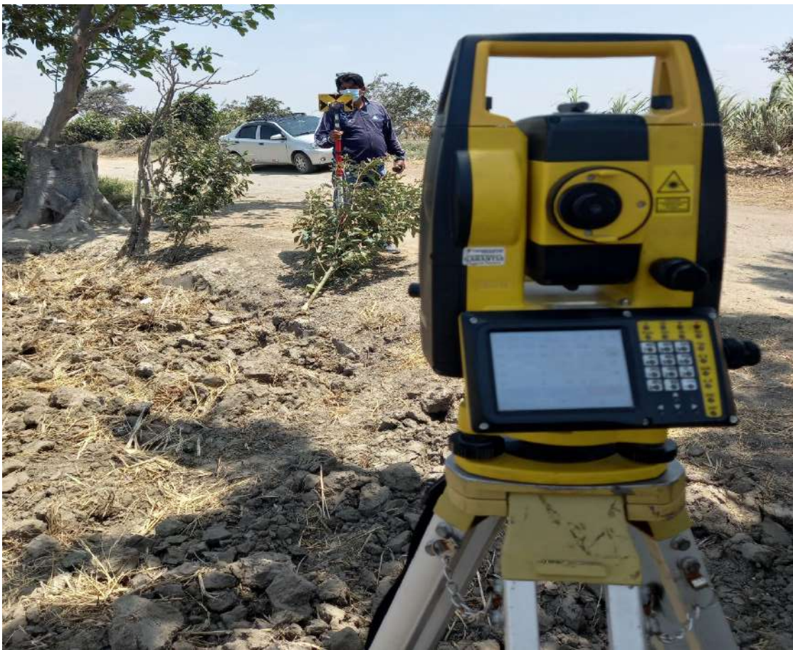
Figura 45. Teodolito Electrónico (Marca south n4)
