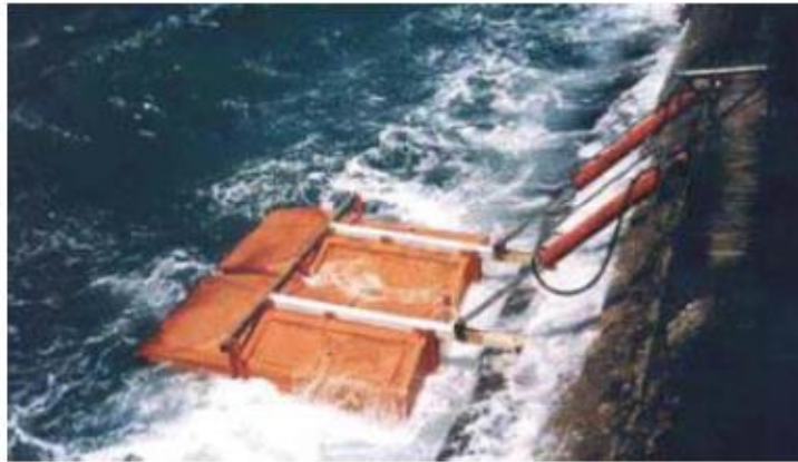
Figura 8. Dispositivo Undimotriz SDE.
