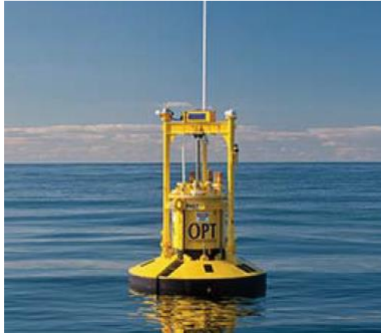
Figura 17. Absorbedor puntual, Potencia nominal 150 kW.
