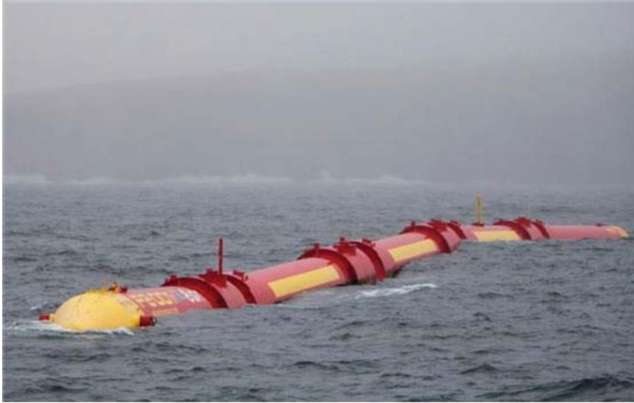
Figura 14. Sistema Atenuador - Potencia nominal Rango 0.75 MW
