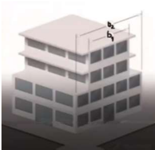
FIGURA 13. Irregularidad Geométrica Vertical
