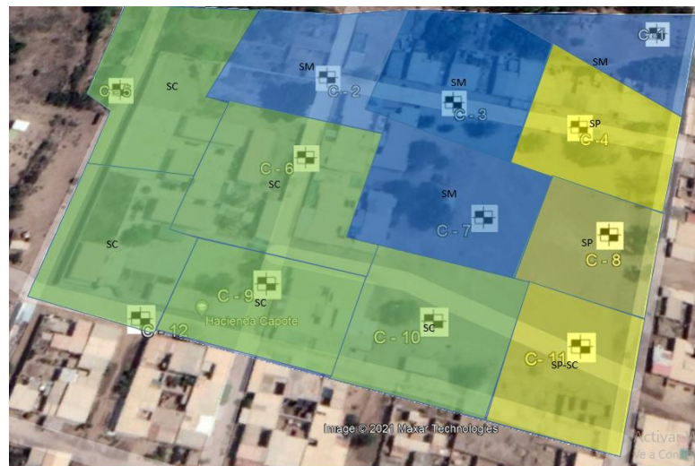
Figura 16. Visualización de la clasificación SUCS del suelo a 2.50 m de profundidad en el sector Barrio Nuevo- Capote
