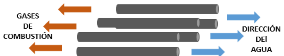
Figura 14. Flujo a contracorriente entre gases y agua.
