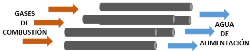
Figura 13. Flujo en paralelo de gases y agua.
