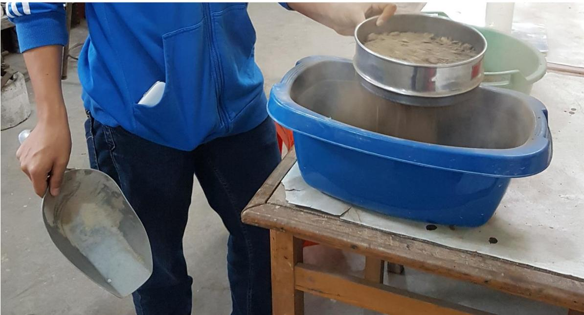
**Fotos 24:** se procedió a realizar el CBR de lo cual se trajo una muestra de afirmado de 30 kg lo cual tamizamos con la malla #3/4
