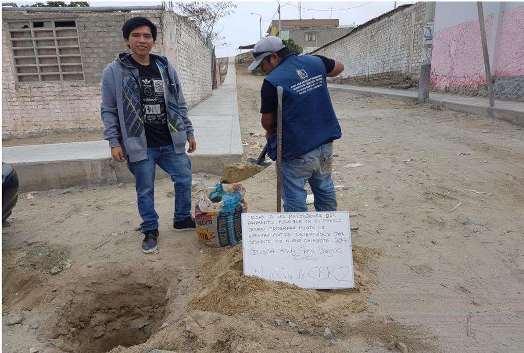
Foto 14: Se procedió a extraer muestra para el segundo CBR
