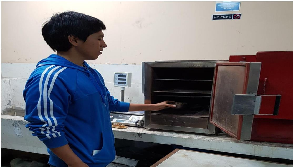
**Foto 16:** Luego que se pesa el contenido de humedad se pasa al horno para secar la muestra 24 horas, lo cual tendrá una temperatura de  $110 \pm 10$  °C.
