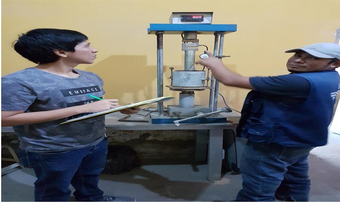
**Fotos 29:** Luego de satura la muestra por 96 horas se lo pasa a la prensa para la penetración vs carga de lo cual se tomara dato para luego pasarla en la computadora.
