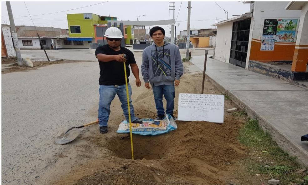
**Foto 4:** Se procedió a medir la profundidad de la calicata con el técnico de laboratorio
