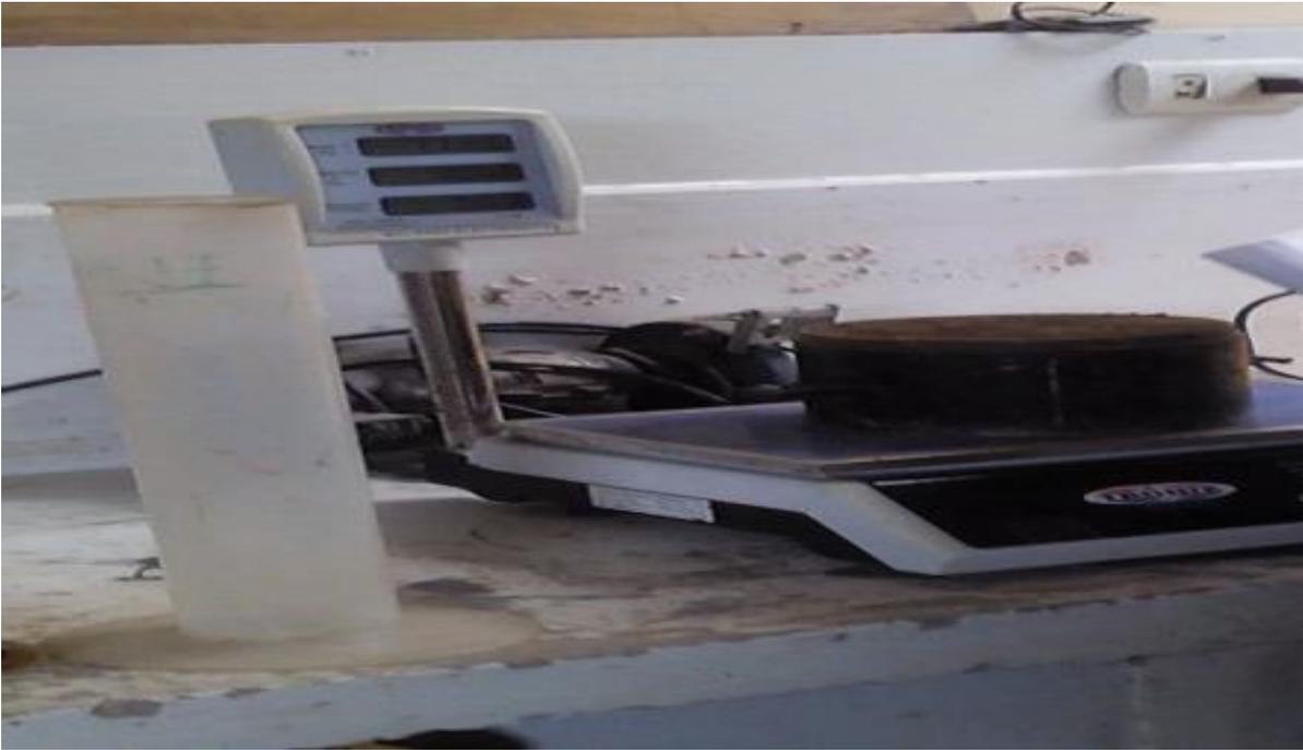
**Foto 23:** Luego se procede a pesar el molde con la muestra y se toma dato en el cuaderno para luego procederlo en la computadora todos los datos extraídos
