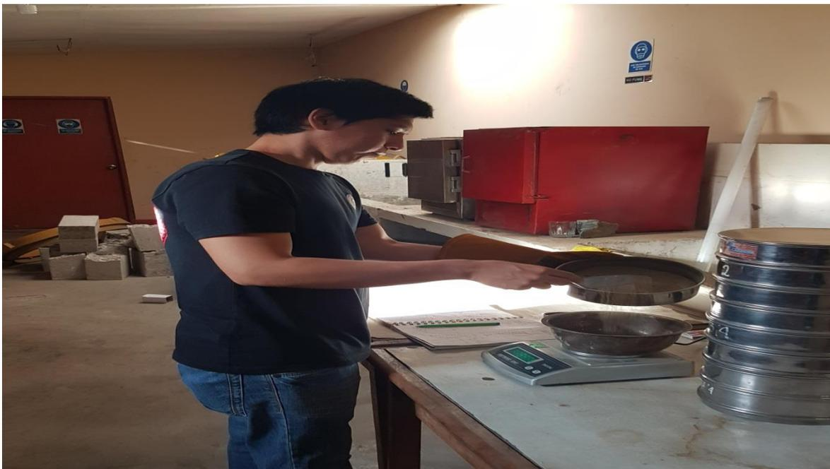
**Foto 18:** Se procede a pesar las muestras de cada malla y anotar en un cuaderno.
