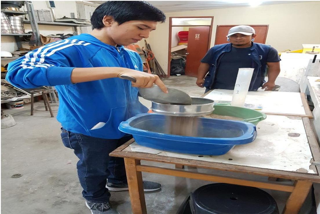
**Foto 19:** Luego se extrajo 30 kg de muestra del terreno de estudio, para tamizarlo
