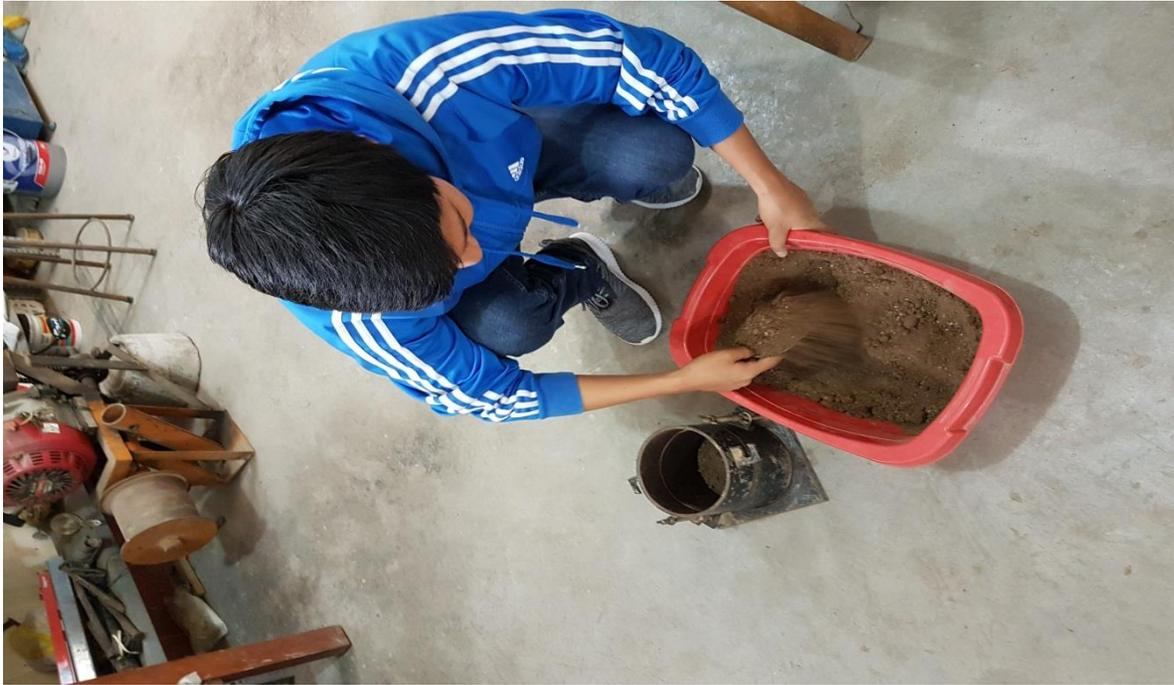
**Fotos 25:** Luego se separó por cada molde una muestra de 6 kg y realizamos un porcentaje de agua.
