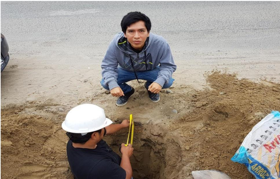
**Foto 2:** Se procedió a medir las capas que forman el pavimento flexible
