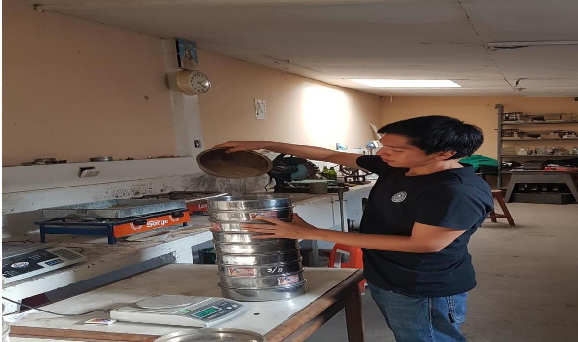
**Foto 17:** Se pasa hacer el análisis granulométricos de cada muestra extraídas de las calicatas en este caso como fue terreno natural se utilizó las mallas #4, #10, #16, #30, #40, #50, #100, #200, <200
