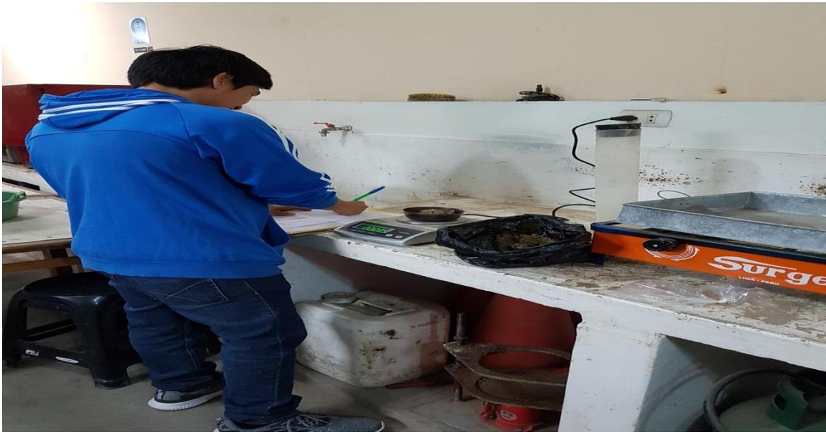
**Foto 15:** Se realiza el ensayo de contenido de humedad de lo cual se extraes una muestra en una tara y luego se pesa en una balanza para tomar dato
