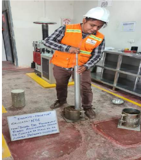
realizando el compactado 2 capa C-02
