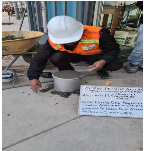
enrasando la adición 12% de ceniza
