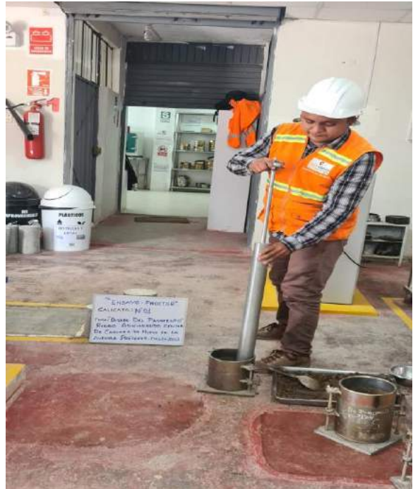
realizando el compactado 1 capa C-01
