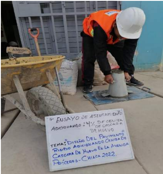
sacando en cono de abrams 4% de ceniza
