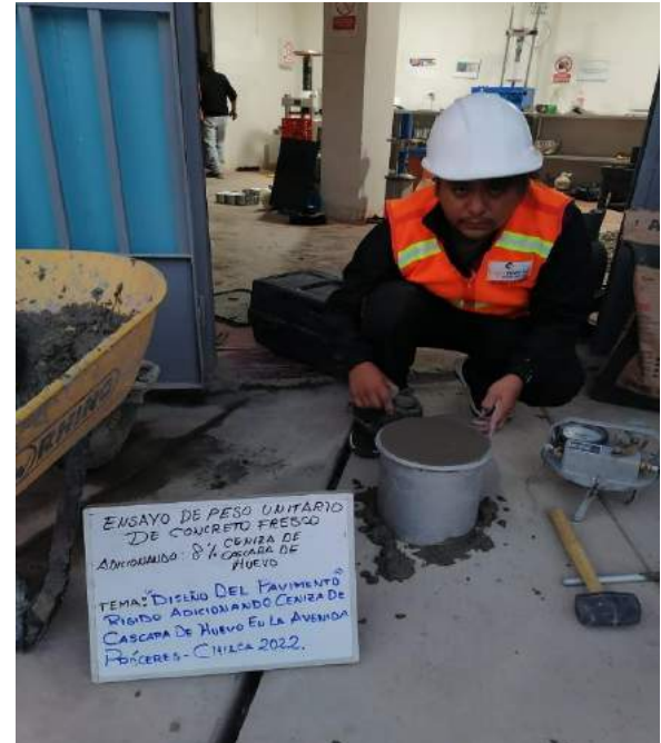
Pesando el molde con 8% de ceniza
