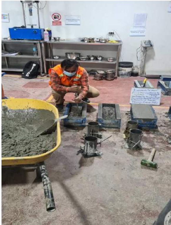
chuseando con adición de 4% de ceniza
