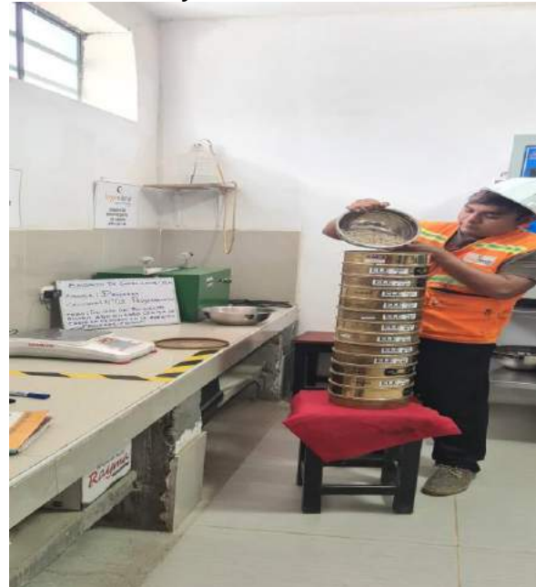
tamizando la muestra C-02
