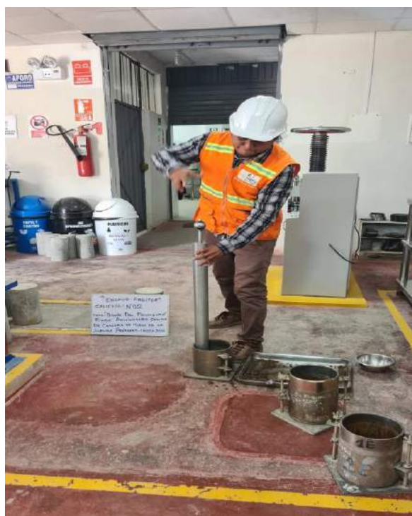
realizando el compactado 1 capa C-02
