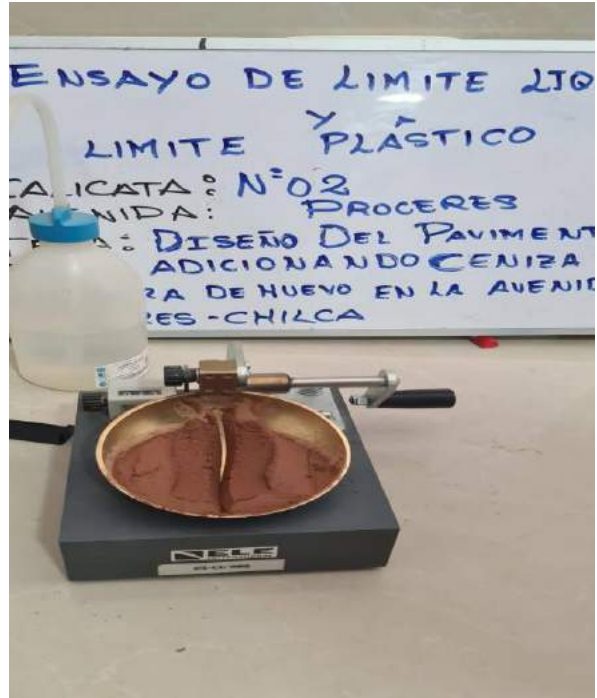
Después de realizar los 25 golpes
