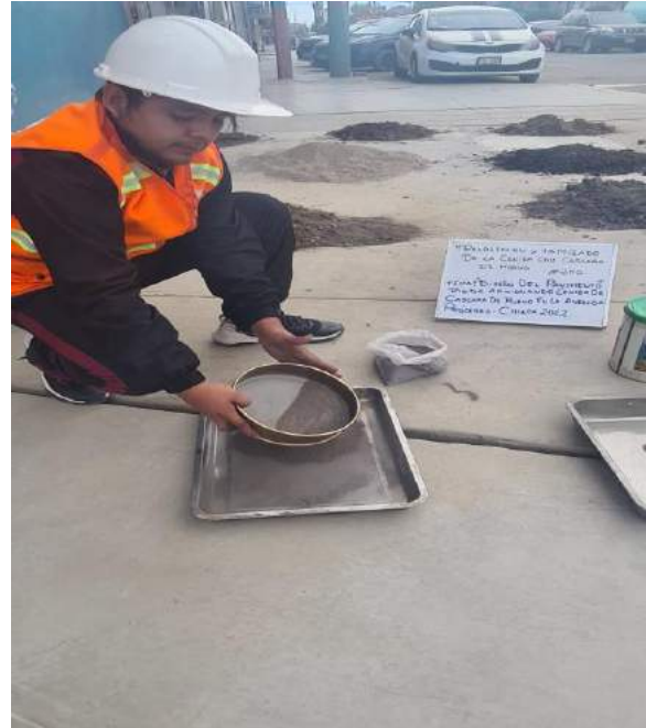
Producto final del tamizado de la ceniza.
