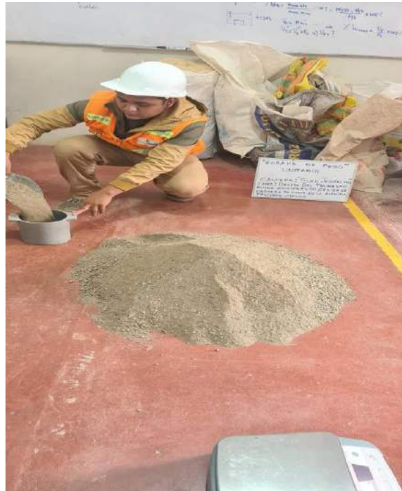
introduciendo la arena gruesa
