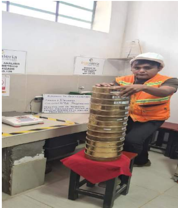
tamizando la muestra C-01
