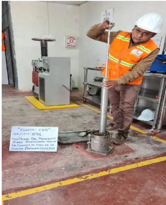
realizando el compactado de la 3 capa C-01
