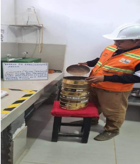
introduciendo la arena gruesa
