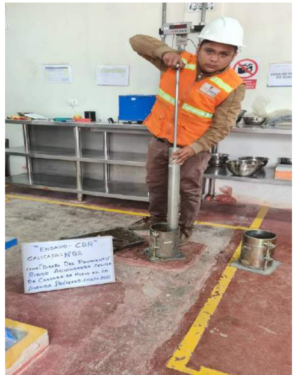
realizando el compactado 1 capa C-02
