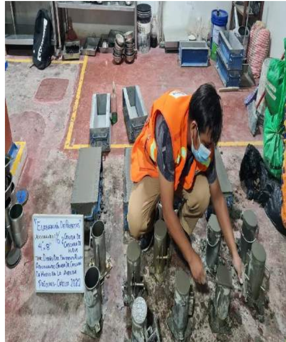
testigos con adición de 16% de ceniza
