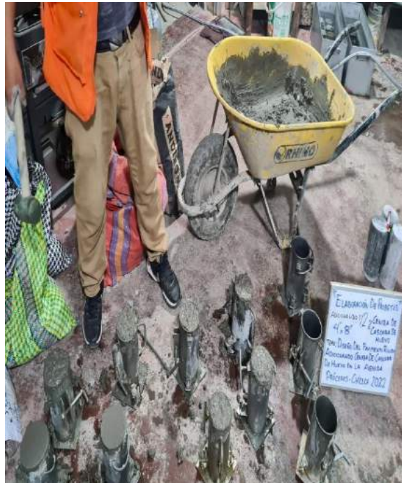
testigos con adición de 12% de ceniza
