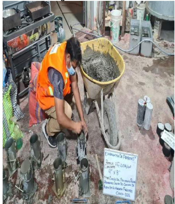
chuseando 2 capa - patrón f'c=210\text{kg/cm}^2
