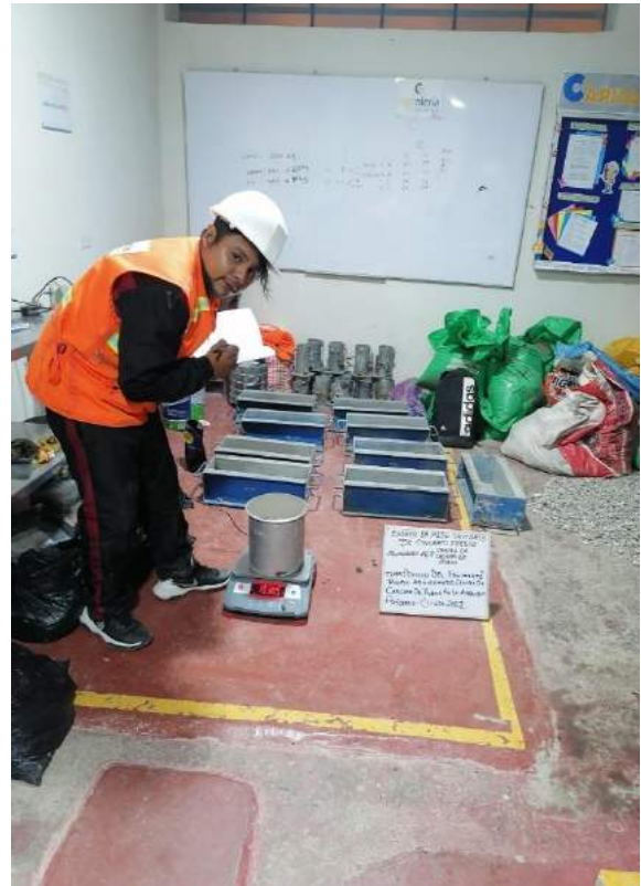
pesando 16% adición de ceniza
