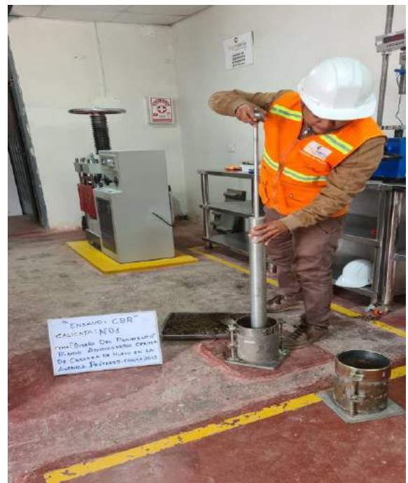
realizando el compactado 1 capa C-01
