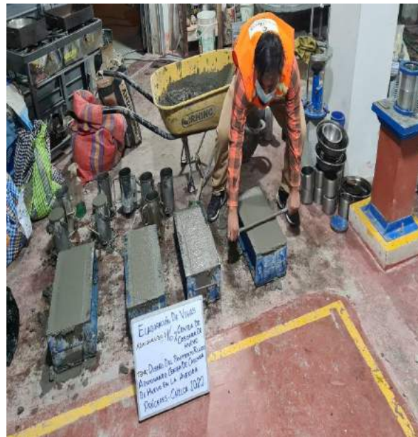
enrasando las vigas con 16% de ceniza
