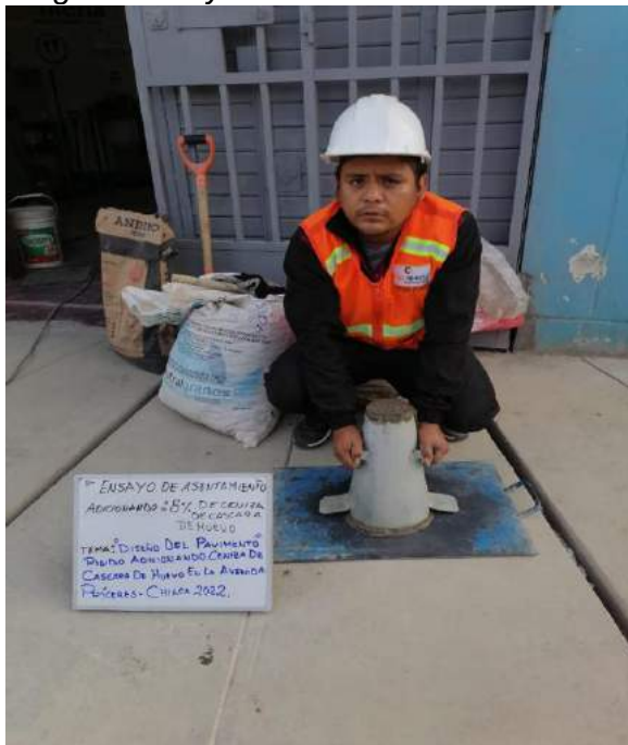
sacando en cono de abrams 8% de ceniza
