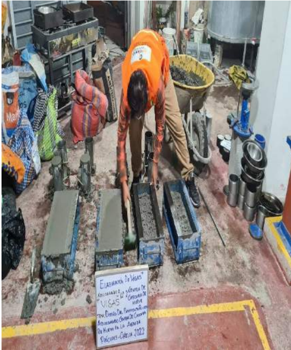
chuseando con adición de 12% de ceniza
