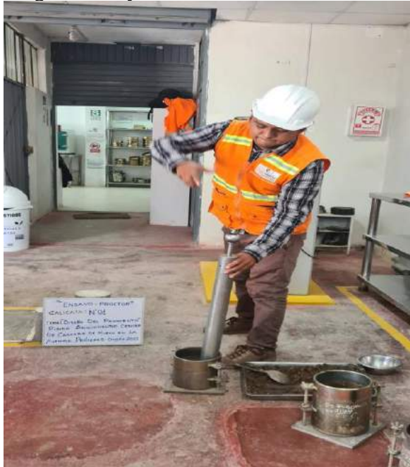
realizando el compactado 2 capa C-02
