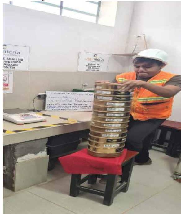
tamizando la muestra C-02
