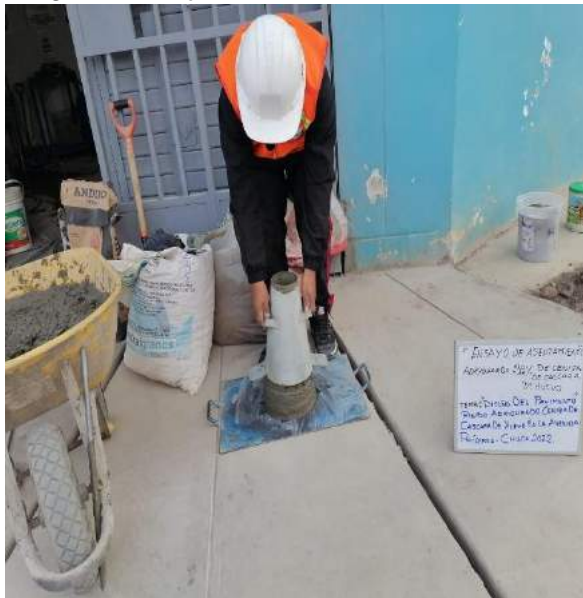
sacando en cono de abrams 12% de ceniza
