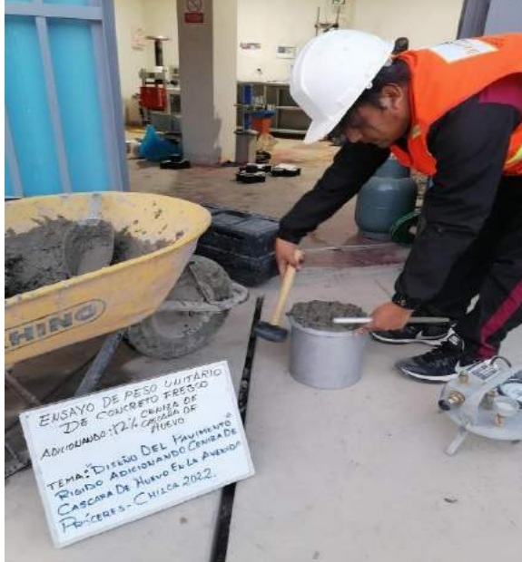
Adicionando ceniza 12%-compactando
