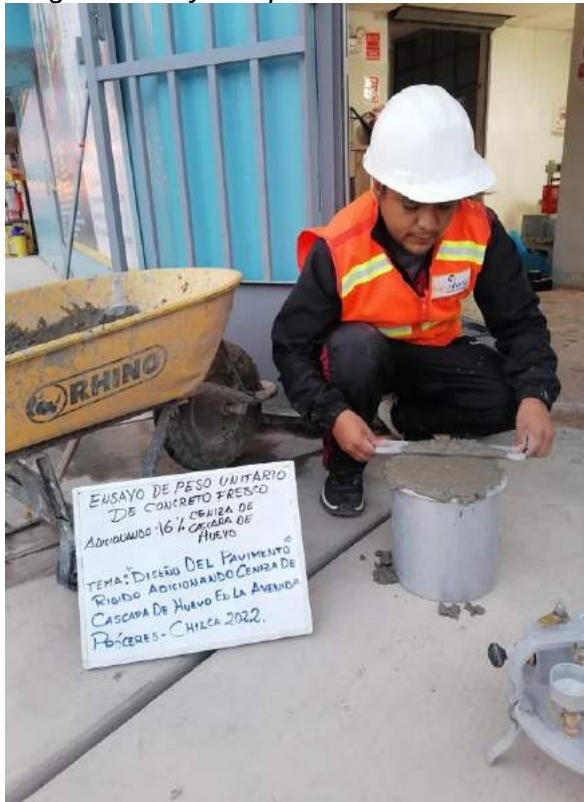
perfilando la adición 16% de ceniza
