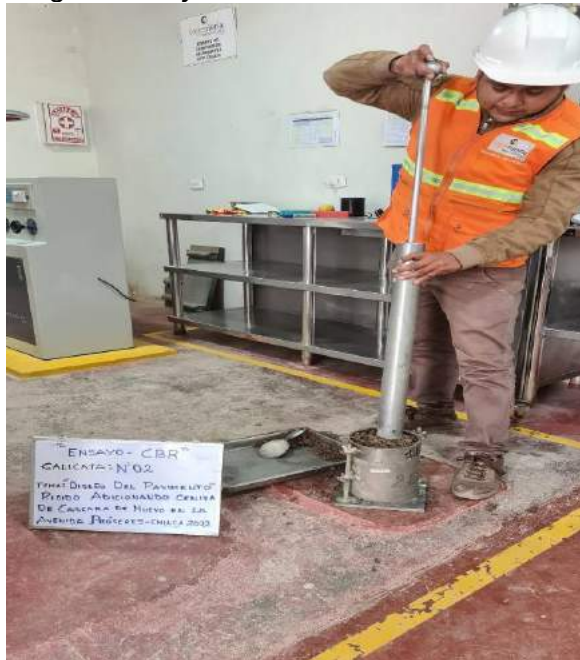
compactado de la 2 capa de la C-02
