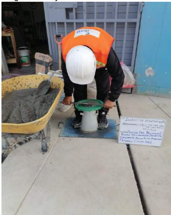
enrasando el cono con 16% de ceniza
