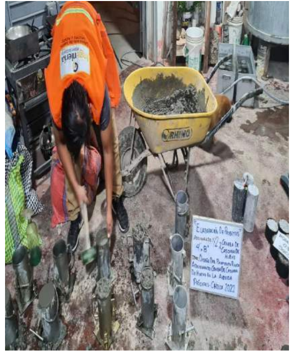
compactando 2 capa con adición de 8%
