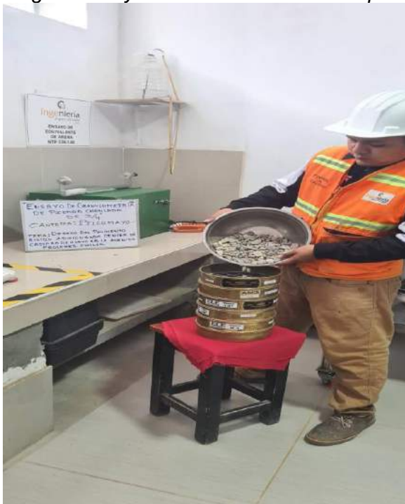
vaciado de la piedra chancada
