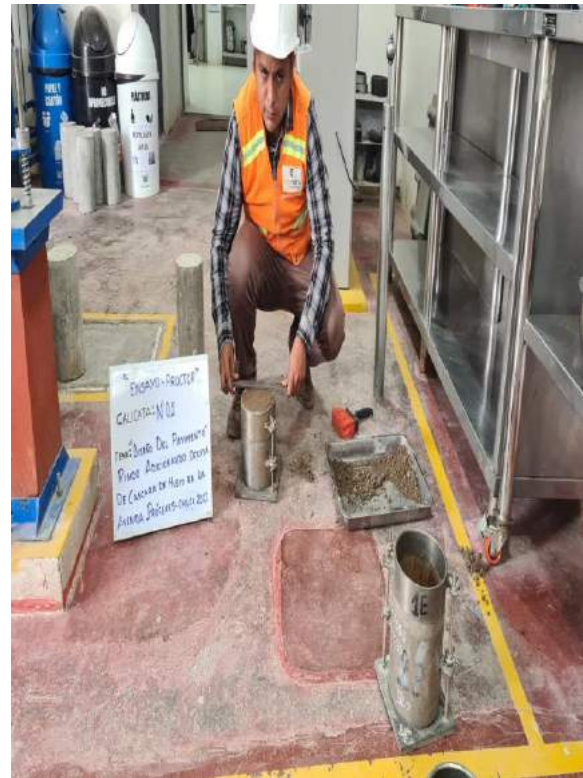
realizando el compactado 1 capa C-02
