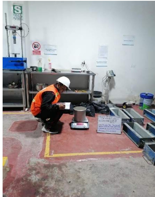
Pesando el molde con 4% de ceniza
