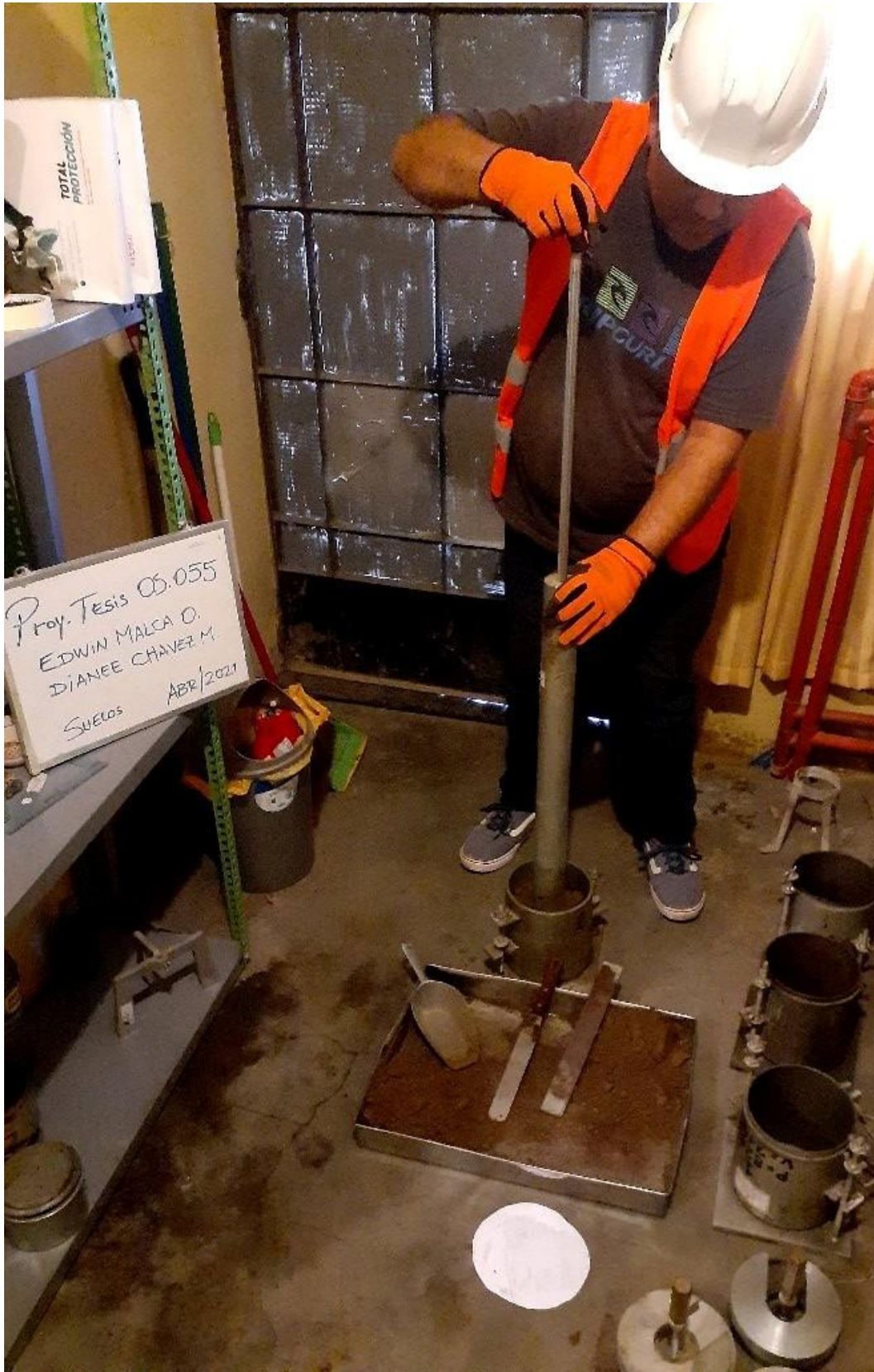
Ensayo Proctor modificado
