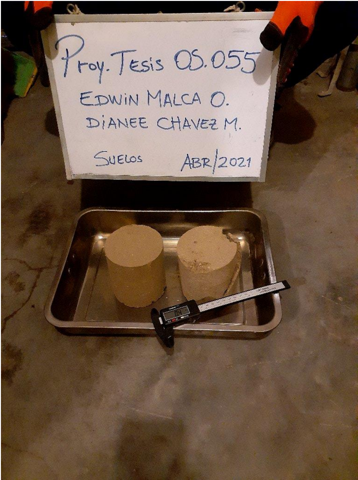
Testigos de compresión de suelos
