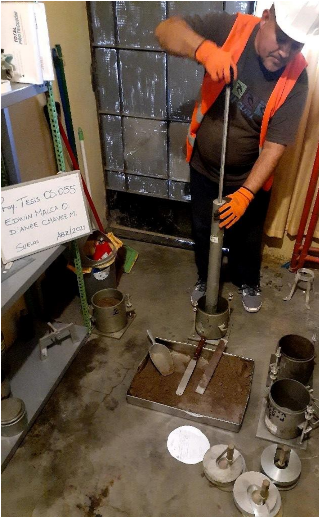
Ensayo Proctor modificado
