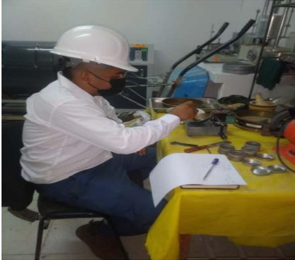
Figura 12. Ensayo límite líquido.
