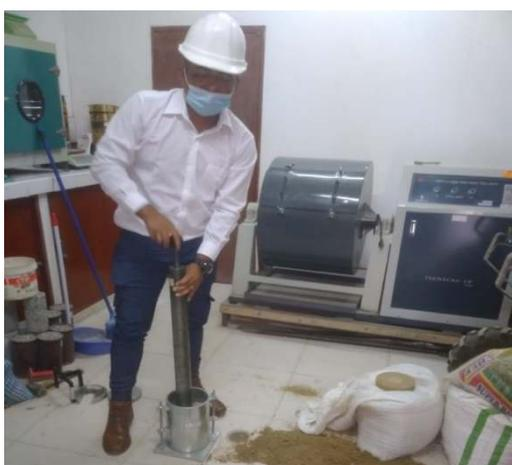
Figura 24. Ensayo C.B.R sin cal.
