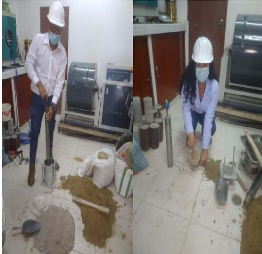
*Figura 10. Ensayo Proctor Modificado*
