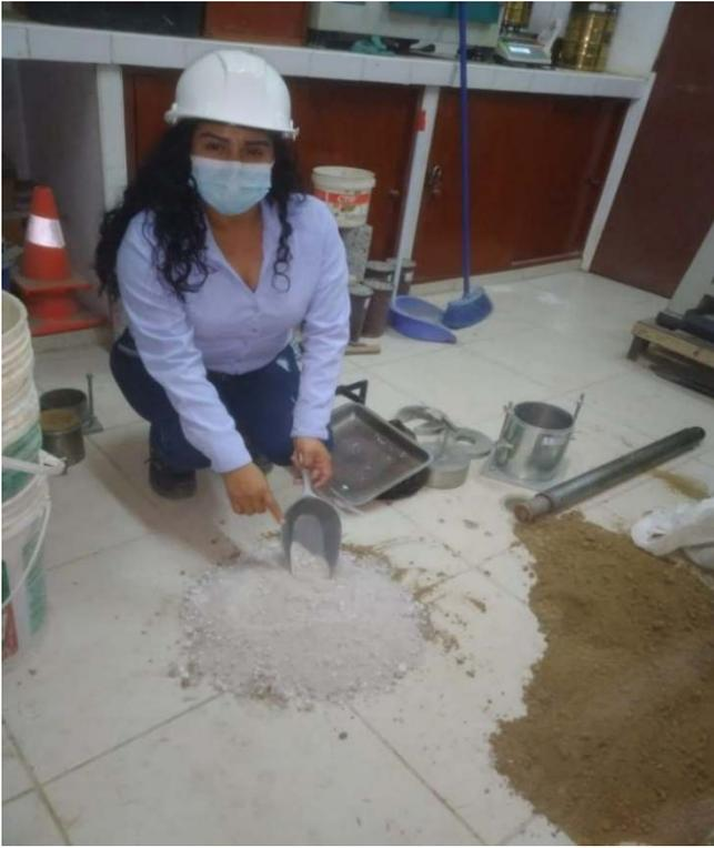
*Figura 46.* Añadiendo cal al ensayo de C.B.R.
