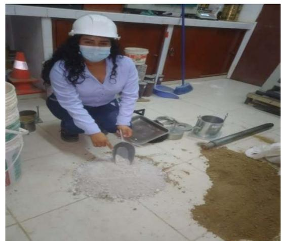
Figura 19. Ensayo de Proctor Modificado con cal.
