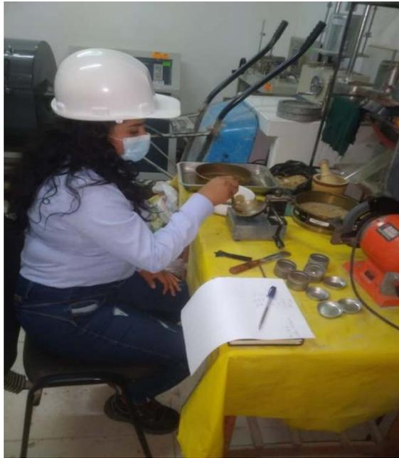
*Figura 41.* Deslizamiento de un suelo en el límite líquido.
