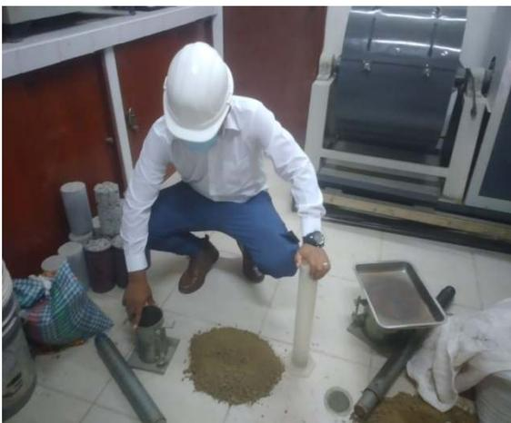
Figura 18. Ensayo de Proctor Modificado sin cal.
