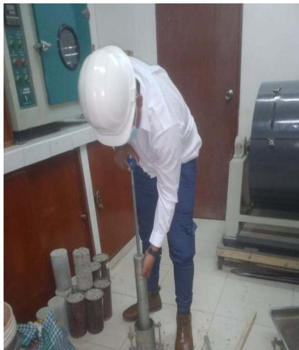
*Figura 45.* compactando en el molde del Proctor.
