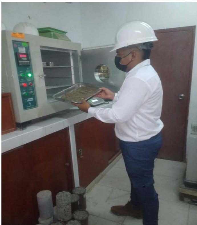
*Figura 38. Secado de la arcilla en el horno.*
