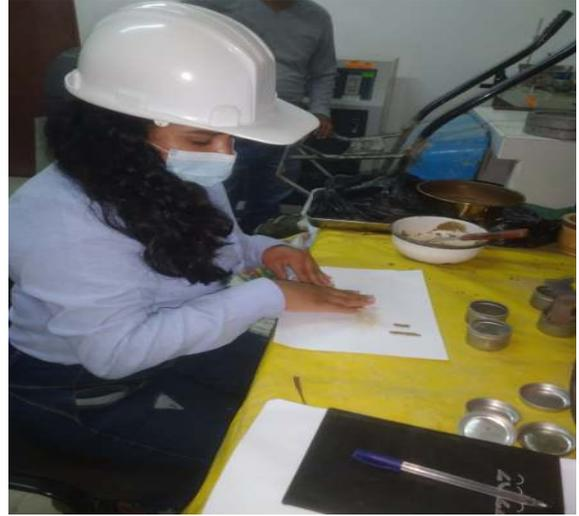
Figura 13. Ensayo Límite Plástico.
