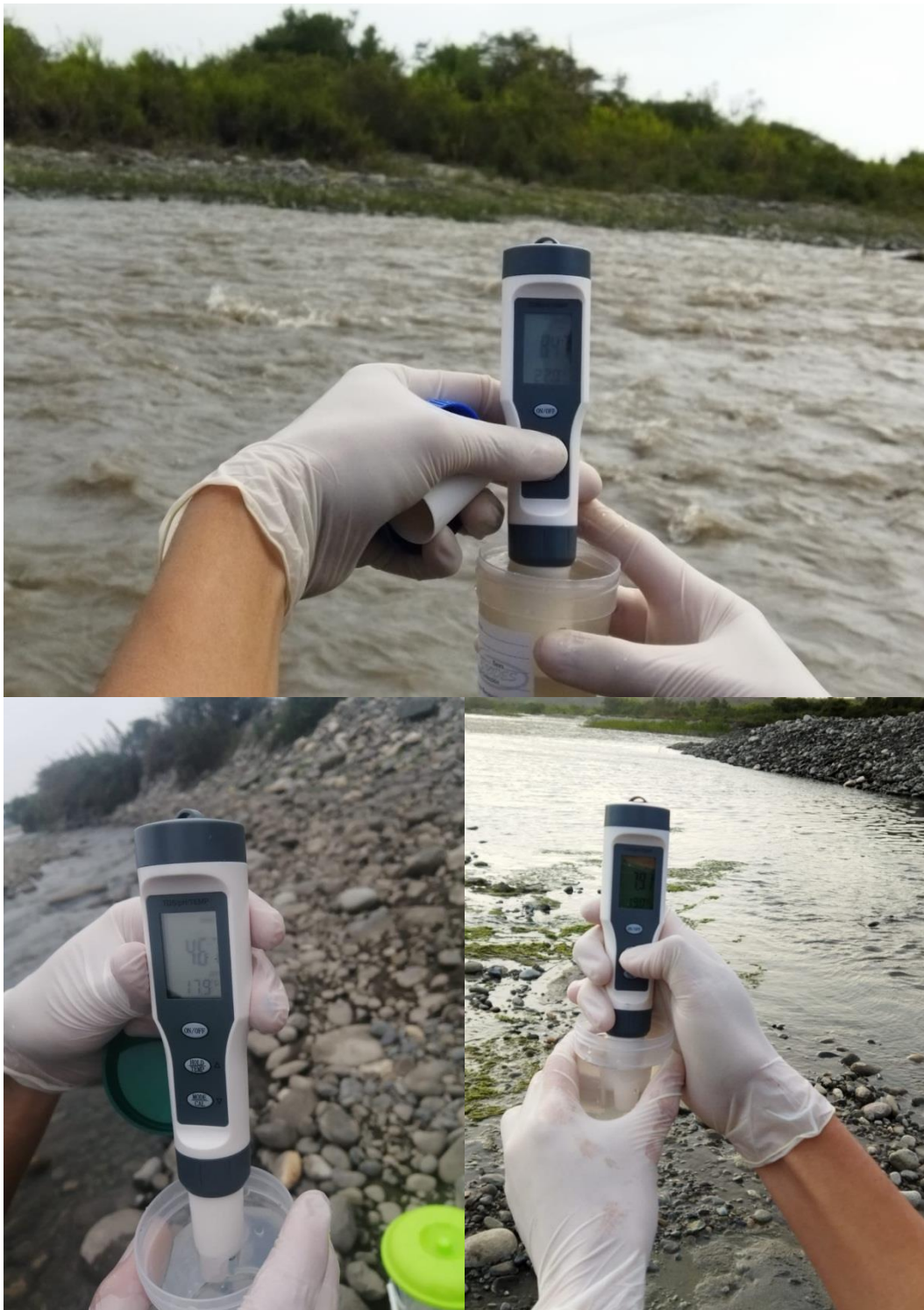
Figura 24: Análisis in situ del parámetro de la temperatura en los distintos puntos de monitoreo
