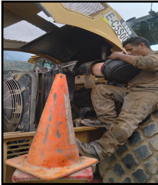
Figura 87. Colocación de filtros.
