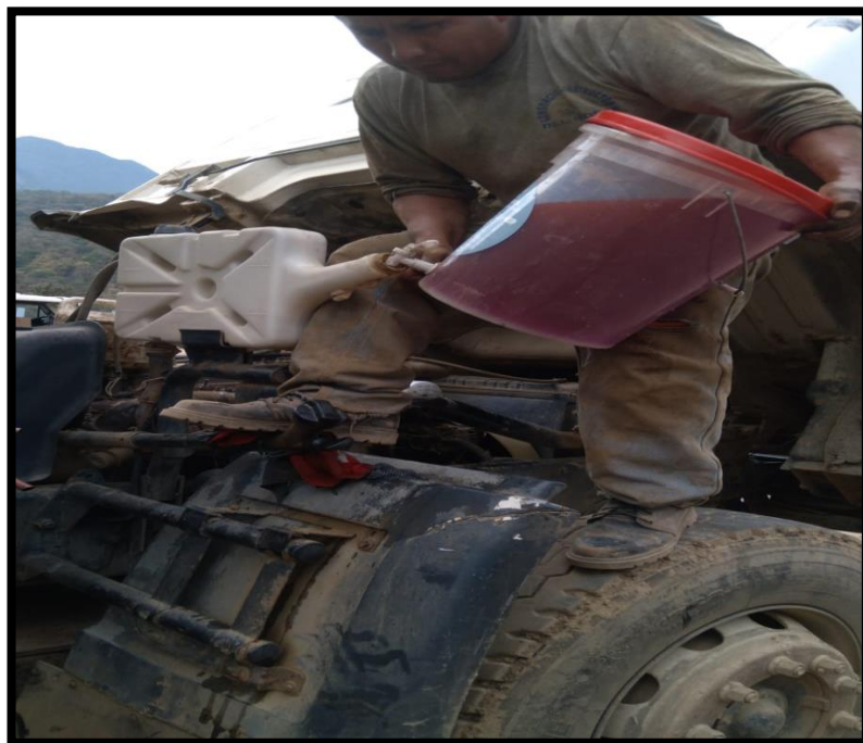
Figura 88. Extracción y cambio de lubricantes..
