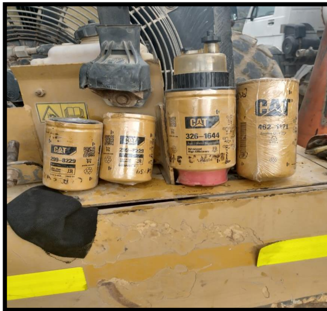
Figura 86. Cambio de filtros nuevos.
