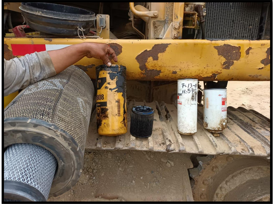
Figura 85. Cambio de filtros usados.
