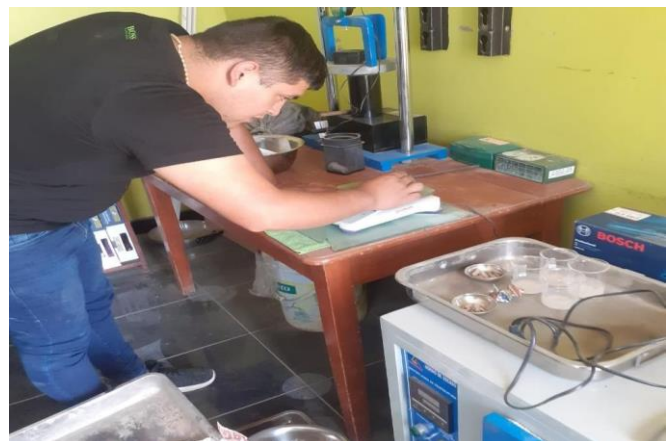
Colocación del material en el horno para resultado del límite líquido, 2022.
