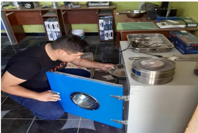
Colocación del material en el horno para resultado del límite líquido, 2022.
