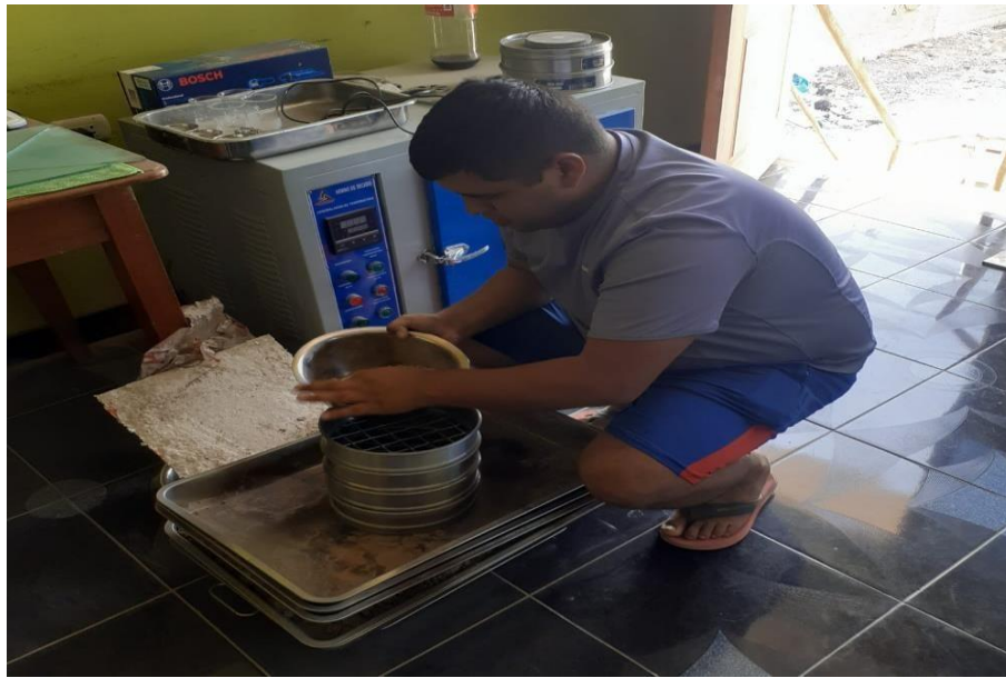
Tamizado del material para el ensayo de granulometría, 2022.
