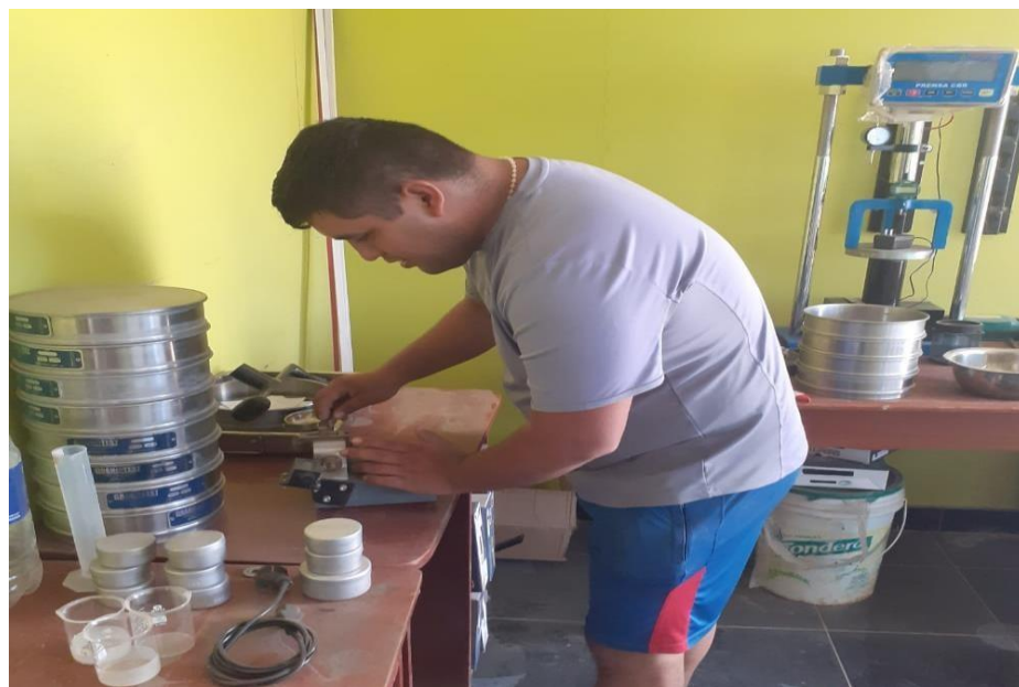
Tamizado del material para el ensayo de granulometría, 2022.
