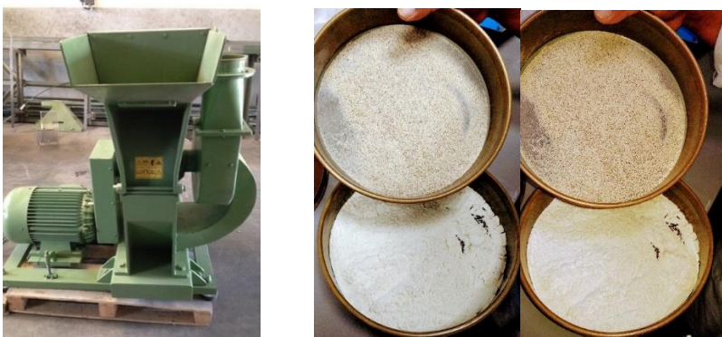
Fig. 3.4 Molino Eléctrico y tamizado con malla N° 80 (180 \mu m)
