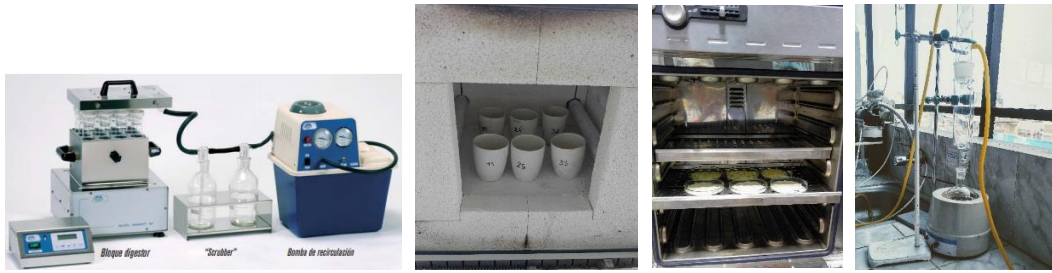
Fig. 3.4 equipos usados para determinar proteínas, cenizas, humedad, grasa, respectivamente.
