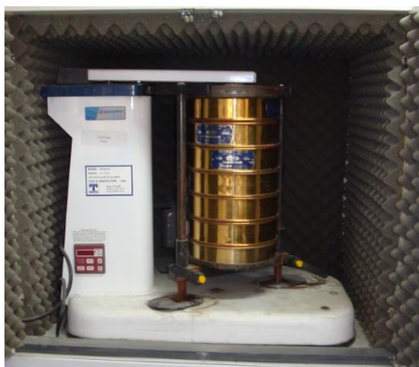
Fig. 3.7 tamizador para granulometría Ro-tap Tyler
