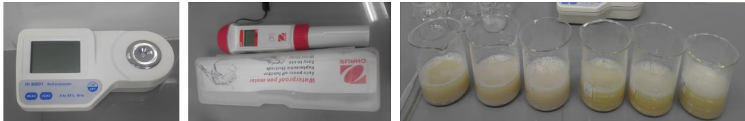
Fig. 3.5 equipo refractómetro, pH-metro, muestras de harina de habas diluida.
