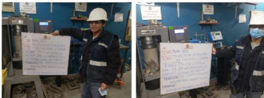
Fotografía 3 Y Fotografía 4 Compresión uniaxial de unidades de concreto. Derecha: 4% de ceniza y 5% de cal., izquierda: 4% de ceniza y 6% de cal.
