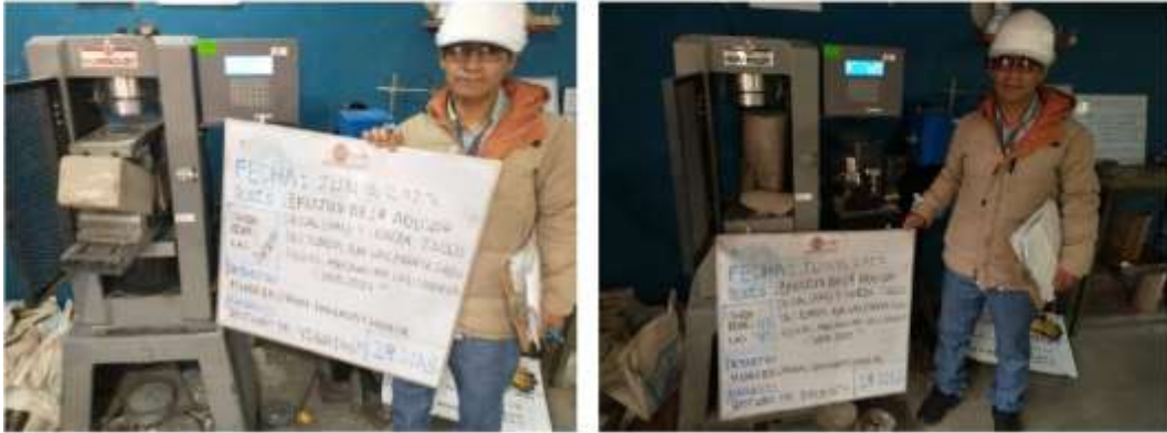
Fotografía 9 Y Fotografía 10 Compresión uniaxial de unidades de concreto. Derecha: Patrón, izquierda: 4% de ceniza y 4% de cal.
