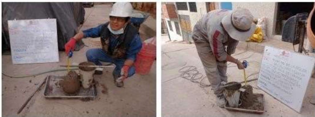
Fotografía 7 y Fotografía 8 Determinación del SLUMP. (concreto patrón + 6% de ceniza + 4% de cal).
