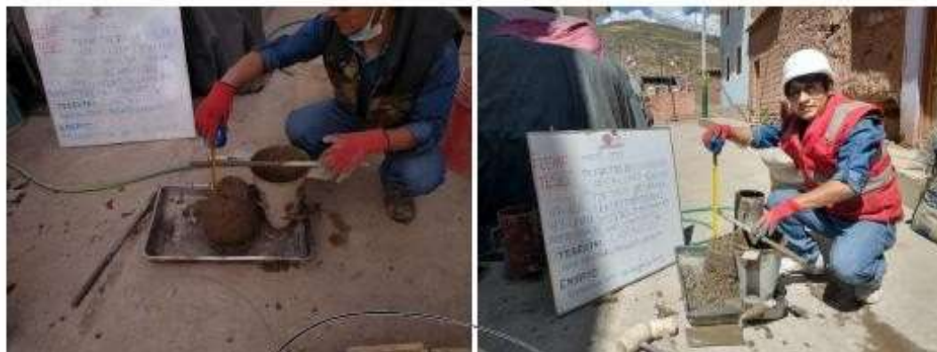
Fotografía 3 y Fotografía 4 Determinación del SLUMP. (concreto patrón + 4% de ceniza+4% de cal).
