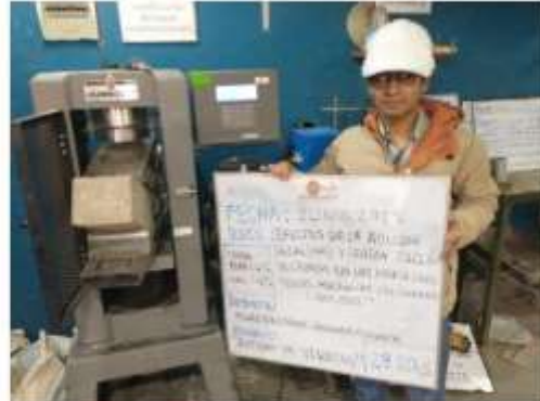
fotografía 9 y fotografía 10 Rotura de vigas. Derecha: Patrón, Izquierda: 4% de cal + 4% de ceniza.
