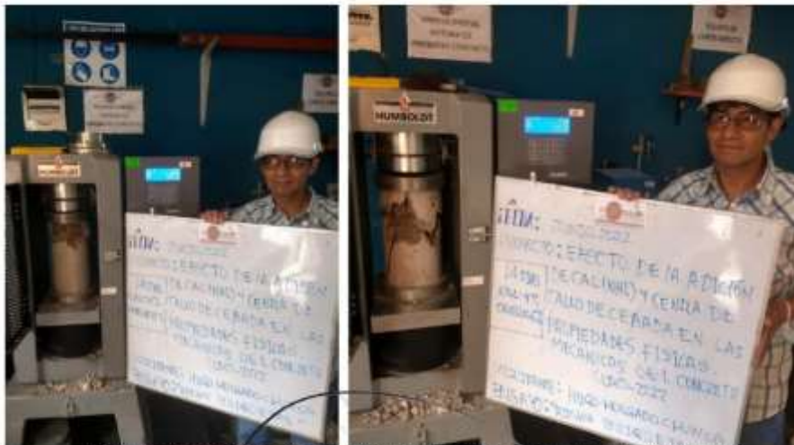
Fotografía 7 Y Fotografía 8 Compresión uniaxial de unidades de concreto. Derecha: 4% de ceniza y 5% de cal., izquierda: 4% de ceniza y 6% de cal.
