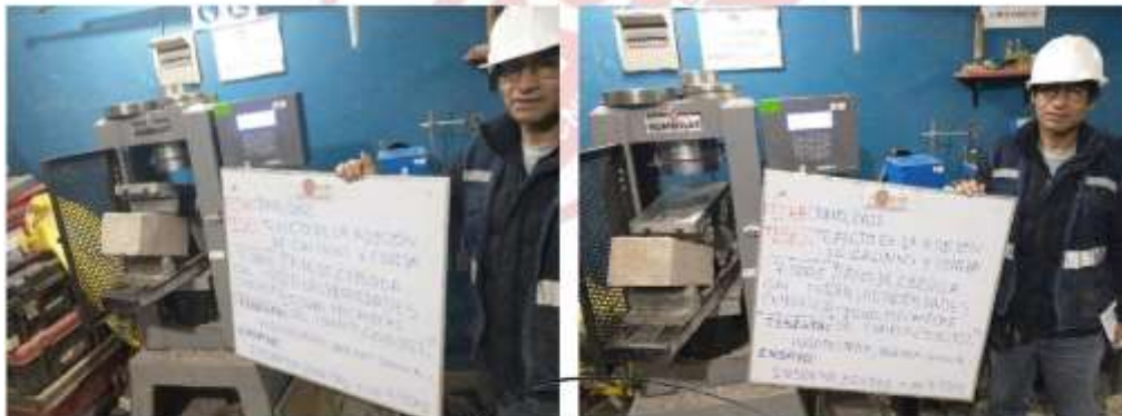
fotografía 3 y fotografía 4 Rotura de vigas. Derecha: 4% de cal + 5% de ceniza, Izquierda: 4% de cal + 6% de ceniza.
