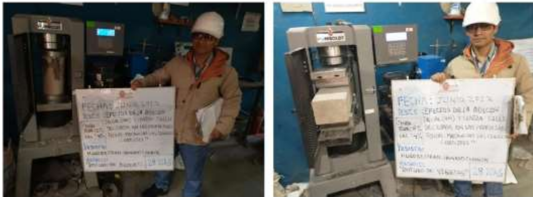
Fotografía 11 Y Fotografía 12 Compresión uniaxial de unidades de concreto. Derecha: 4% de ceniza y 5% de cal., izquierda: 4% de ceniza y 6% de cal.
