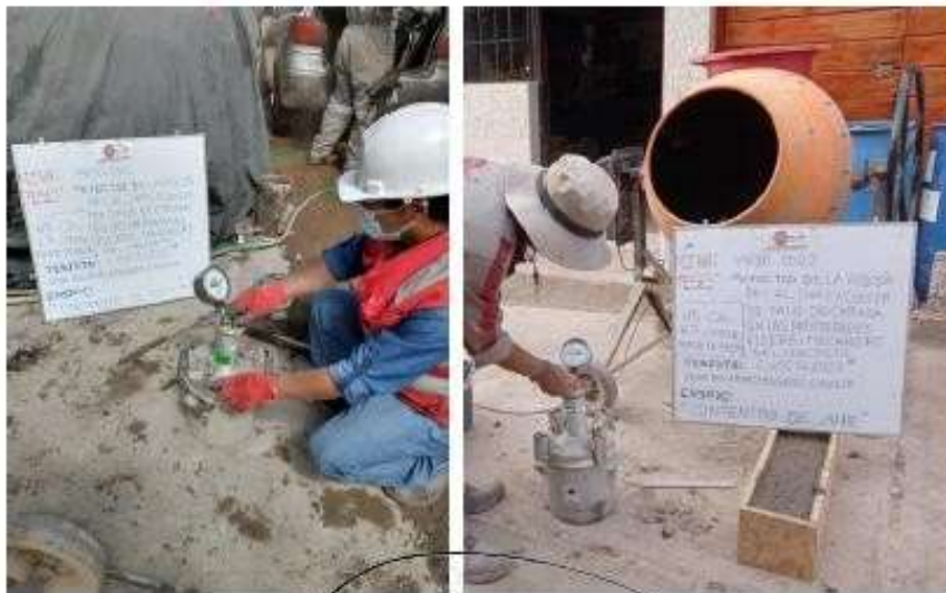
Fotografía 7 y Fotografía 8 Determinación del contenido de aire del concreto (Patrón + 6% de ceniza + 4% de cal).
