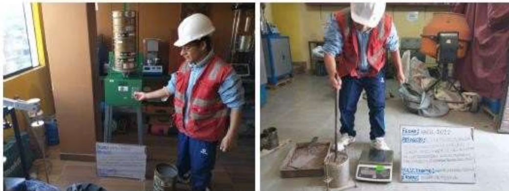
Fotografía 1 Y Fotografía 2 IZQUIERDA: Análisis granulométrico, DERECHA: Determinación del peso unitario varillado.
