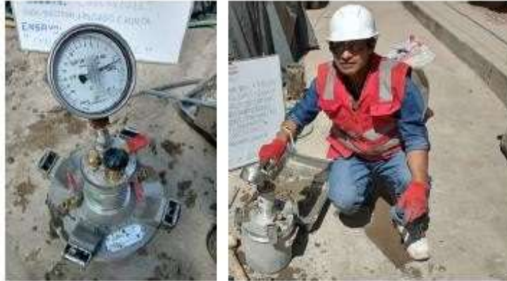
Fotografía 1 y Fotografía 2 Determinación del contenido de aire del concreto (Patrón).
