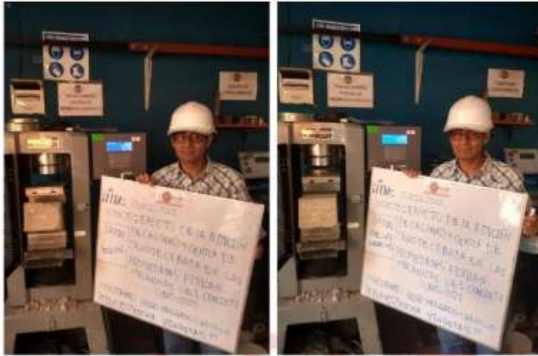
fotografía 5 y fotografía 6 Rotura de vigas. Derecha: Patrón, Izquierda: 4% de cal + 4% de ceniza.
