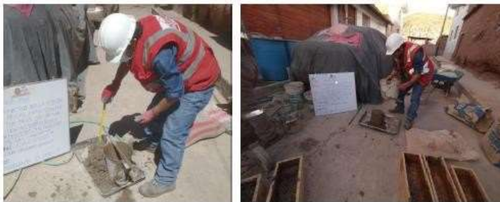
Fotografía 1 y Fotografía 2 Determinación del SLUMP. (concreto patrón).
