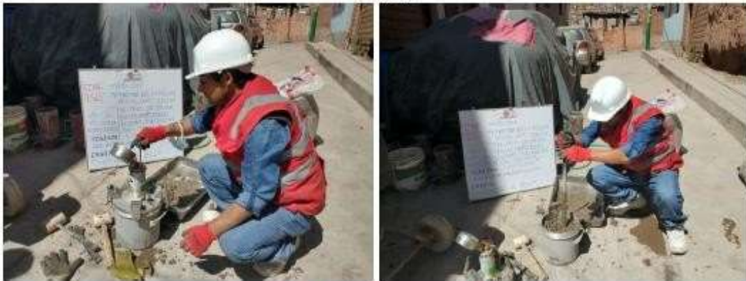
Fotografía 3 y Fotografía 4 Determinación del contenido de aire del concreto (Patrón + 4% de ceniza + 4% de cal).
