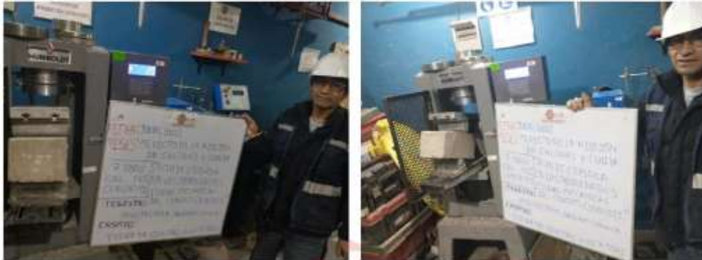
fotografía 1 y fotografía 2 Rotura de vigas. Derecha: Patrón, Izquierda: 4% de cal + 4% de ceniza.
