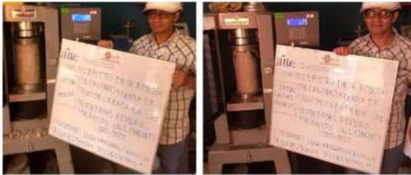
Fotografía 5 Y Fotografía 6 Compresión uniaxial de unidades de concreto. Derecha: Patrón, izquierda: 4% de ceniza y 4% de cal.
