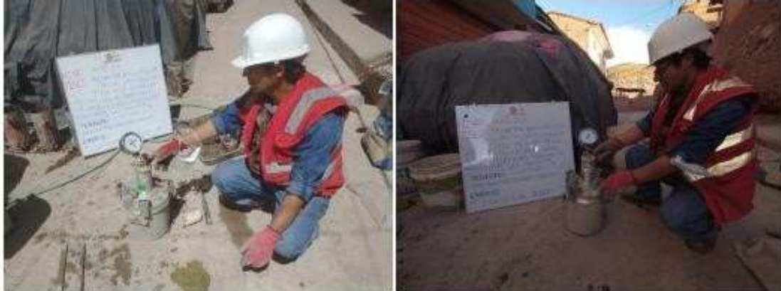
Fotografía 5 y Fotografía 6 Determinación del contenido de aire del concreto (Patrón + 5% de ceniza + 4% de cal).
