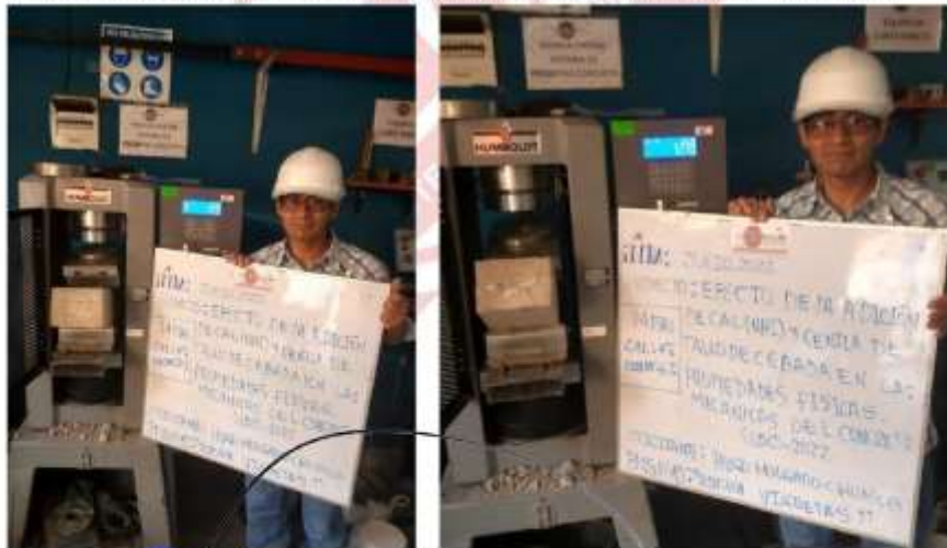
fotografía 7 Rotura de vigas. Derecha: 4% de cal + 5% de ceniza, Izquierda: 4% de cal + 6% de ceniza
