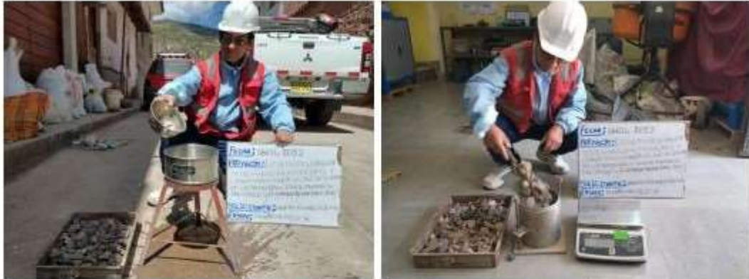
Fotografía 5 Y Fotografía 6 IZQUIERDA: Lavado de muestras para posterior análisis granulométrico, DERECHA: Determinación del eso unitario.
