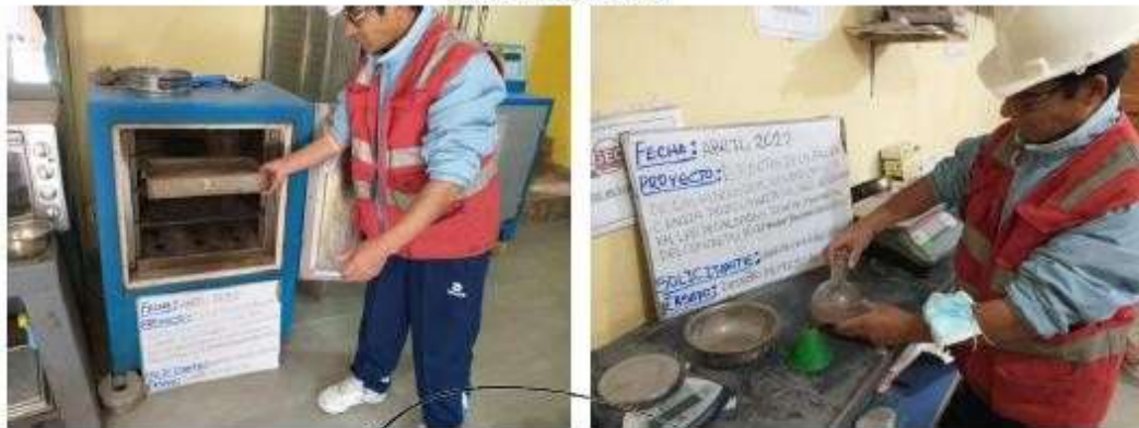
Fotografía 3 Y Fotografía 4: IZQUIERDA: Secado de las muestras para determinar el peso específico, DERECHA: Determinación del peso específico.
