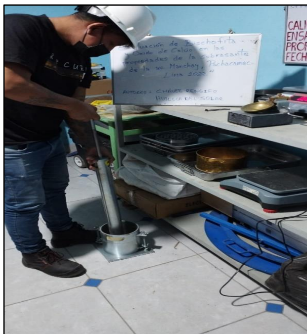
Figura 17. Compactación del suelo.
