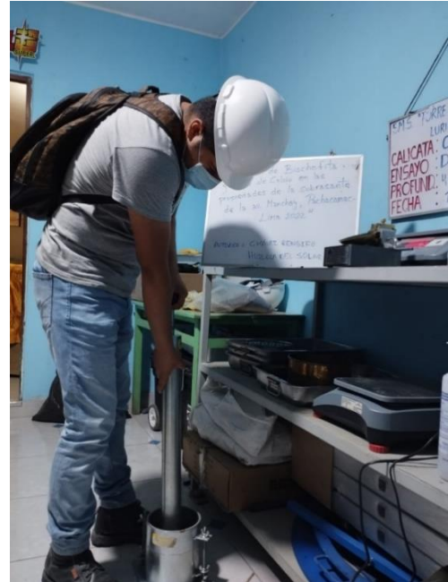
Compactación del suelo
