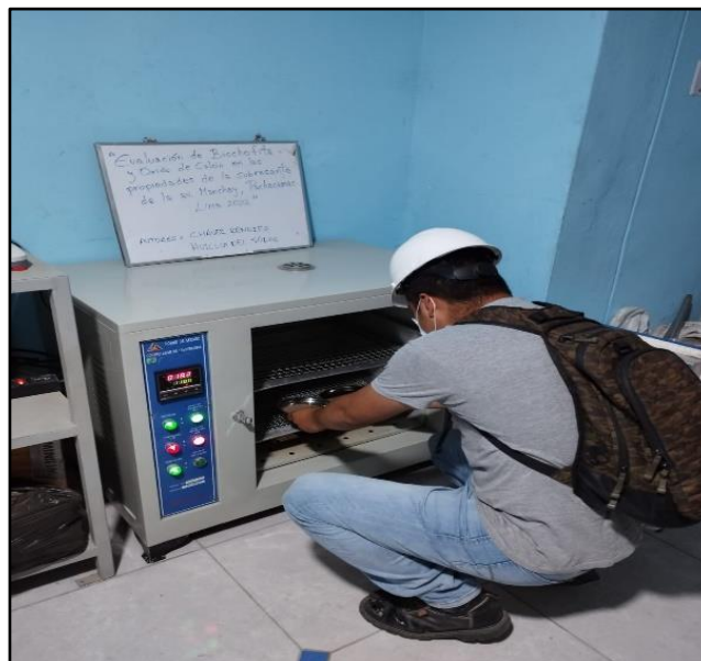
Figura 21. Secado de muestra en estufa a 110°C +/-5°C.
