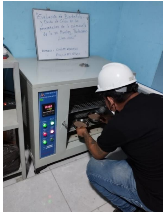
Secado de muestra en estufa a 110^{\circ}\text{C} \pm 5^{\circ}\text{C}
