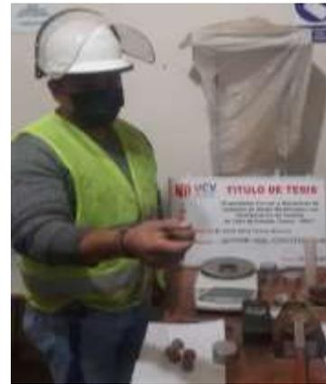
**Figura N° 17:** Prueba a la resistencia seca de la bola
