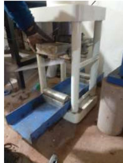
**Figura N° 23:** Ensayo de resistencia a la flexión
