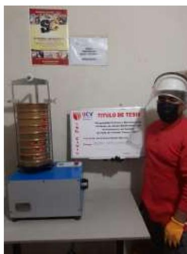
**Figura N° 54:** Ensayo de granulometría para adobe
