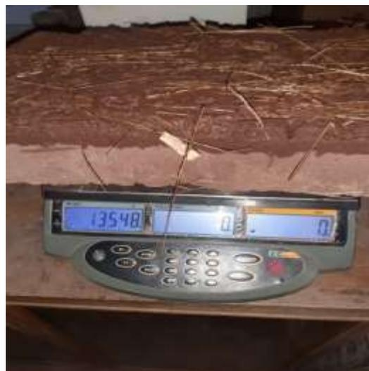
Figura N° 61: Ensayo de succión
