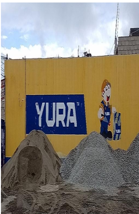
Fotografía 6: Obtención del agregado fino y grueso.
