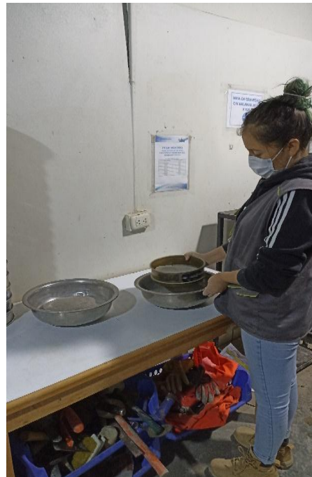
Fotografía 2: Tamizado de la ceniza de bagazo de caña de azúcar por la malla N°200
