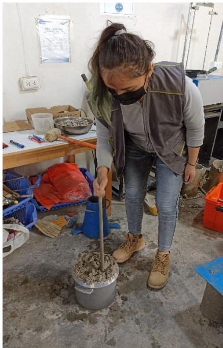
Fotografía 12: Ensayo del peso unitario del concreto.
