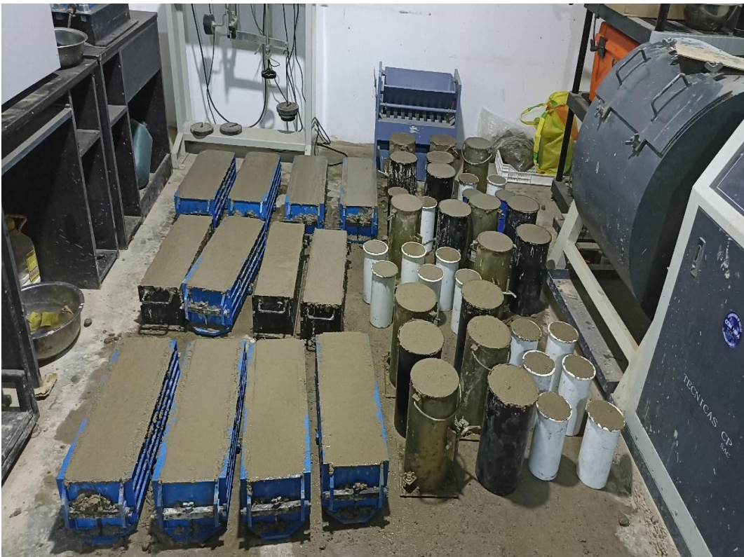
Fotografía 18: Vaciado de briquetas y viguetas.
