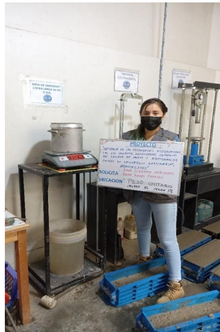
Fotografía 12: Ensayo del peso unitario del concreto.
