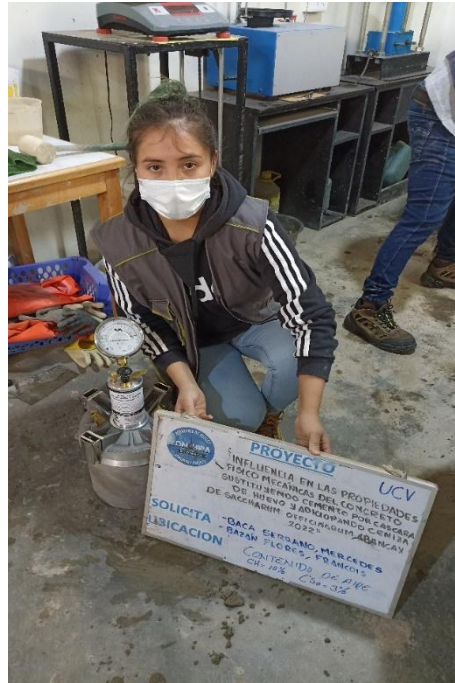
Fotografía 15: Ensayo del contenido de aire del concreto experimental.
