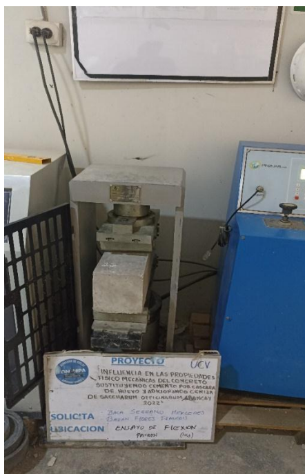
Fotografía 26: Ensayo de la resistencia a la flexión del concreto patrón y C° experimental.
