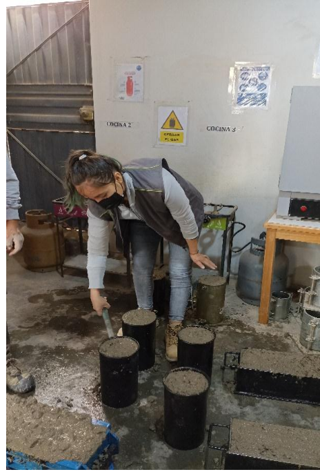
Fotografía 8: varillado y golpes con el mazo de goma a las briquetas con concreto.
