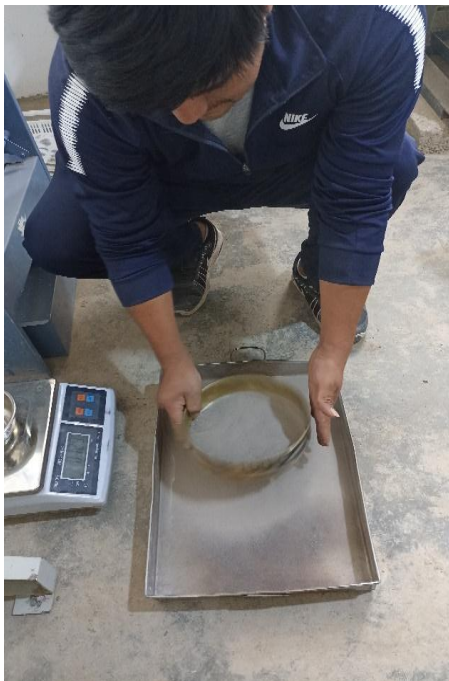
Fotografía 2: Tamizado de la ceniza de bagazo de caña de azúcar por la malla N°200
