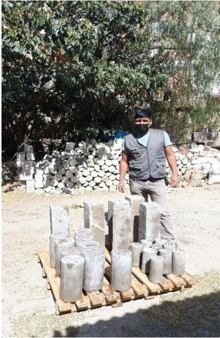
Fotografía 21: Briquetas y viguetas para la rotura de los 28 días (c° Patrón y experimental)
