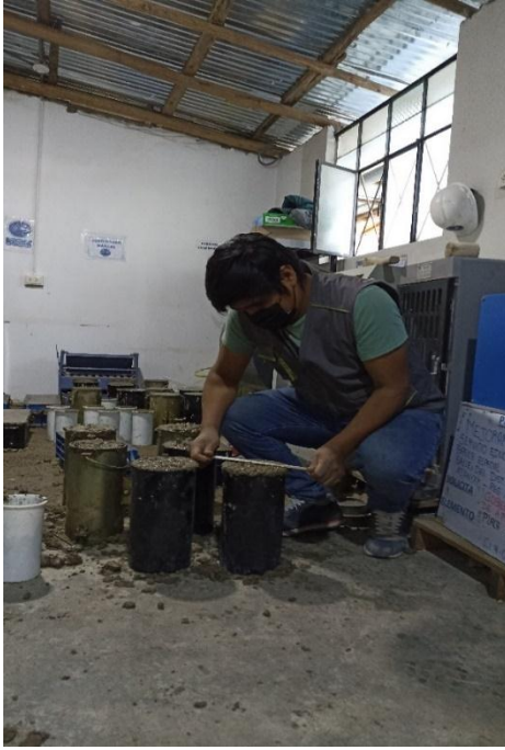
Fotografía 9: Enraso de las briquetas y varillado de las viguetas.
