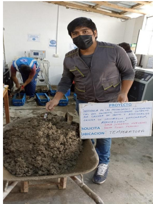
Fotografía 16: Ensayo de la temperatura del concreto patrón.
