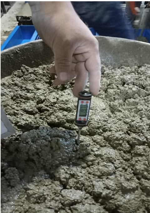
Fotografía 16: Ensayo de la temperatura del concreto patrón.
