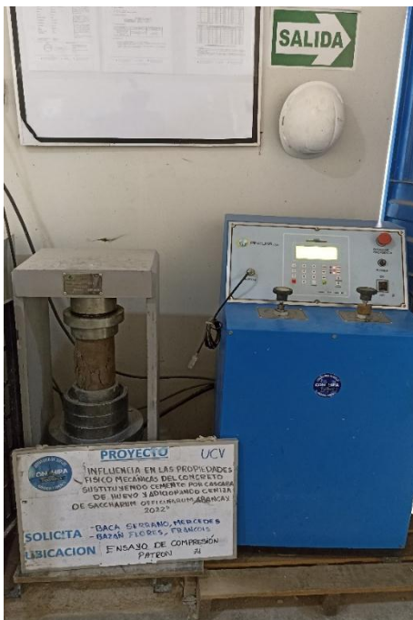
Fotografía 22: Ensayo de la resistencia a la compresión del concreto patrón y C° experimental
