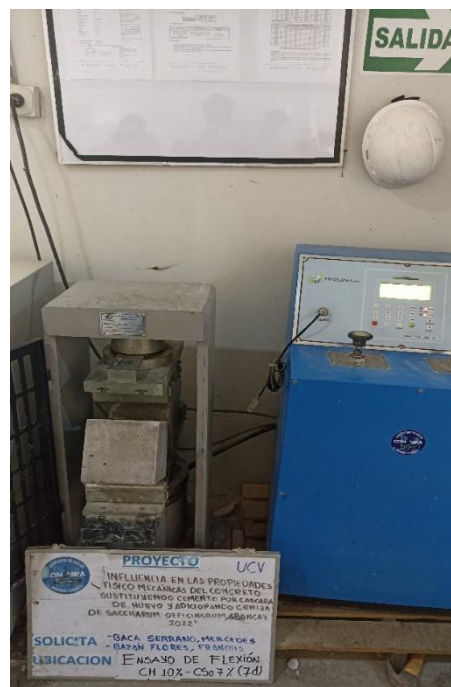
Fotografía 26: Ensayo de la resistencia a la flexión del concreto patrón y C° experimental.
