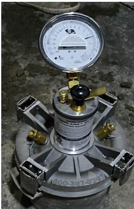
Fotografía 14: Ensayo del contenido de aire del concreto patrón.
