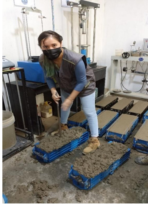
Fotografía 9: Enraso de las briquetas y varillado de las viguetas.
