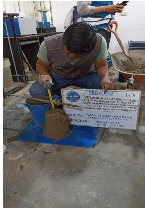
Fotografía 11: Ensayo de la consistencia o trabajabilidad del concreto experimental.
