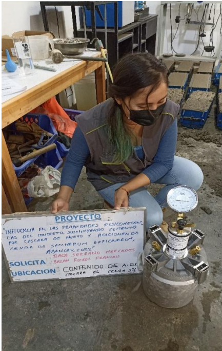
Fotografía 15: Ensayo del contenido de aire del concreto experimental.
