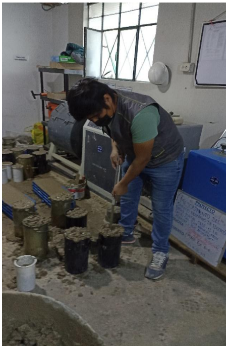
Fotografía 8: varillado y golpes con el mazo de goma a las briquetas con concreto.
