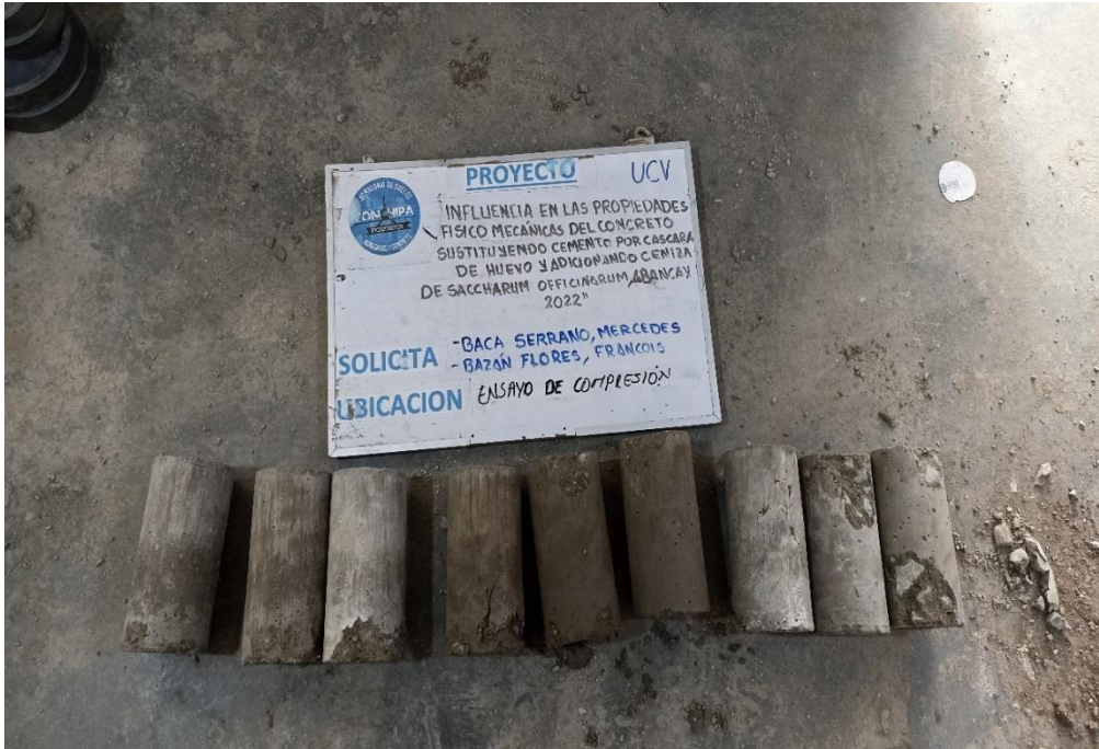
Fotografía 23: Ensayo de la resistencia a la compresión del concreto patrón y C° experimental
