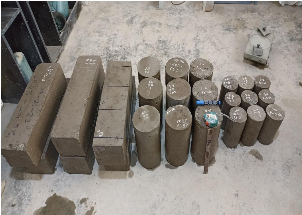
Fotografía 20: Briquetas y viguetas para la rotura de los 7 días (c° patrón y experimental)
