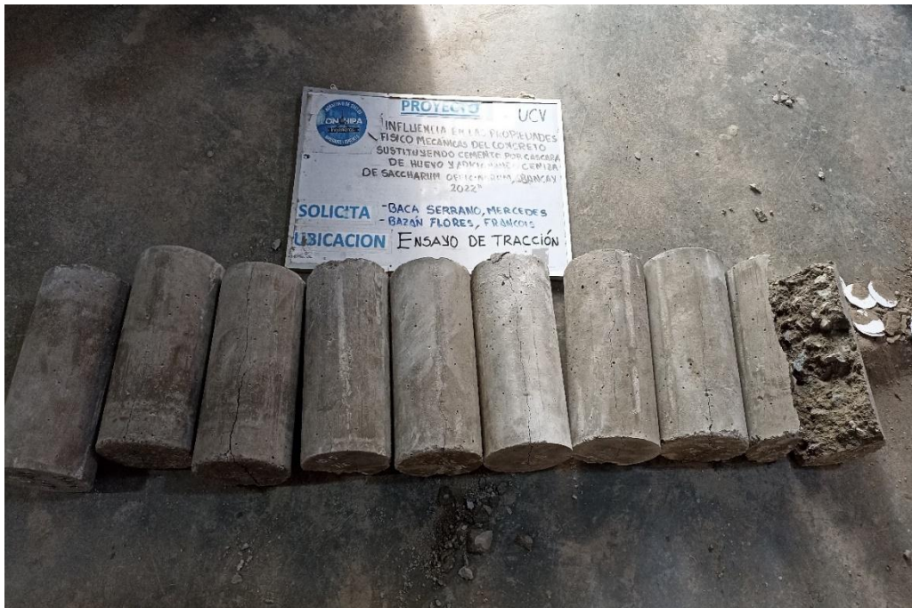
Fotografía 25: Ensayo de la resistencia a la tracción del concreto patrón y C° experimental.
