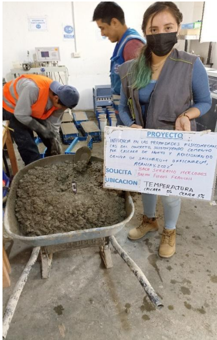
Fotografía 17: Ensayo de la temperatura del concreto experimental.
