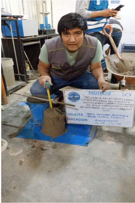
Fotografía 11: Ensayo de la consistencia o trabajabilidad del concreto experimental.
