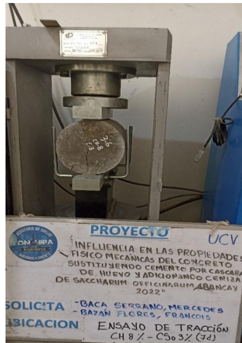
Fotografía 24: Ensayo de la resistencia a la tracción del concreto patrón y C° experimental
