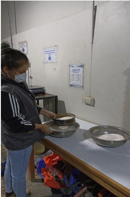
Fotografía 5: Tamizado de la cascara de huevo por la malla N°200
