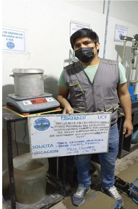
Fotografía 13: Ensayo del peso unitario del concreto experimental.
