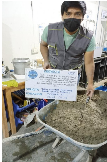
Fotografía 17: Ensayo de la temperatura del concreto experimental.
