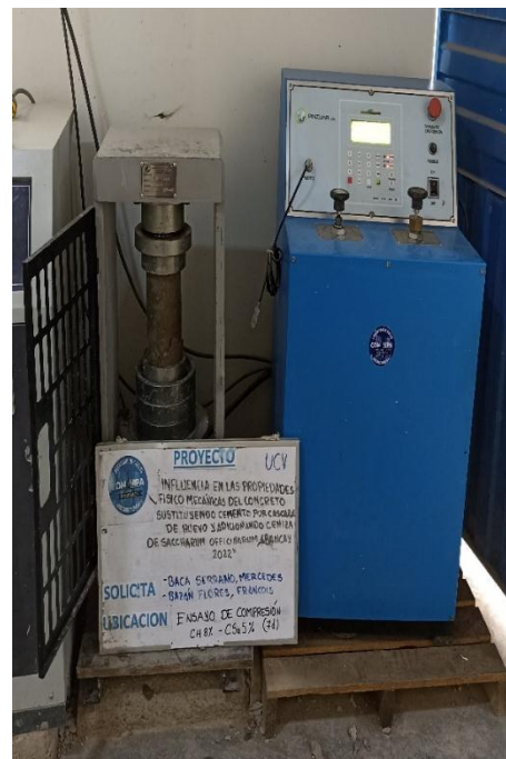
Fotografía 22: Ensayo de la resistencia a la compresión del concreto patrón y C° experimental
