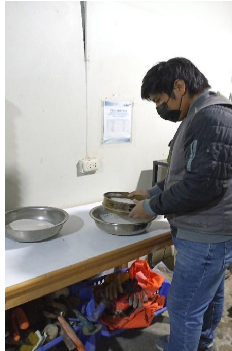
Fotografía 5: Tamizado de la cascara de huevo por la malla N°200
