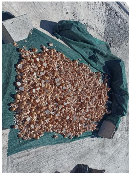
Fotografía 4: Lavado y secado de manera natural de la cascara de huevo.
