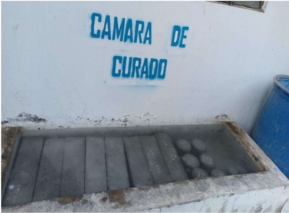
Fotografía 19: Curado de las muestras de concreto patrón y experimental.
