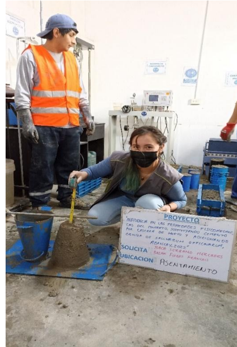
Fotografía 10: Ensayo de la consistencia o trabajabilidad del concreto patrón.
