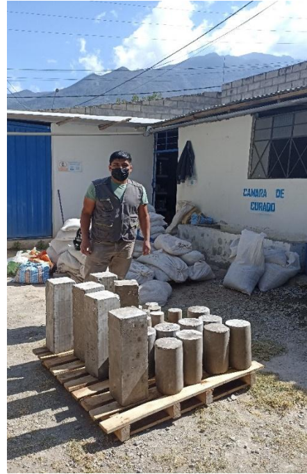
Fotografía 21: Briquetas y viguetas para la rotura de los 28 días (c° Patrón y experimental)
