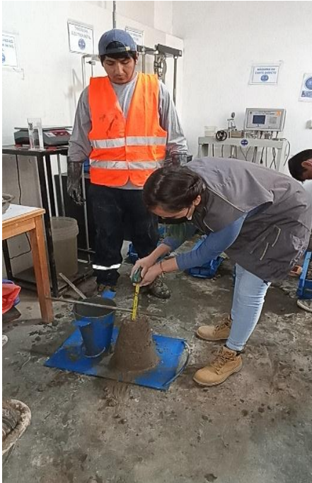
Fotografía 10: Ensayo de la consistencia o trabajabilidad del concreto patrón.
