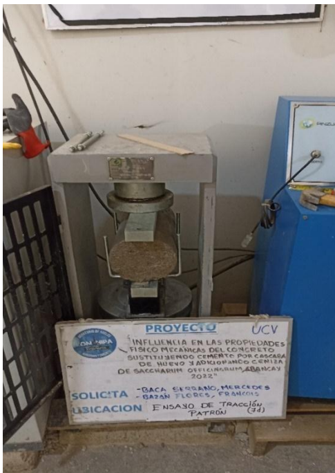
Fotografía 24: Ensayo de la resistencia a la tracción del concreto patrón y C° experimental
