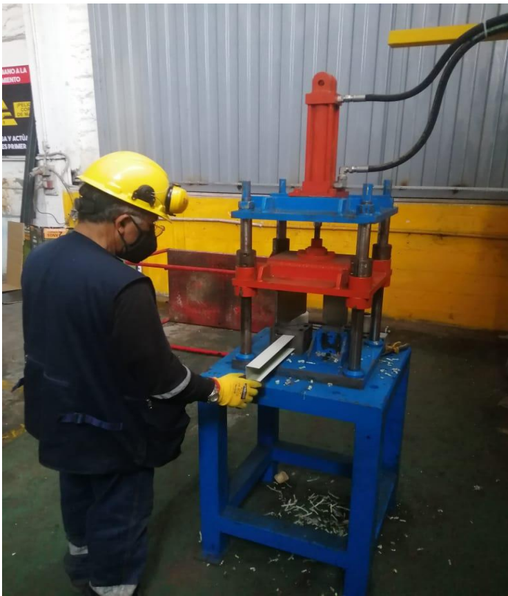
Figura 26: Fotografía de Operario manejando la cortadora
