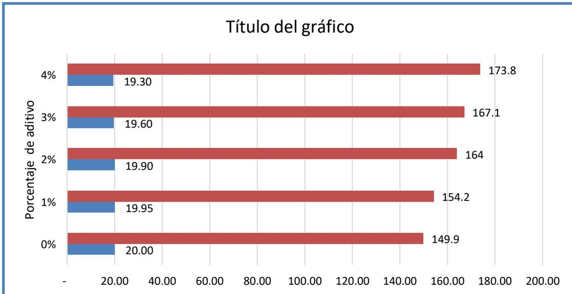
**Figura 16:** Se observa que a menos temperatura mayor resistencia en 3 días
