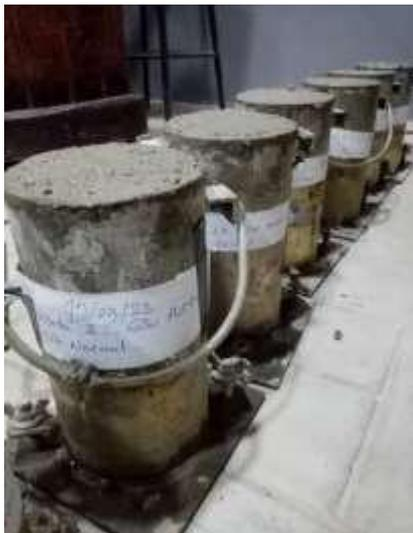
Desmolde de probeta sin aditivo
