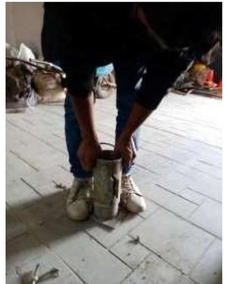
desmolde de probeta sin aditivo
