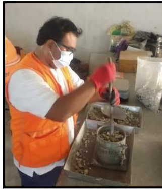
Figura20. Proceso para calcular peso unitario de grava. Fuente: Elaboración Propia
