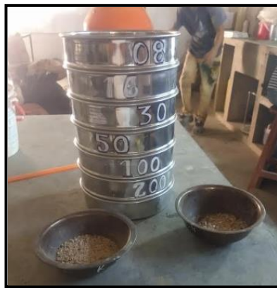
Figura6. Tamices usados para el ensayo de granulometría.
