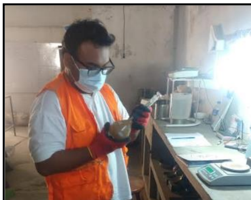
Figura15. Picnómetro con material y en movimiento para sacar vacíos. Fuente: Elaboración Propia
