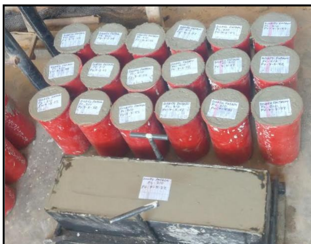
Figura5. Probetas y vigas con las dosificaciones indicadas. Fuente: Elaboración Propia
