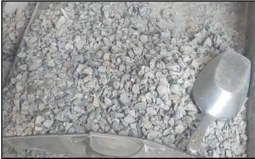
Figura2. Resultado de proceso de trituración de concreto reciclado.
