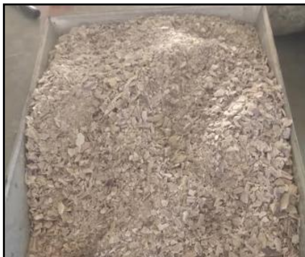
Figura4. Resultado de proceso de trituración de concha de abanico. Fuente: Elaboración Propia
