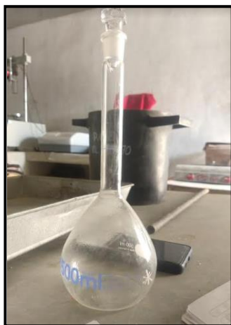
Figura14. Picnómetro usado para el peso específico de la arena. Fuente: Elaboración Propia
