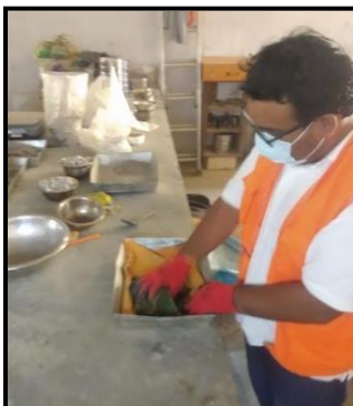
Figura22. Eliminación de película de agua visible. Fuente: Elaboración Propia
