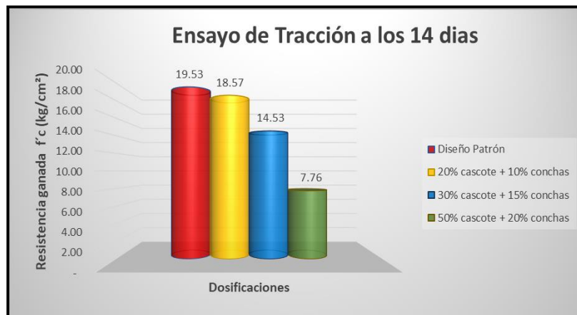
Figura28. Grafica de resultados a la tracción a los 14 días. Fuente. Elaboración propia.
