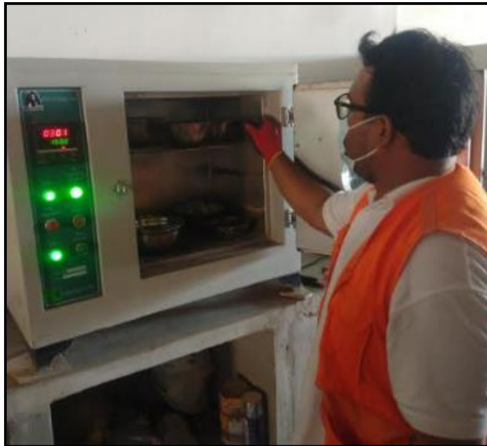
Figura8. Proceso de secado al horno 110°C+5°C.
