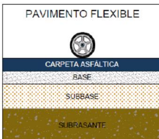
Figura 2. Paquete estructural de un pavimento flexible
