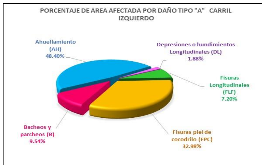
Gráfico 4. Resumen áreas afectadas por daños Tipo A – Carril izquierdo
