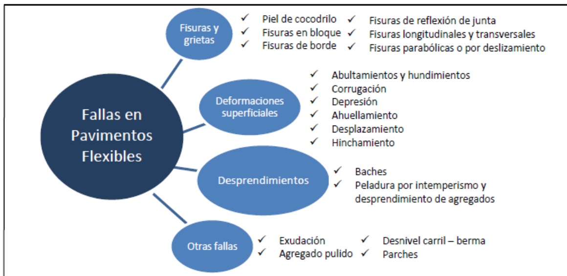
Figura 3. Tipo de falla en Pavimento Flexible
