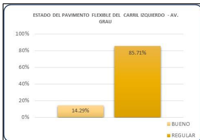
Gráfico 3. Estado del pavimento Flexible.
