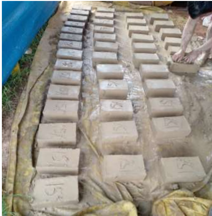
Figura 22: Ladrillos con el 15% de inclusión de lodo residual
