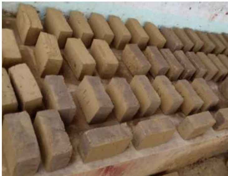
Figura 23: Se voltearon los ladrillos para que puedan secar por las otras caras
