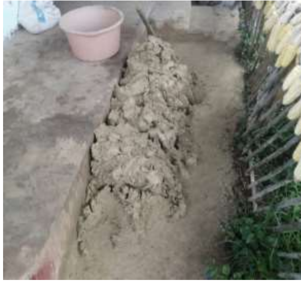
Figura 18: Mezcla para elaborar 50 ladrillos con el 5 % de inclusión de lodo residual
