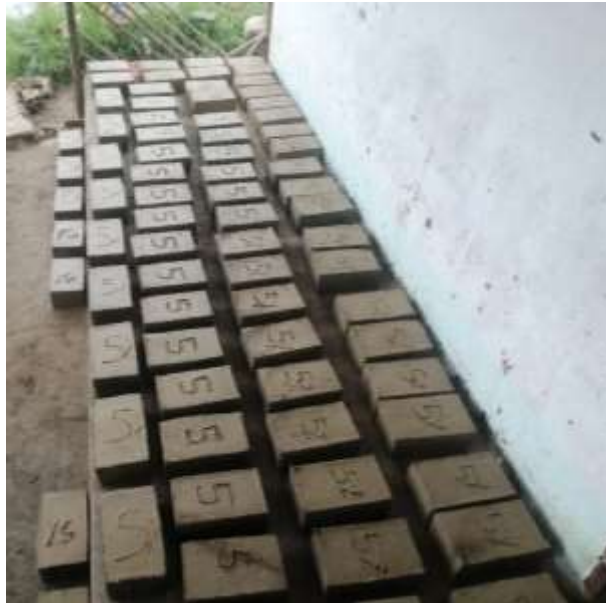
Figura 20: Ladrillos con el 5% de inclusión de lodo residual
