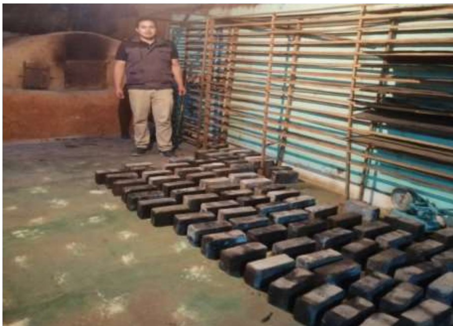
Figura 25: Cocción de ladrillos artesanales
