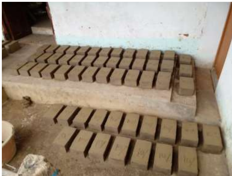
Figura 21: Ladrillos con el 10% de inclusión de lodo residual
