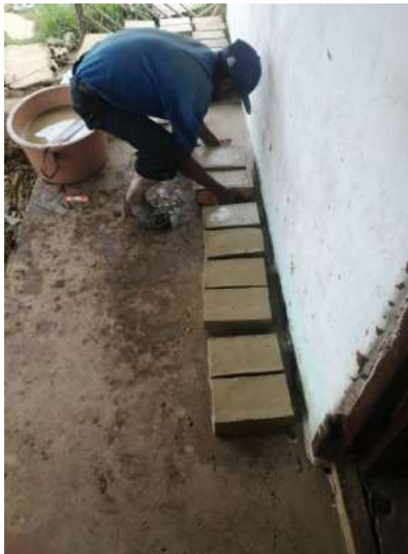
Figura 19: Moldeado de ladrillos con el 5 % de inclusión de lodo residual
