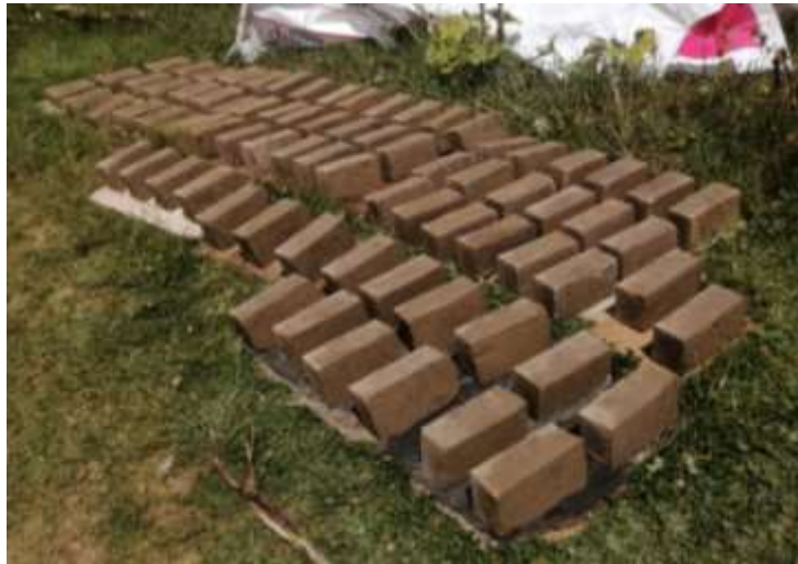
Figura 24: Se voltearon los ladrillos para que puedan secar por las otras caras
