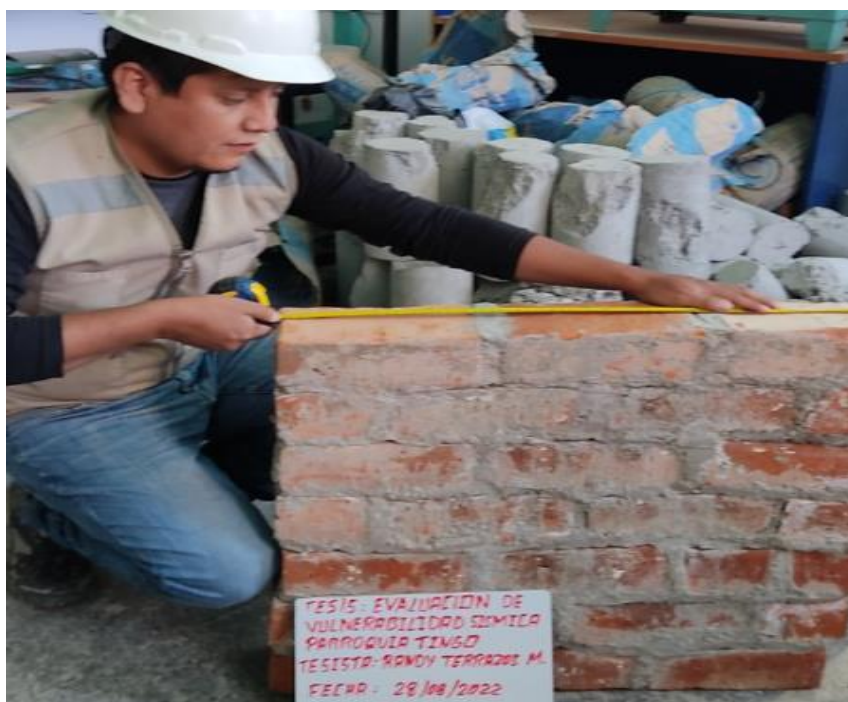
Figura 11. Ensayo de resistencia de muretes.
