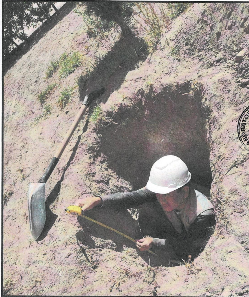
EXCAVACION DONDE SE EVIDENCIA LA AUSENCIA DE NIVEL FREÁTICO.
