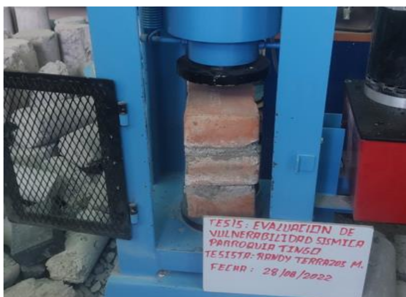
Figura 12. Ensayo de resistencia de pilas.
