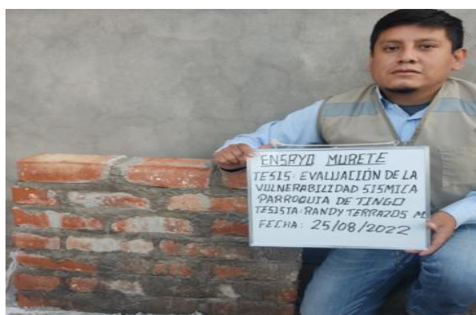
Figura 33. Ensayo de compresión diagonal de murete.
