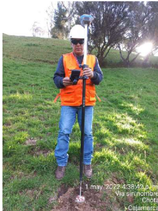
Figura 3: Toma de punto del Bm, con el GPS Diferencial.
