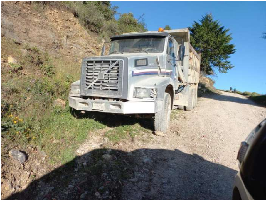
Figura 1: Se evidencia presencia de vehículo pesado de 3 ejes. Fuente: Fotos tomadas por los tesistas.
