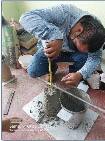
Figura 12. Asentamiento de concreto
