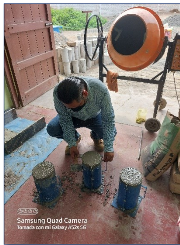
Figura 13. Preparación de concreto 210kg/cm 2 en moldes cilíndricos
