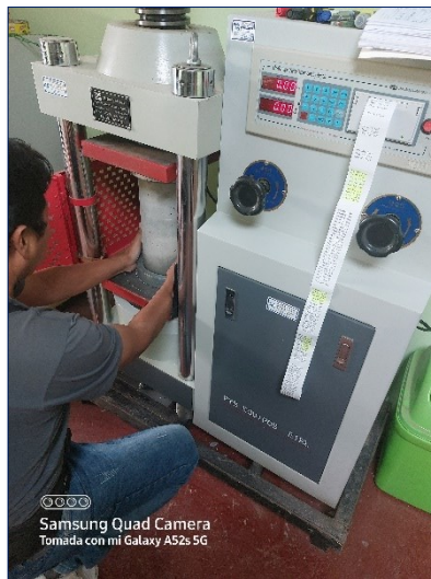
Figura 19. Resultados de ensayo de compresión de probetas en prensa hidráulicas
