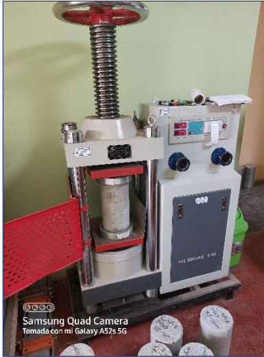
Figura 16. Ensayo de compresión de una probeta en prensa hidráulicas
