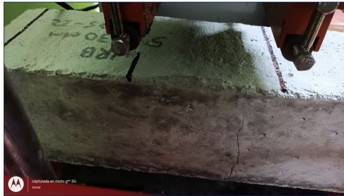
Figura 25. Presentación de probetas prismáticas en prensa – concreto 210kg/cm 2
