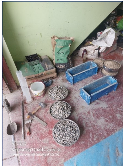
Figura 20. Dosificación para probetas prismáticas – concreto 210kg/cm 2
