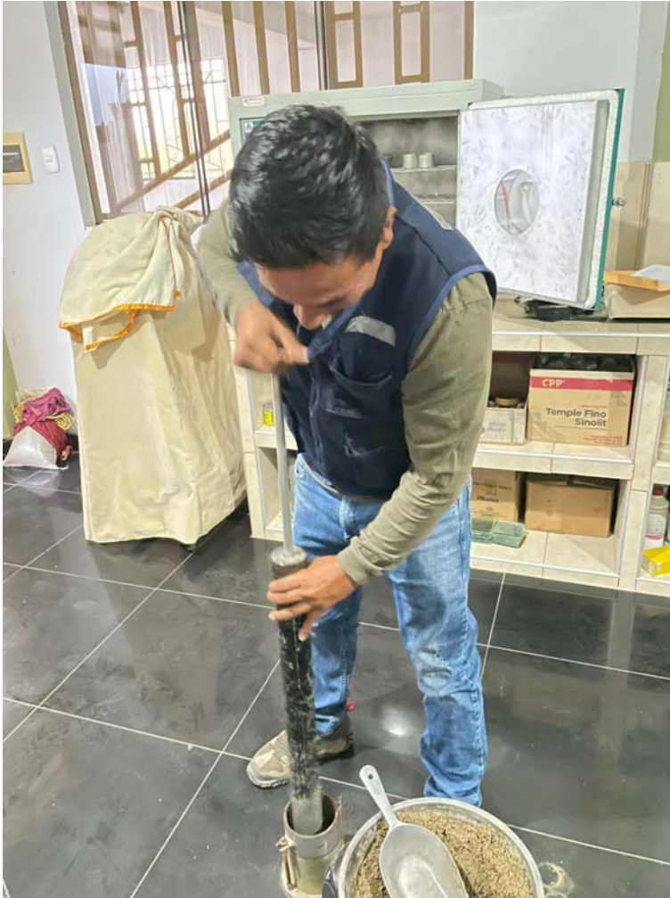
Foto N° 07: Compactación de material – ensayo de CBR
