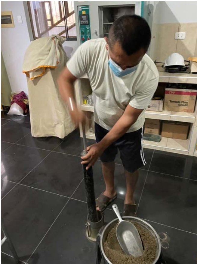
Foto N° 10: compactación de material – ensayo de CBR
