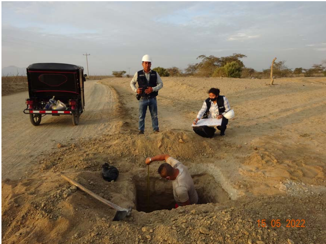
Foto N° 04: Calicata 03 – km 2+000, Prof: 1.50m
