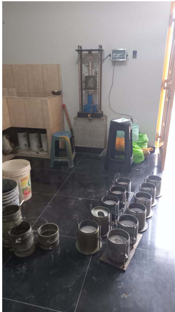
Foto N° 04: Moldes cilíndricos con mezclas con diferentes dosificaciones para los ensayos.
