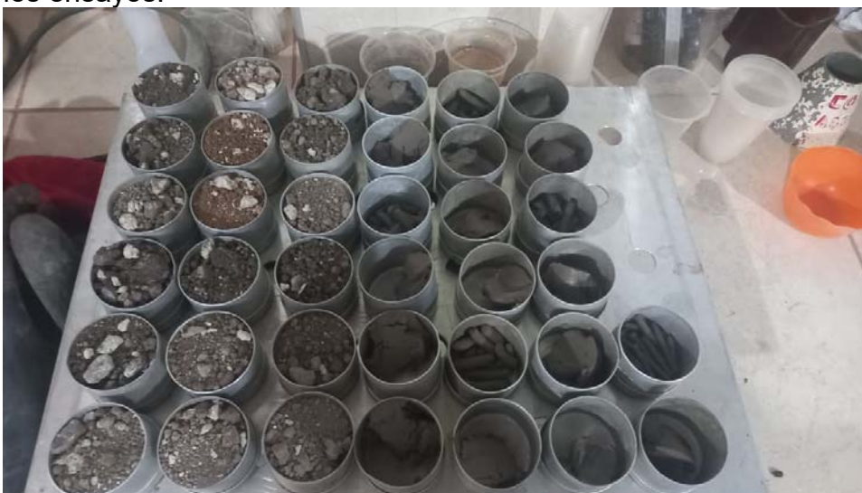
Foto N° 04: Moldes cilíndricos con mezclas con diferentes dosificaciones para los ensayos.
