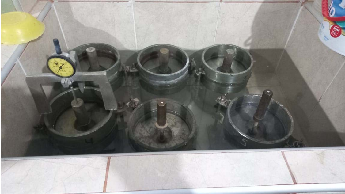
Foto N° 01: Moldes cilíndricos de Metal, para las pruebas de CBR
