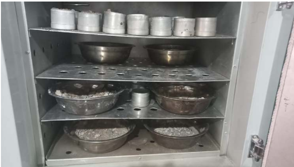
Foto N° 12: Secado de material – ensayo de CBR
