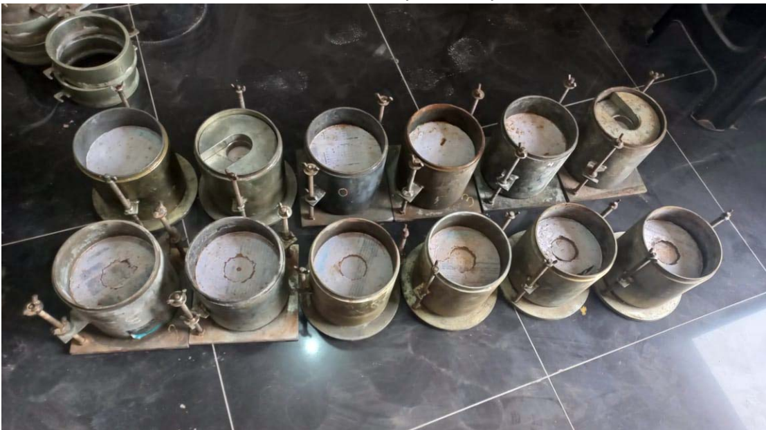
Foto N° 02: Moldes cilíndricos de Metal, para las pruebas de CBR
