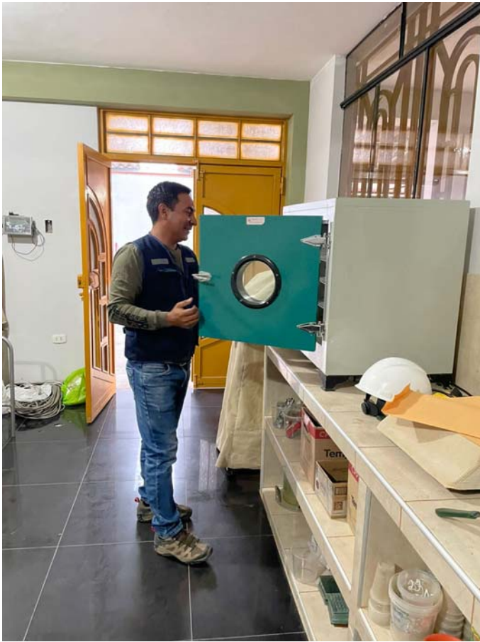
Foto N° 11: Secado de material – ensayo de CBR
