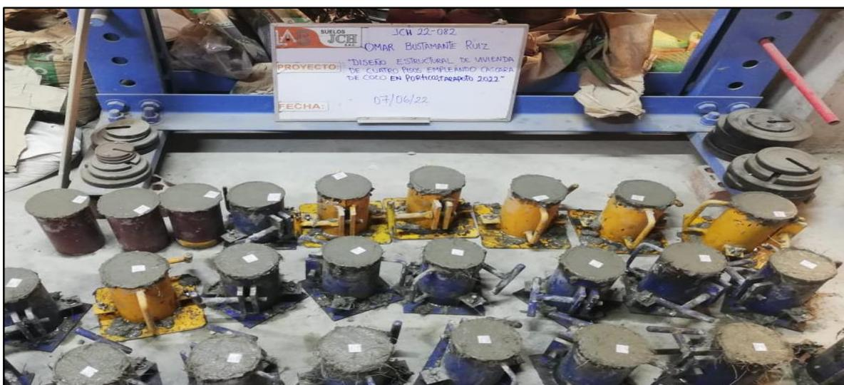
Figura 13. Probetas de concreto
