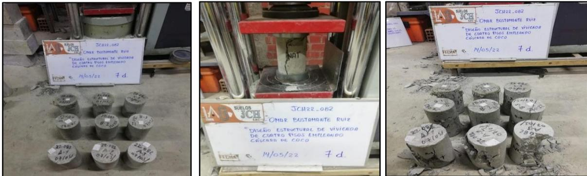
Figura 14: Ensayo de la resistencia a la compresión en 7 días de curado.
