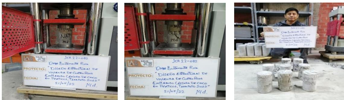
Figura 16. Ensayo de la resistencia a la compresión en 14 días de curado.
