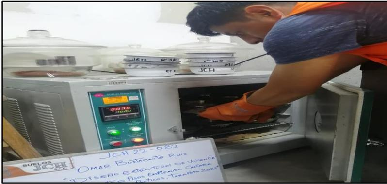
Figura 6. Secado de la muestra, laboratorio JCH
