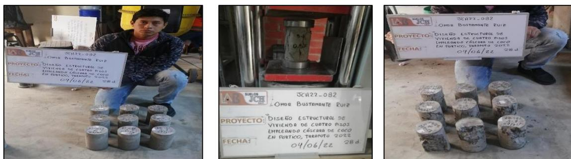
Figura 18. Ensayos de la resistencia a la compresión (28 días de curado)
