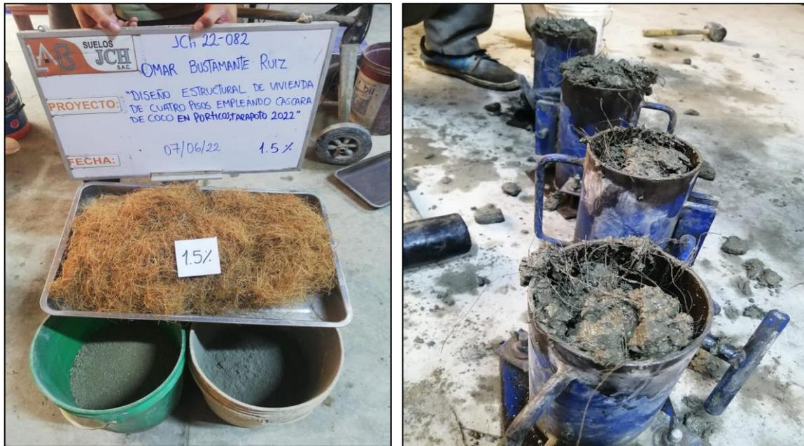
Figura 12. Diseño de mezcla con 1.5% de cascara de coco
