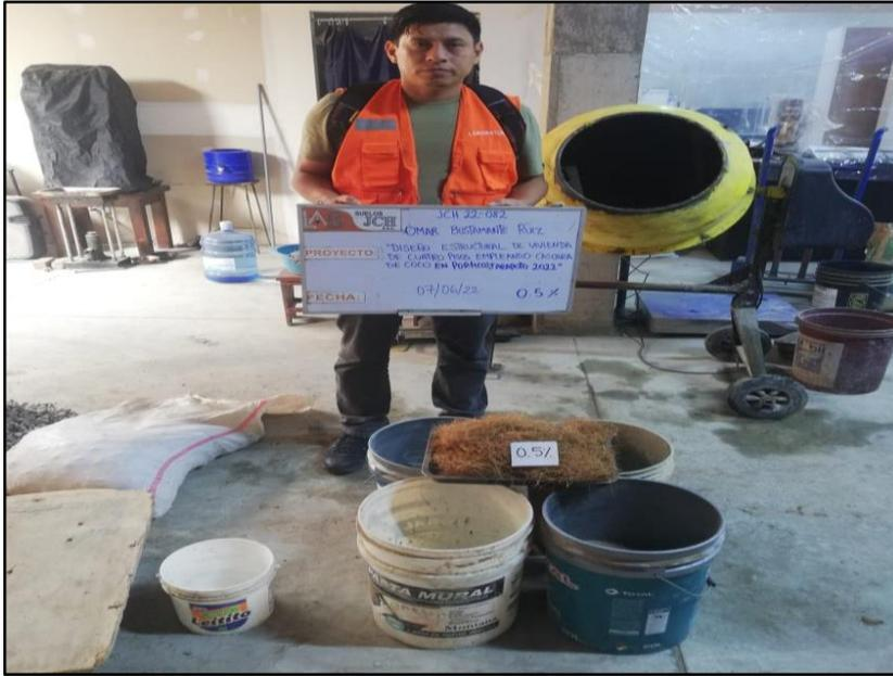
Figura 11. Diseño de mezcla con 0.5% de cascara de coco
