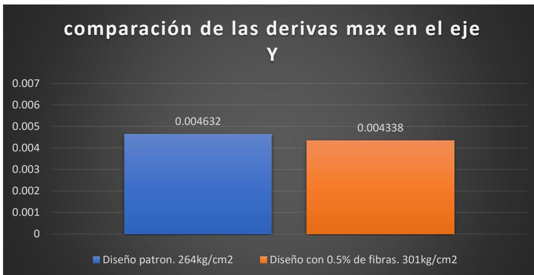
Figura 31. Gráfico de barras de las derivas máximas en Y.
