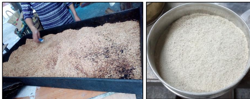
Figura 7. Calcinación y Tamizado de Cascara de Arroz
