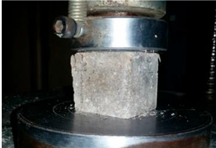
Figura 3. Resistencia a la Compresión
