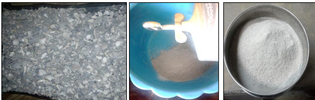
Figura 8. Calcinación, Molienda y Tamizado de la concha de caracol
