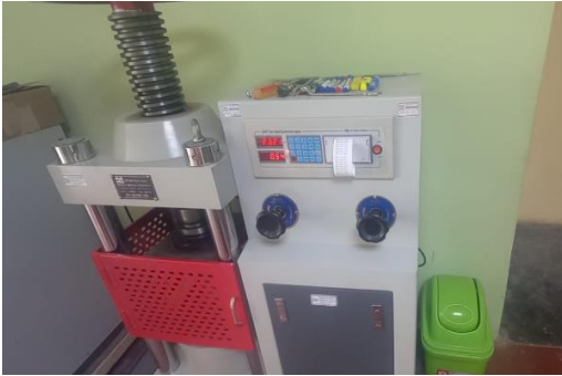
Anexo 23.11. máquina de resistencia a la compresión con Probeta con porcentajes de 0.0 %,0.5% y 1%. A altas temperaturas.
