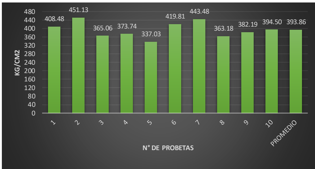
Figura 26. Gráfico de ruptura a los 28 días con 0.5% de microfibras de polipropileno a temperatura de ambiente.
