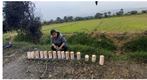
Anexo 23.10. Probeta con porcentajes de 0.0 %,0.5% y 1%. A altas temperaturas, Falla tipo 3.
