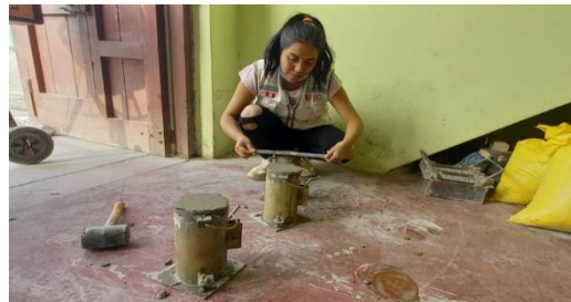
Anexo 21.4. elaboración de probetas para el diseño de mezcla de un concreto 350 kg/cm 2 adicionado microfibras.
