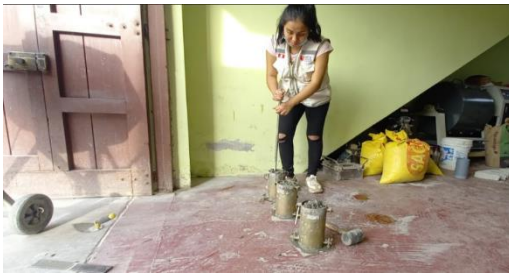
Anexo 21.3. elaboración de probetas para el diseño de mezcla de un concreto 350 kg/cm 2 adicionado microfibras.
