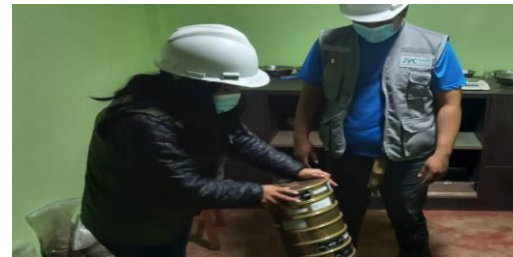
Anexo 14.2. agitamos el agregado fino en los tamices de (3/8", N° 4, N°8, N°16, N° 30, N°50, N°100, N° 200).
