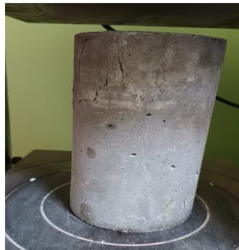
Anexo 22.4. Probeta con porcentajes de 0.0 %,0.5% y 1%. a temperatura ambiente, tipo de Falla Tipo 5.
