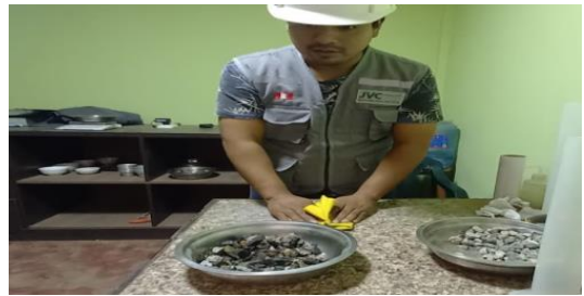
Anexo 17.4. secamos con un paño la muestra de agregado grueso.
