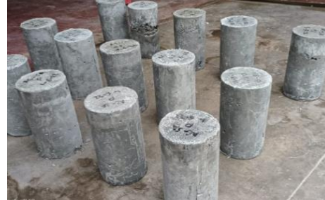
Anexo 22.2. Probetas de concreto 350 kg/cm 2 adicionando microfibras 0%,0.5% y 1%
