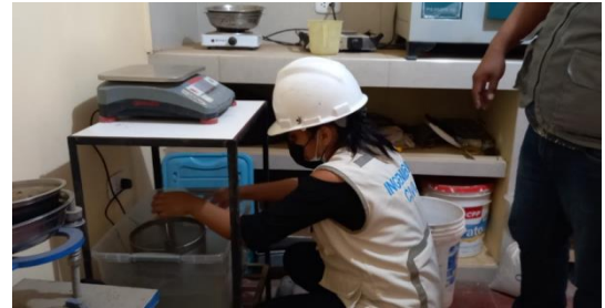
Anexo 17.6. ponemos la canastilla metálica con el agregado grueso en la balanza.
