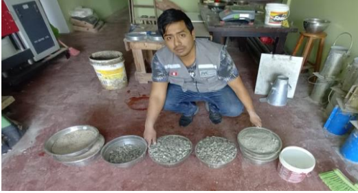
Anexo 20.1. material para el diseño de mezcla de un concreto 350 kg/cm 2 .
