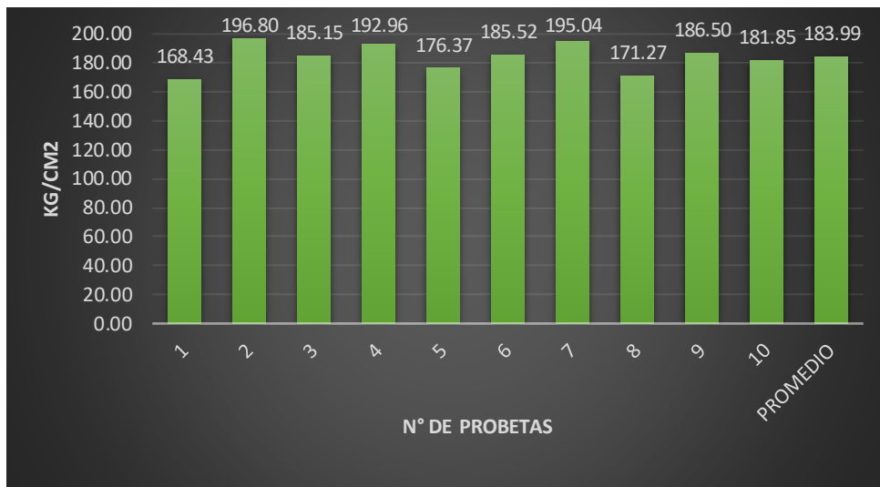
Figura 31. Gráfico de ruptura de probetas a los 28 días de edad con 0.0% de microfibras de polipropileno sometido a temperaturas mayores de 500°C.
