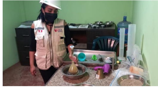
Anexo 18.10. ponemos en baño maría el agregado fino en la fiola con agua.
