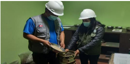
Anexo 14.1. Añadimos el agregado fino en los tamices de (3/8", N° 4, N°8, N°16, N° 30, N°50, N°100, N° 200).
