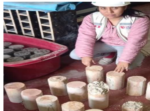
Anexo 23.14. Probeta con porcentajes de 0.0 %,0.5% y 1%. A altas temperatura, Falla Tipo 3.
