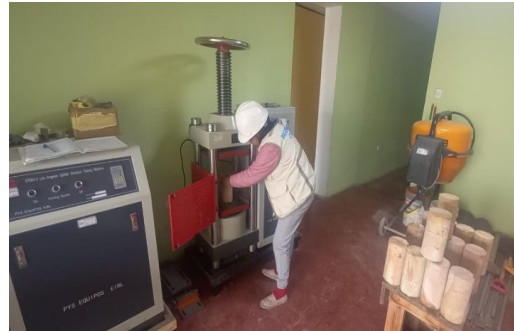
Anexo 23.12. ensayo de resistencia a la compresión con Probeta con porcentajes de 0.0 %,0.5% y 1%. A altas temperaturas.
