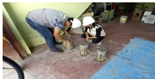
Anexo 20.8. elaboración de probetas para el diseño de mezcla de un concreto 350 kg/cm 2 .
