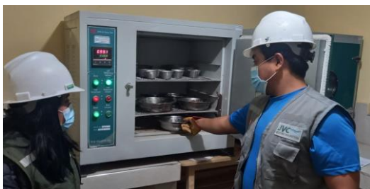
Anexo 13.3. Dejamos secar en el horno los agregados grueso y fino con agua por 24 horas.
