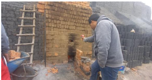
Anexo 23.7. medida del horno de ladrillera con ayuda de pirómetro
