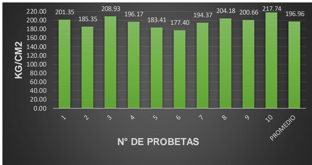
Figura 32. Gráfico de ruptura de probetas a los 28 días de edad con 0.5% de microfibras de polipropileno sometido a temperaturas mayores de 500°C.
