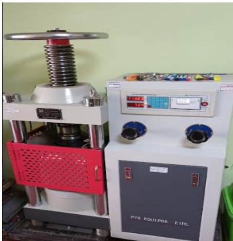
Anexo 22.3. ensayo de resistencia a la compresión para el concreto 350 kg/cm 2 adicionando microfibras 0%,0.5% y 1% a temperatura ambiente.
