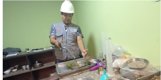
Anexo 18.12. retiramos el agregado fino con agua y lo colocamos en un recipiente.
