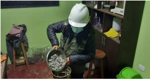
Anexo 13.5. Añadimos el agregado grueso en los tamices de (1 ½", 1", ¾", ½", 3/8", N°4).
