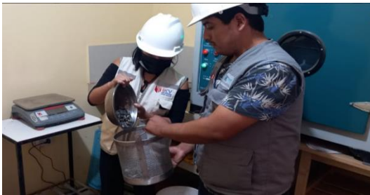
Anexo 17.5. agregar el agregado grueso en la canastilla metálica.
