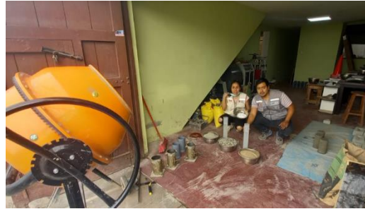
Anexo 21.2. materiales para el diseño de mezcla de un concreto 350 kg/cm 2 adicionado microfibras.
