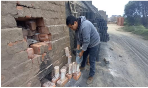
Anexo 23.9. Probeta con porcentajes de 0.0 %,0.5% y 1%. A altas temperaturas, Falla tipo3.
