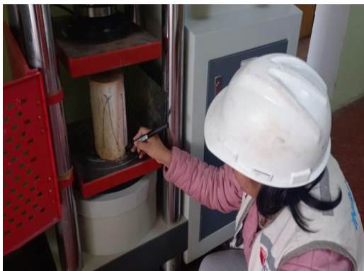
Anexo 23.13. Probeta con porcentajes de 0.0 %,0.5% y 1%. a altas temperatura, Falla Tipo 3.
