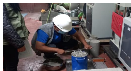
Anexo 15.4. Enrasamos con la barra apisonadora en el recipiente con agregado grueso.
