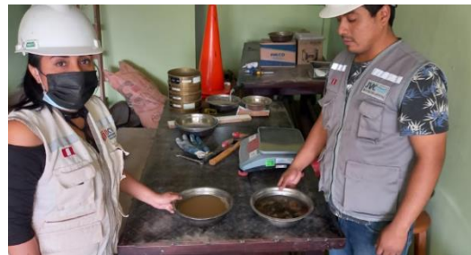
Anexo 13.2. Dejamos reposar con agua a los agregados grueso y fino por 24 horas.
