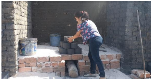
Anexo 23.5. colocación de briquetas en el horno de concreto 350 kg/cm 2 adicionando microfibra 0%, 0.5% y 1% a altas temperaturas.
