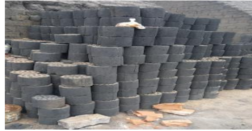
Anexo 23.2. briquetas para el horno de concreto 350 kg/cm 2 adicionando microfibra 0%, 0.5% y 1% a altas temperaturas.
