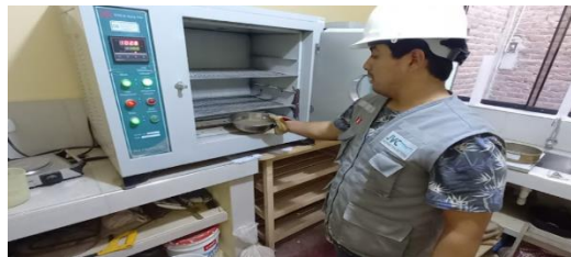
Anexo 18.13. ponemos el recipiente con el agregado fino con agua en el horno.
