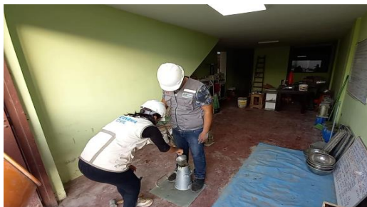
Anexo 19.1. agregamos la mezcla de concreto en cono de abrams.
