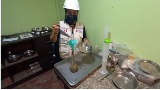
Anexo 18.9. agregamos el agregado fino en la fiola con agua.
