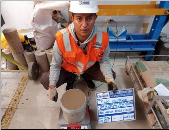
EVIDENCIA FOTOGRAFICA N° 33. DESCRIPCION: Ensayo de peso unitario en el concreto en estado fresco. 2022
