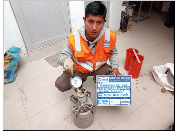
EVIDENCIA FOTOGRAFICA N° 34. DESCRIPCION: Ensayo de contenido de aire en el concreto en estado fresco. 2022
