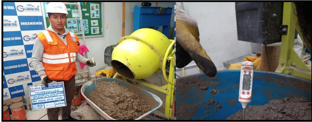
Figura 19. Ensayo de medición de la temperatura del concreto
