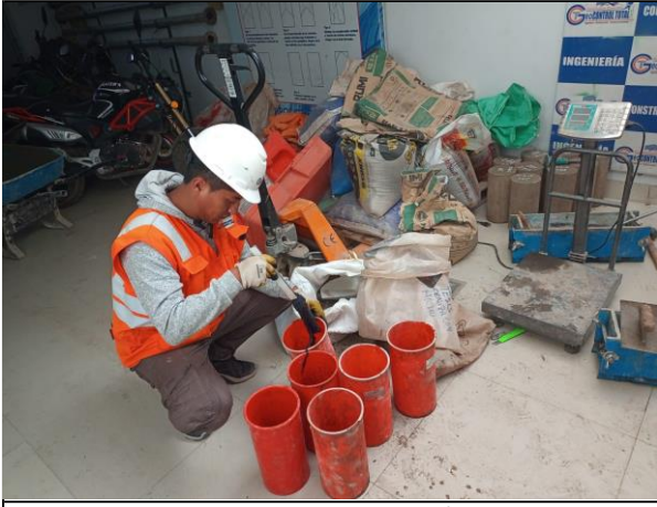
EVIDENCIA FOTOGRAFICA N° 31. DESCRIPCION: Aceitando los moldes para los ensayos a compresion y traccion. 2022
