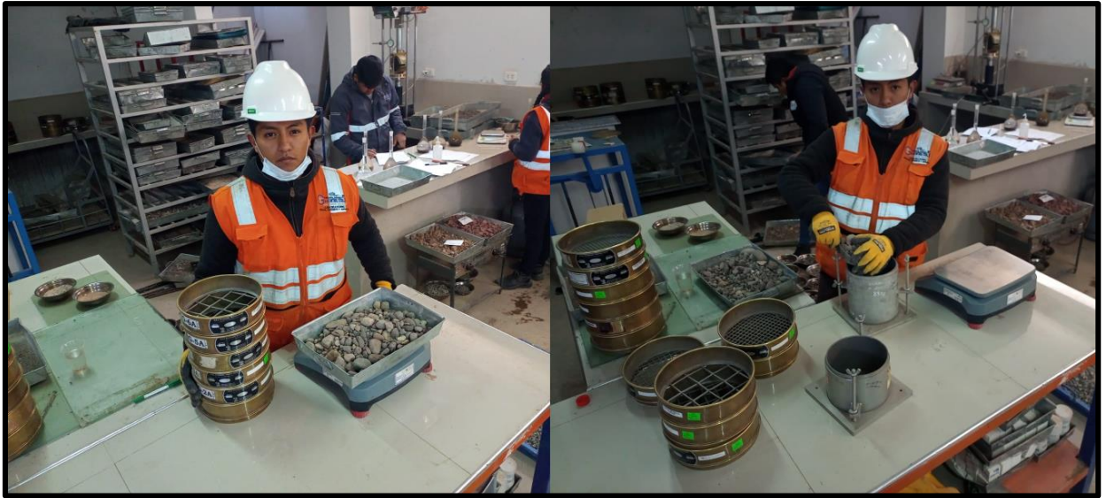
Figura 11. Tamizaje del agregado grueso y determinación del peso específico.
