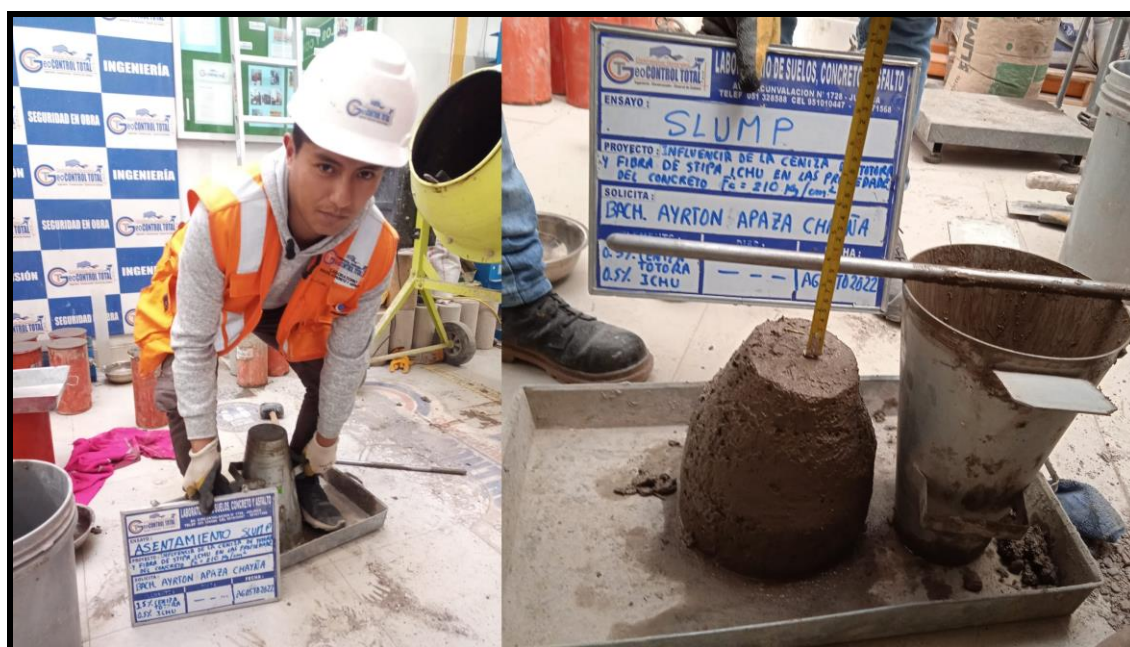
Figura 21. Ensayo de medición de SLUMP
