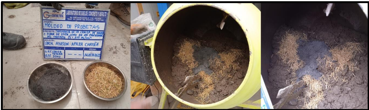
Figura 14. Mezcla de concreto con adición de ceniza de totora y fibra de stipa ichu
