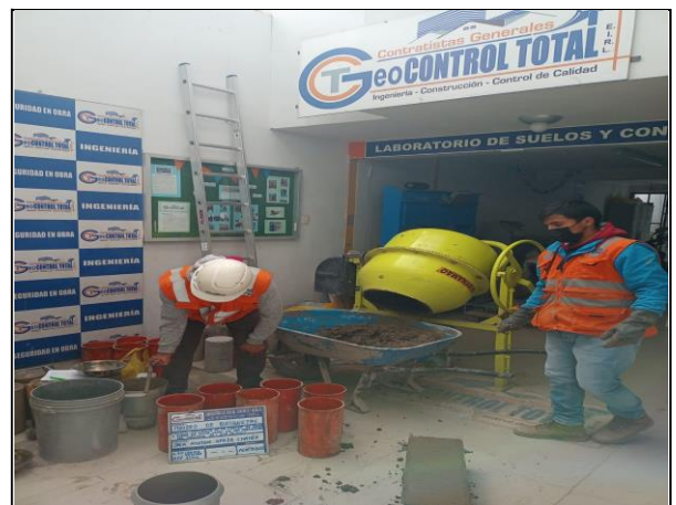
EVIDENCIA FOTOGRAFICA N° 36. DESCRIPCION: Moldeo de briquetas. 2022
