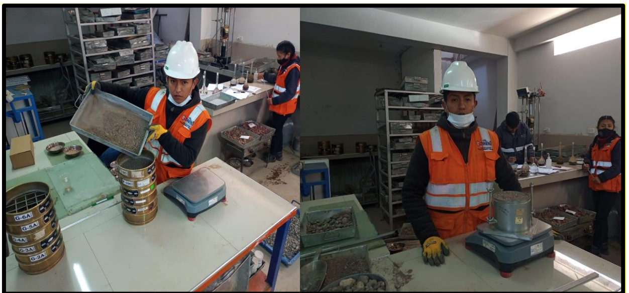
Figura 12. Tamizaje del agregado fino y determinación del peso específico.
