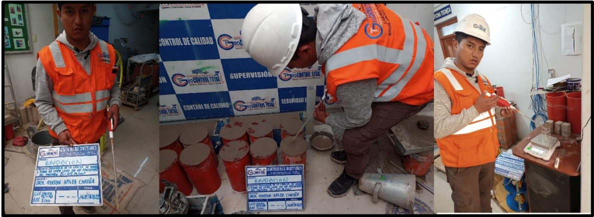
Figura 27. Ensayo de exudación del concreto
