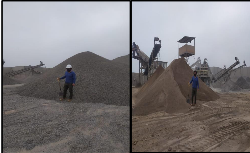
Figura 11: recolección de agregados para el diseño de mezcla 210kg/cm 2 Fuente: Elaboración propia
