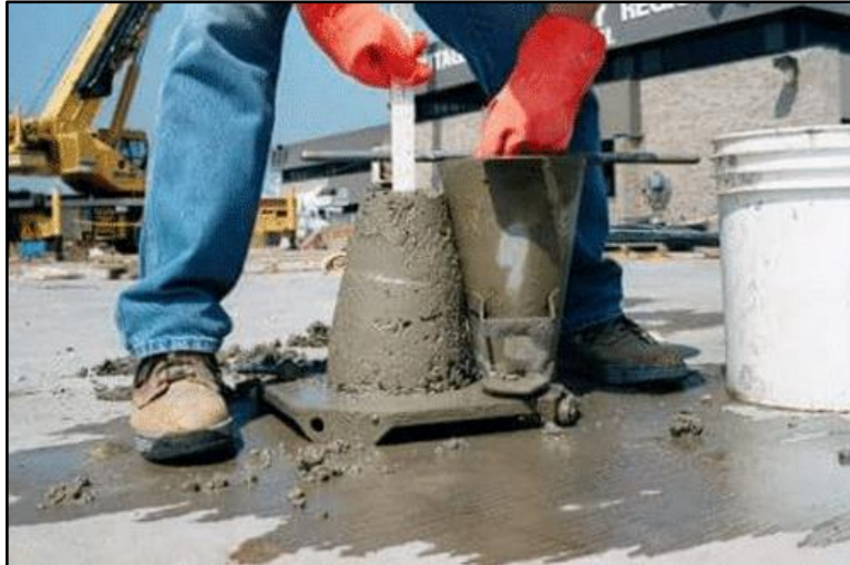
Figura 4. Ensayo de Revenimiento del concreto en estado fresco de concreto. Fuente: ensayo de revenimiento G360, norma ASTM C143.
