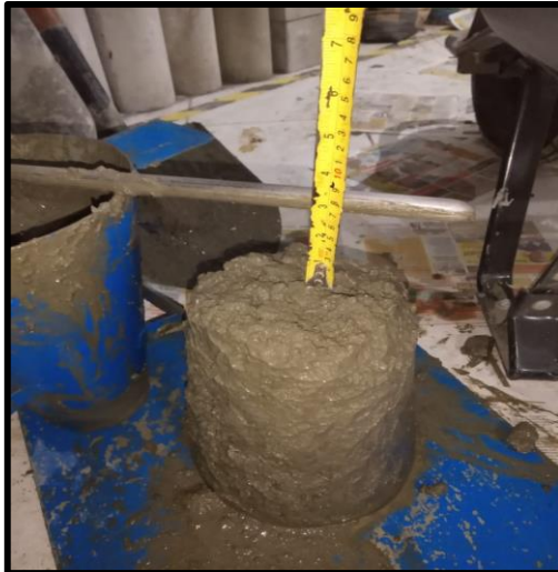
Figura 25: consistencia del concreto patrón.
