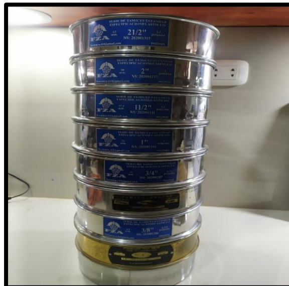
Figura 12: granulometría, tamiz para agregado grueso. Fuente: Elaboración propia
