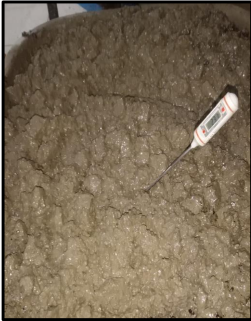
Figura 22: Temperatura del concreto patrón. Fuente: Elaboración propia
