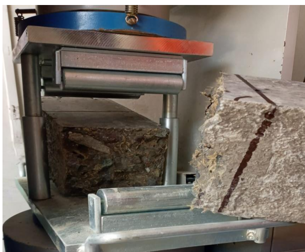
Figura 6. Ensayo a flexión según la norma ASTM C78.
