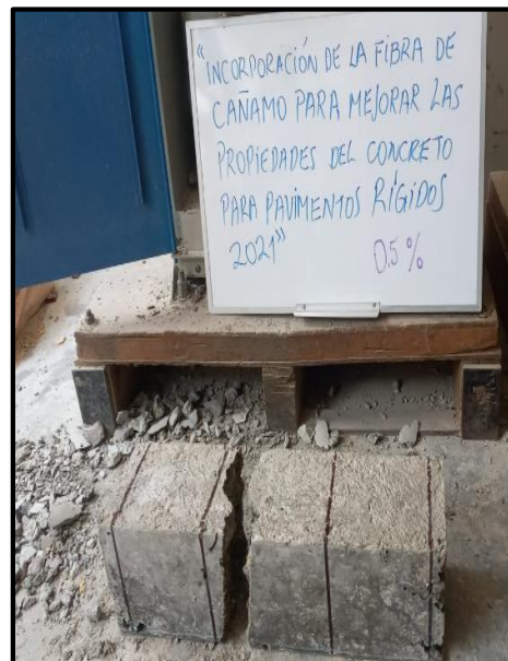
Figura 30: módulo de rotura del concreto con adición de 0.5% de fibra.
