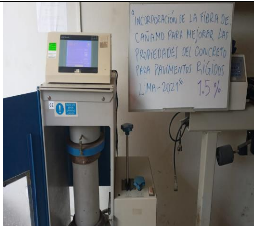
Rotura del concreto a los 28 días con 1.5% de fibra de cañamo
