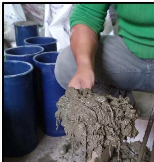
Figura 21: Diseño de concreto con fibra de cáñamo.
