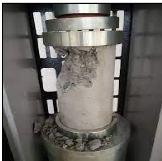
Figura 5. Ensayo a compresión del concreto.
