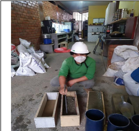
Llenado de vigas de 15x15x50cm
