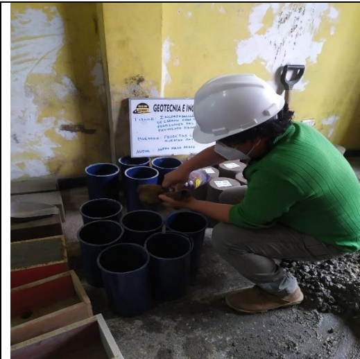
Llenado de probetas cilíndricas 6x12in
