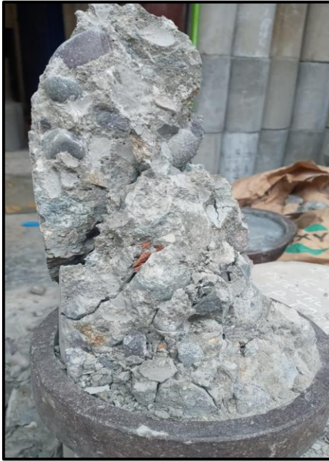
Figura 26: probeta con rotura diagonal Fuente: Elaboración propia
