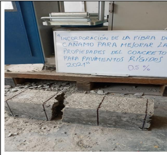
Rotura de viga a los 28 días con 0.5% de fibra de cáñamo
