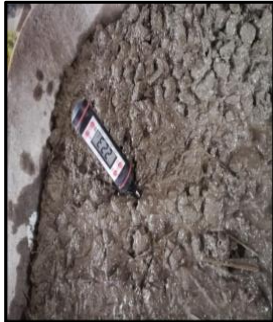
Figura 23: Temperatura del concreto con 1.5% de fibra de cáñamo. Fuente: Elaboración propia
