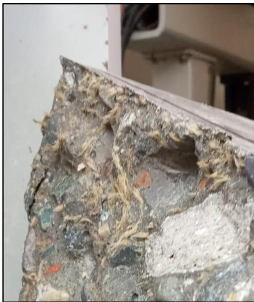
Figura 29: rotura de probeta tipo viga con fibra de cáñamo.
