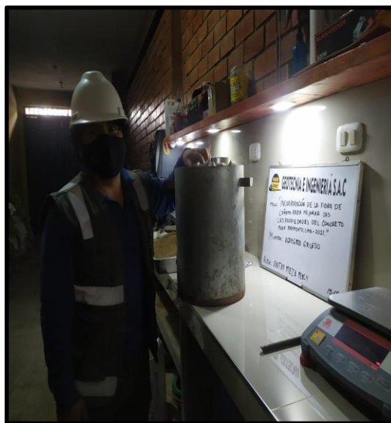
Figura 19: pesado de agregado grueso.
