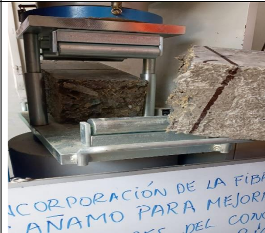
Rotura de viga a los 28 días con 1.5% de fibra de cáñamo
