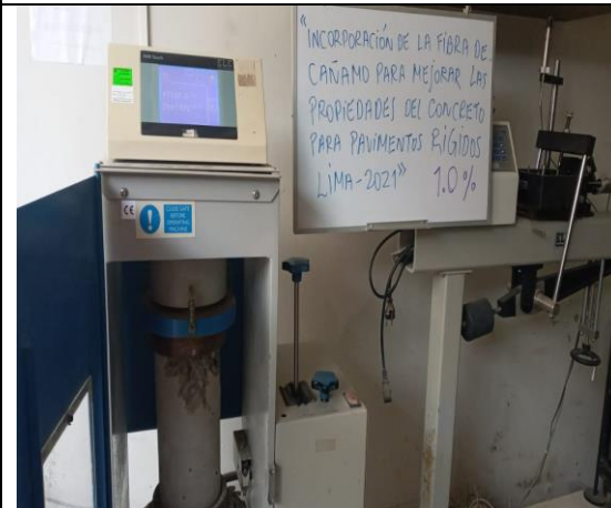
Rotura del concreto a los 28 días con 1% de fibra de cañamo
