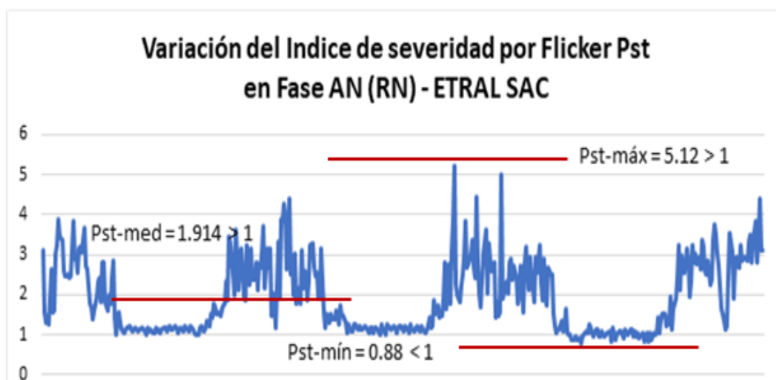
Figura 29: Variación del índice de severidad por Flicker por Fase – Neutro en ETRAL SAC. Elaboración propia
