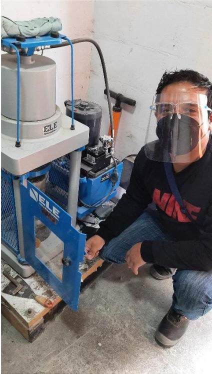
Imagen 17. Ensayo de Resistencia a la compresión
