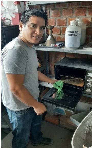
Imagen 3. Determinación del contenido humedad
