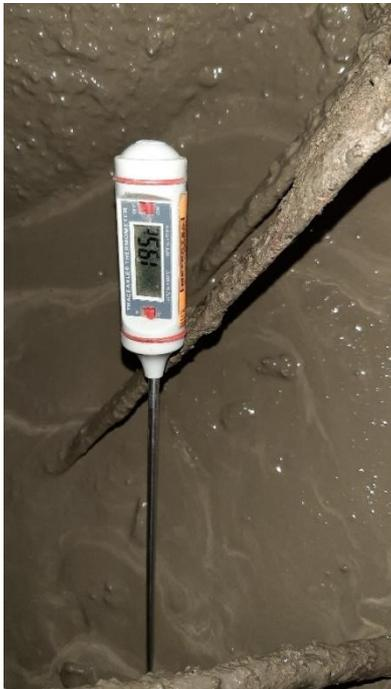
Imagen 11. Temperatura del concreto
