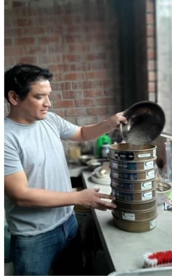
Imagen 2. Tamizado de agregados
