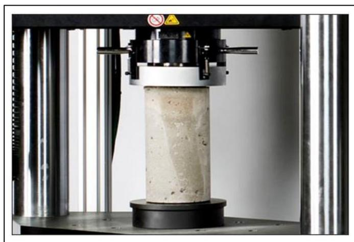
*Figura 2.* Ensayo para obtener la resistencia a la compresión.
