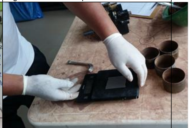
Fig.26.- Pesando las muestras cilíndricas húmedas
