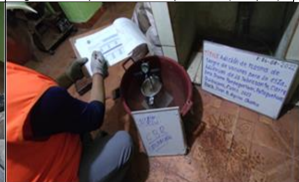
Fig.34.- Se sumerge al agua los 3 moldes y luego se toma lectura.
