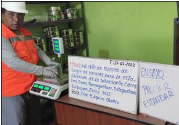
Fig.17.- Pesando el molde
