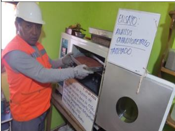
Fig.9.- Secando la muestra en el horno
