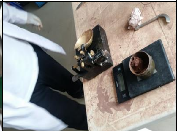
Fig.28.- Pesando las capsulas después de 24h horas.
