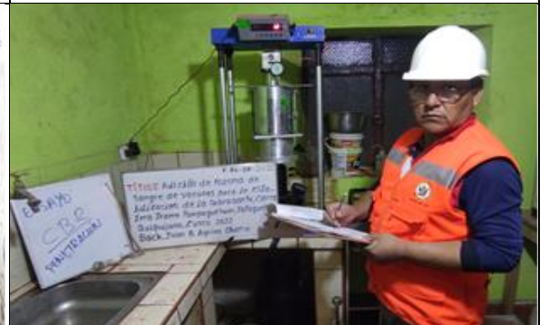
Fig.36.- Ensayo de penetración
