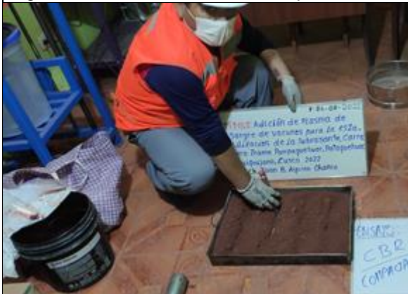
Fig.31.- Dividiendo la muestra para 5 capas
