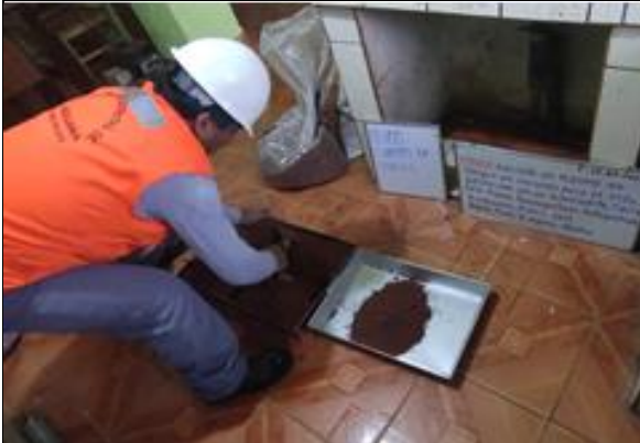
Fig.15.- Realizando cuarteo de la muestra.
