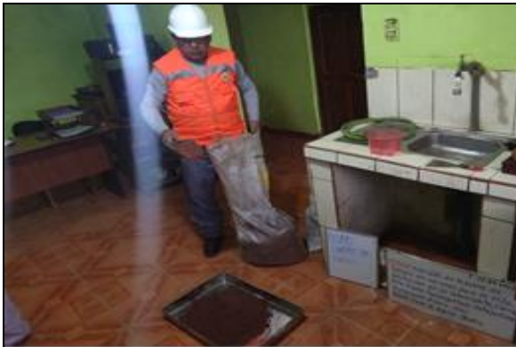
Fig.15.- Sacando la muestra para Proctor
