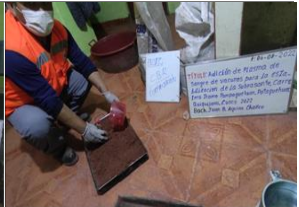
Fig.30.- Amasando muestra con dosificación.
