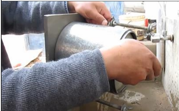
Fig.35.- Se saca del agua y se escurre molde
