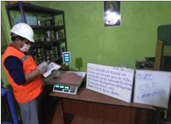
Fig.29.- Pesando muestra secada para el CBR
