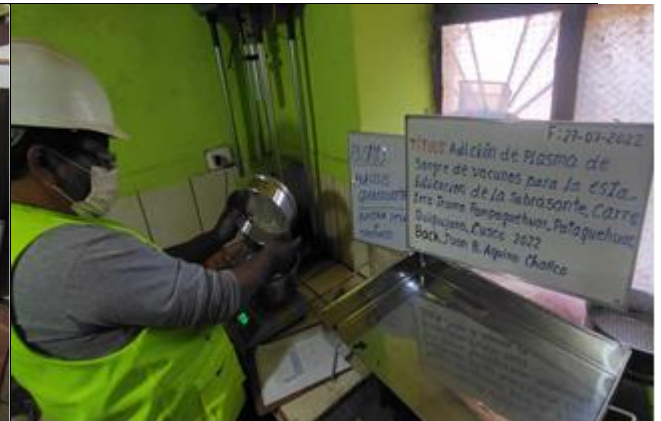
Fig.8.-Pesando la muestra natural
