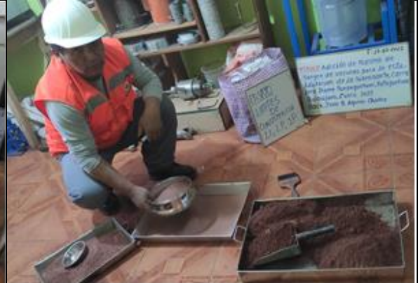
Fig.16.- Tamizando en la malla No 40
