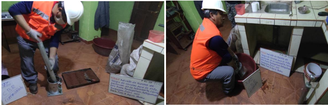
Figura 16. Evidencias del proceso del CBR. (Calicata 02)
