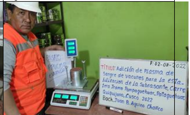
Fig.20.- Pesando el molde con contenido
