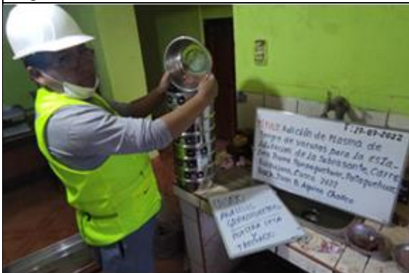
Fig.13.- Clasificando la muestra por tamiz
