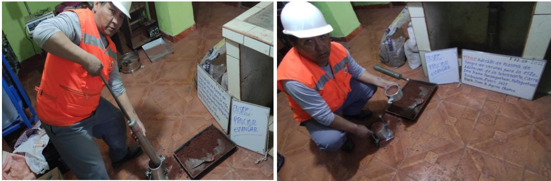
Figura 10. Compactando en el molde y retirando el collar del molde
