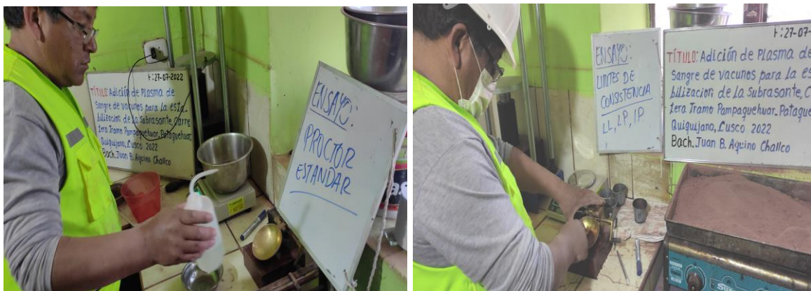
Figura 14. Evidencias límite líquido y límite plástico. (Calicato 02)
