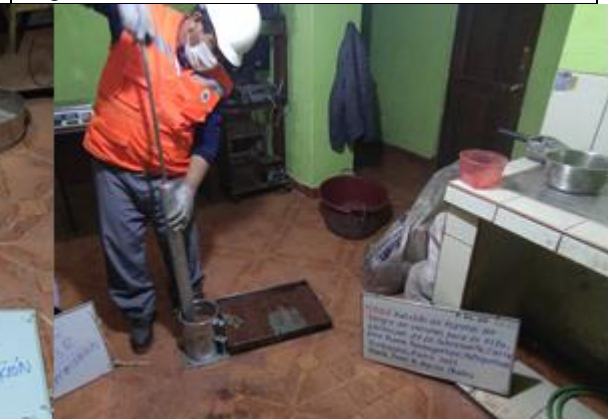
Fig.32.- Compactando el espécimen (5 capas)
