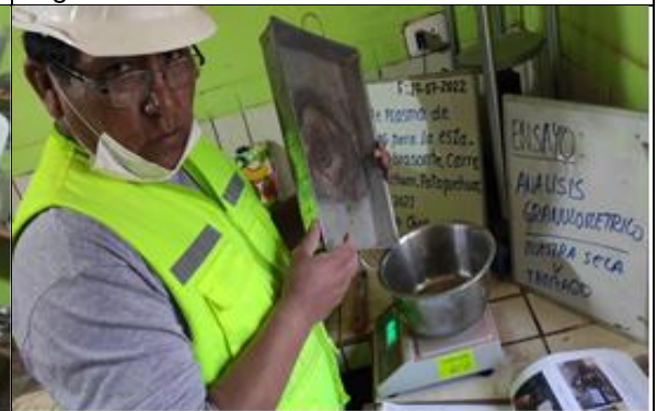
Fig. 12.- Pesando la muestra secada
