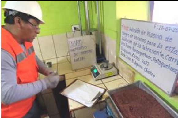
Fig.17.- Pesando capsulas vacias.
