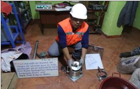
Fig.33.- En molde invertida se pone el disco + collarines.
