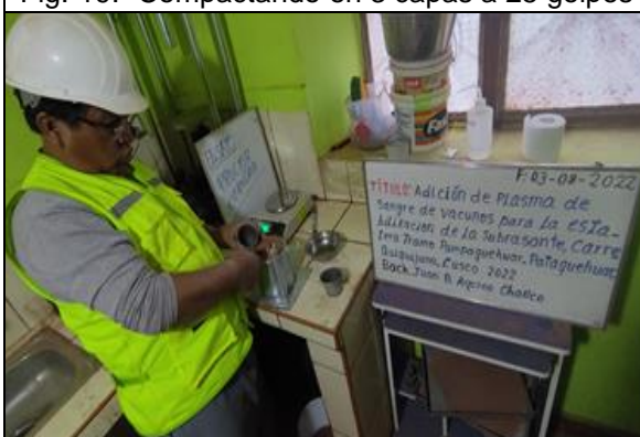
Fig. 21.- Sacando muestra en capsulas.
