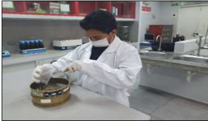
Figura N° 62: Tamizado de excretas con Malla N°4. (Elaboración propia)
