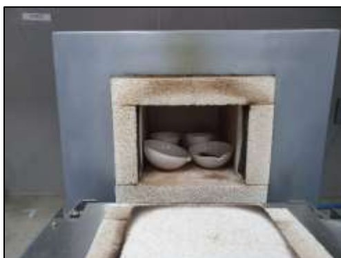
Figura N° 73: 4 muestras en la mufla Elaboración propia
