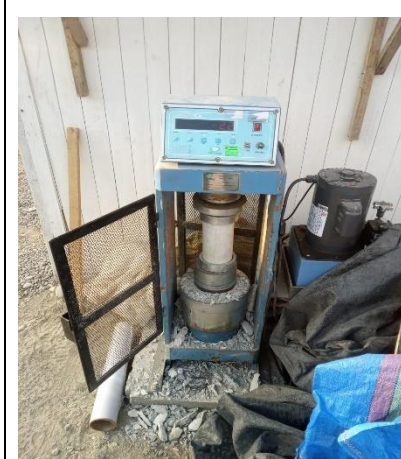
Foto 14: Colocación de la muestra para ensayo de resistencia a la compresión
