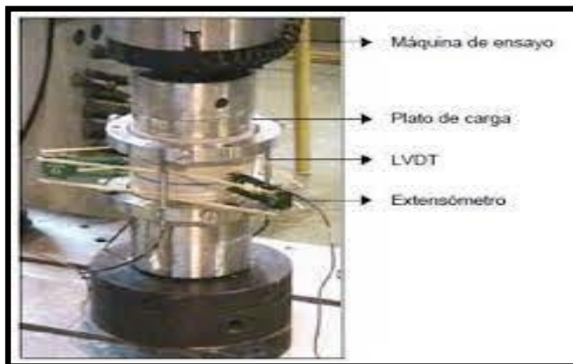
Figura 4. Máquina de ensayo a tracción del concreto
