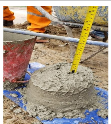
Foto 12: Medición del asentamiento del concreto con aditivo chema plast
