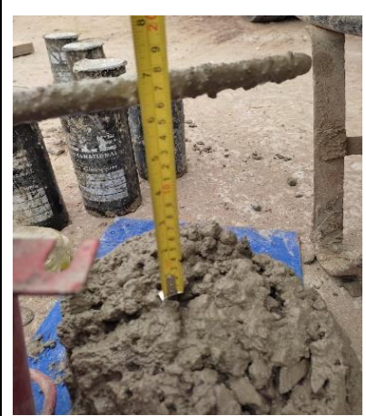
Foto 13: Medición del asentamiento del concreto con grafeno
