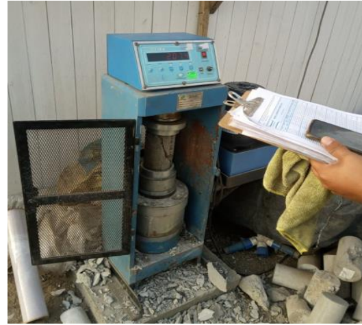
Figura 18: Modo de rotura de la probeta
