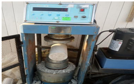
Figura 23: Colocación de la muestra a la máquina de ensayo.
