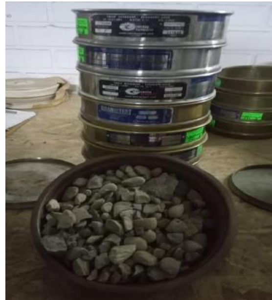
Figura 8: Análisis granulométrico de agregado grueso
