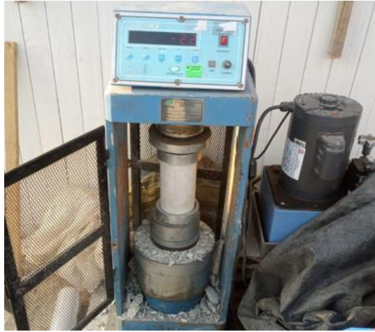
Figura 17: Colocación del testigo en la máquina de ensayo
