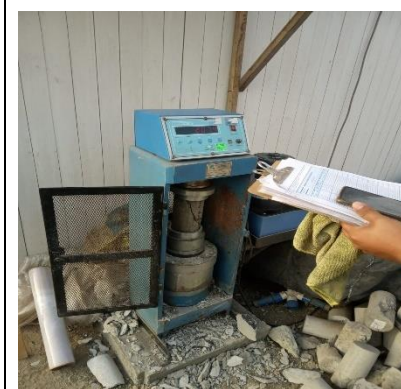
Foto 14: Colocación de la muestra para ensayo de resistencia a la compresión
