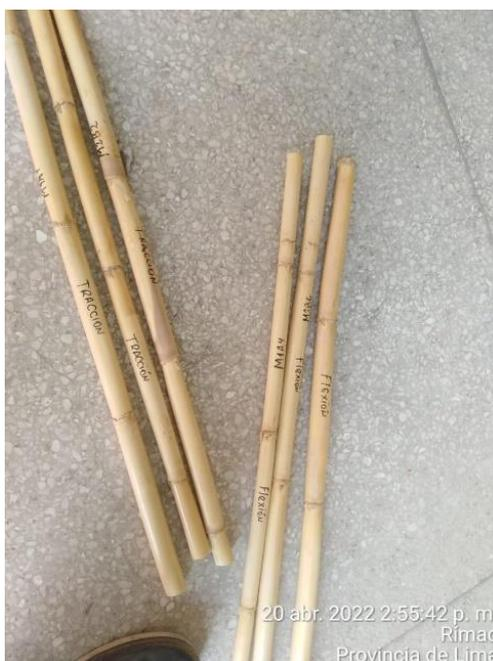
Figura 23. Selección a ensayo a tracción.
