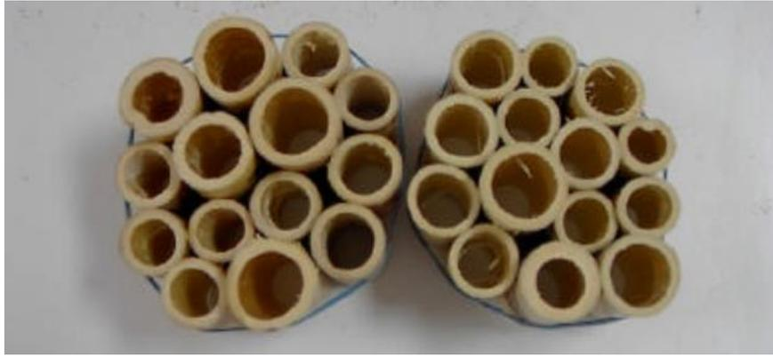
*Figura 5.* Diferentes diámetros y espesores de caña común
