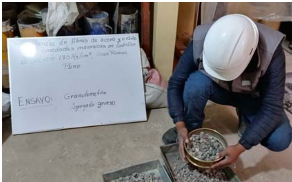
Fotografía 8. “Ensayo de Granulometría del Agregado Grueso mediante el proceso manual”
