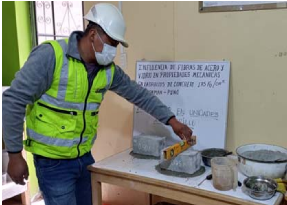
Fotografía 36. “Refrentado de las unidades de ladrillo de concreto”
