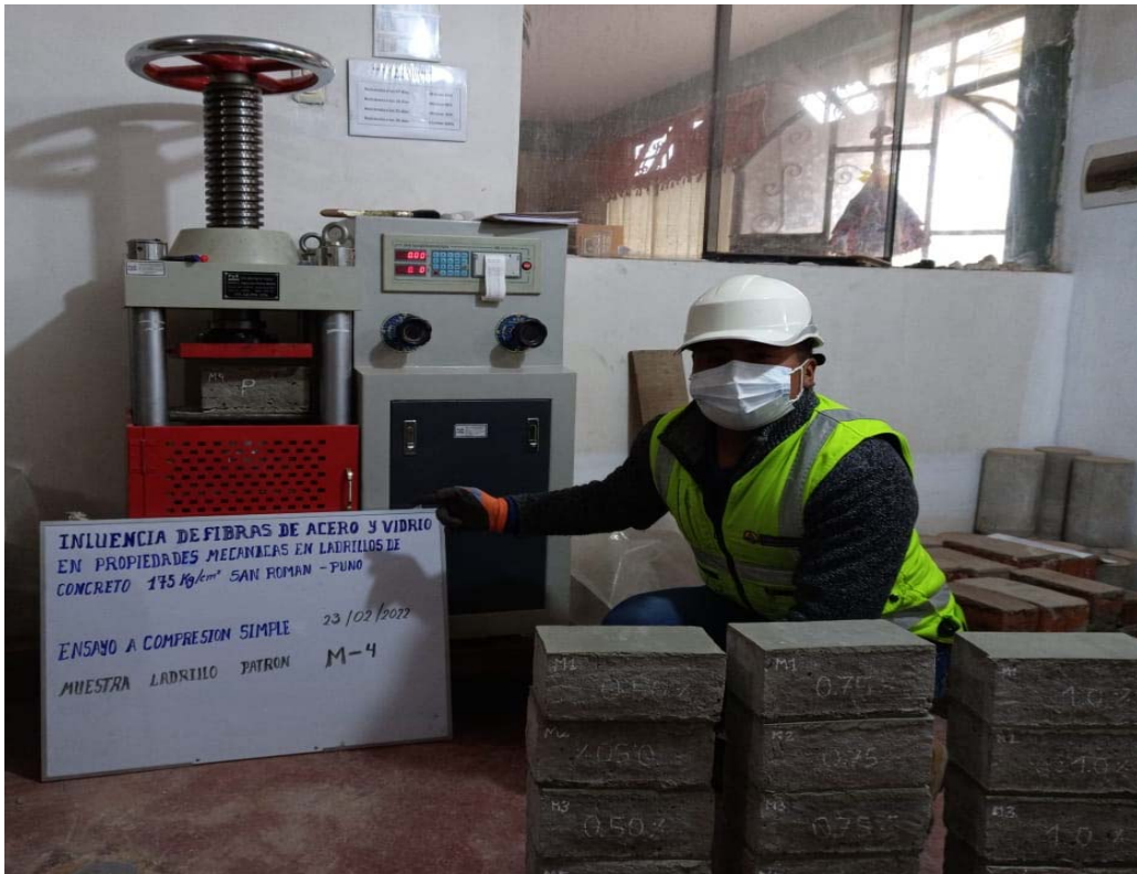
Fotografía 39. “Ensayo de compresión simple de las unidades de ladrillo a los 14 días”
