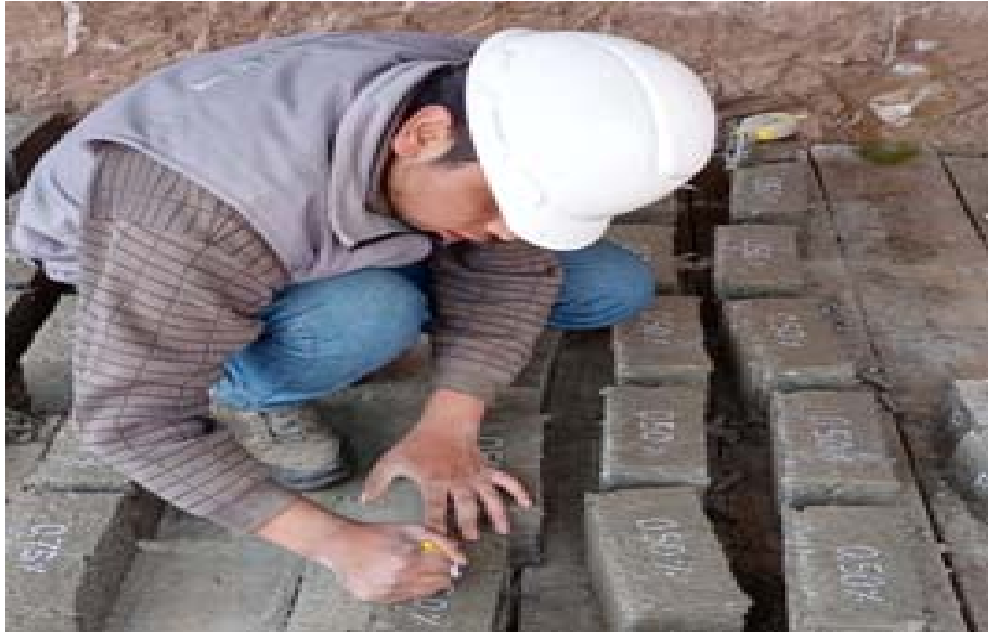
Fotografía 29. “Registro de los distintos porcentajes de adición de fibras”
