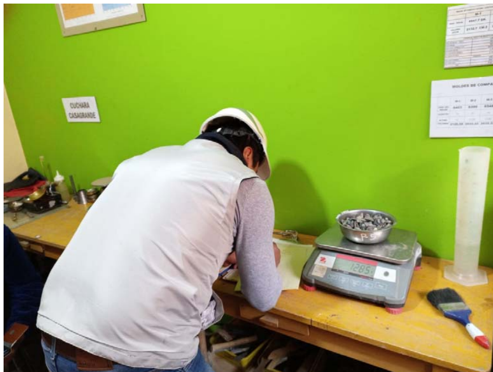
Fotografía 18. “Pesado de la muestra seca para el Ensayo de absorción del agregado grueso”
