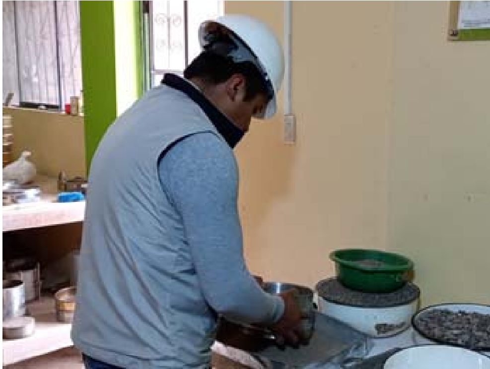
Fotografía 7. “Ensayo de Granulometría del Agregado Fino mediante el proceso manual”
