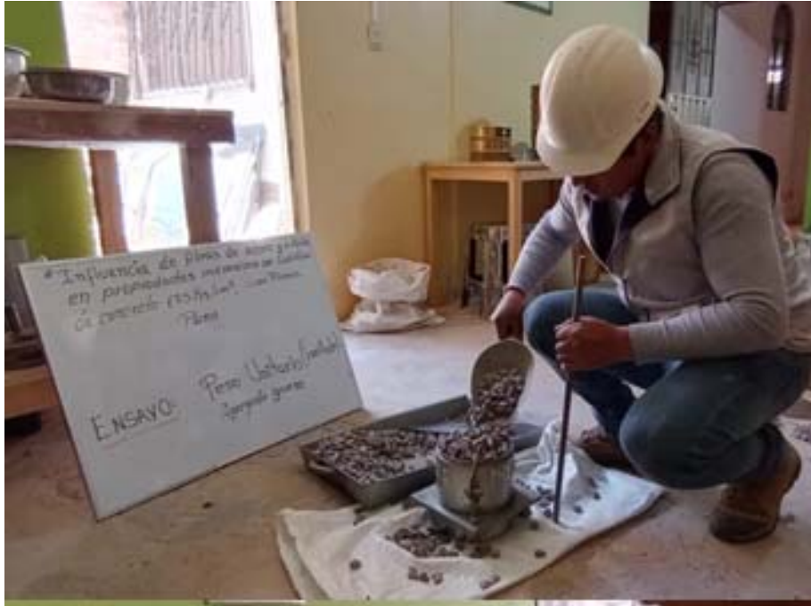
Fotografía 11. “Ensayo para determinar el Peso unitario varillado del Agregado Grueso”
