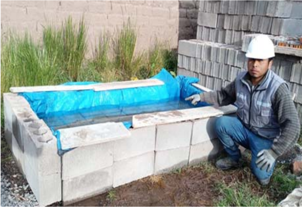
Fotografía 30. “Curado de las muestras de ladrillos”
