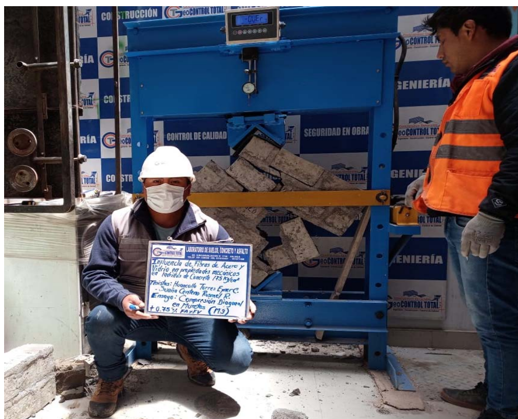
Fotografía 50. “Rotura a compresión diagonal en muretes de ladrillos de concreto a los 28 días”
