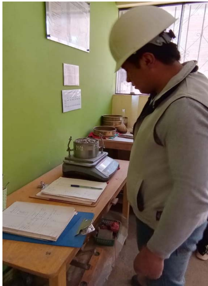
Fotografía 10. “Pesado de la muestra para la determinación del Peso unitario suelto del Agregado Grueso”
