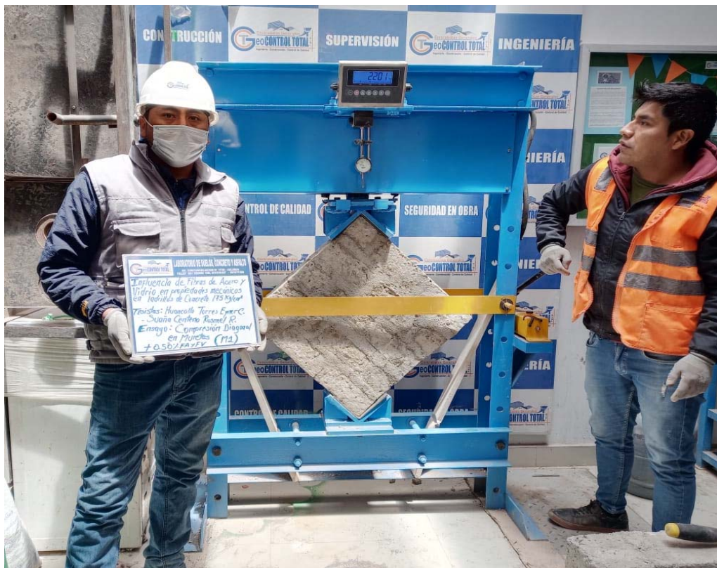
Fotografía 48. “Aplicación de carga para el ensayo a compresión diagonal en muretes de ladrillos de concreto a los 28 días”
