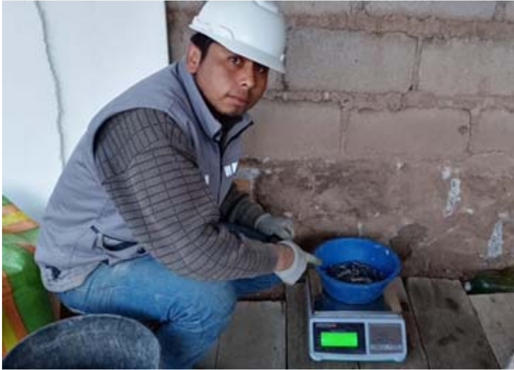
Fotografía 27. “Pesado de las fibras de acero”
