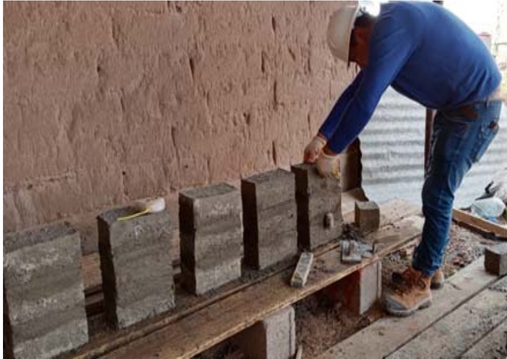
Fotografía 31. “Elaboración de las prismas o pilas de ladrillos de concreto”
