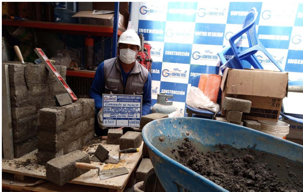
Fotografía 34. “Elaboración de muretes de ladrillos de concreto para la adición de las distintas proporciones de fibras”
