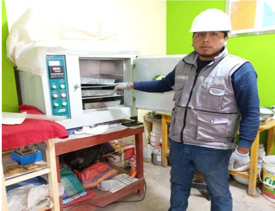
Fotografía 3. “Secado en horno de las muestras de AF y AG (Agregado fino y agregado grueso)”
