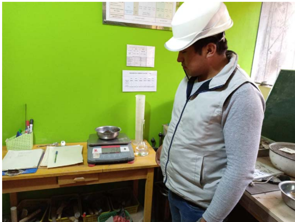
Fotografía 24. “Pesado del material saturado superficialmente seca para el ensayo de absorción y gravedad específica del agregado fino”
