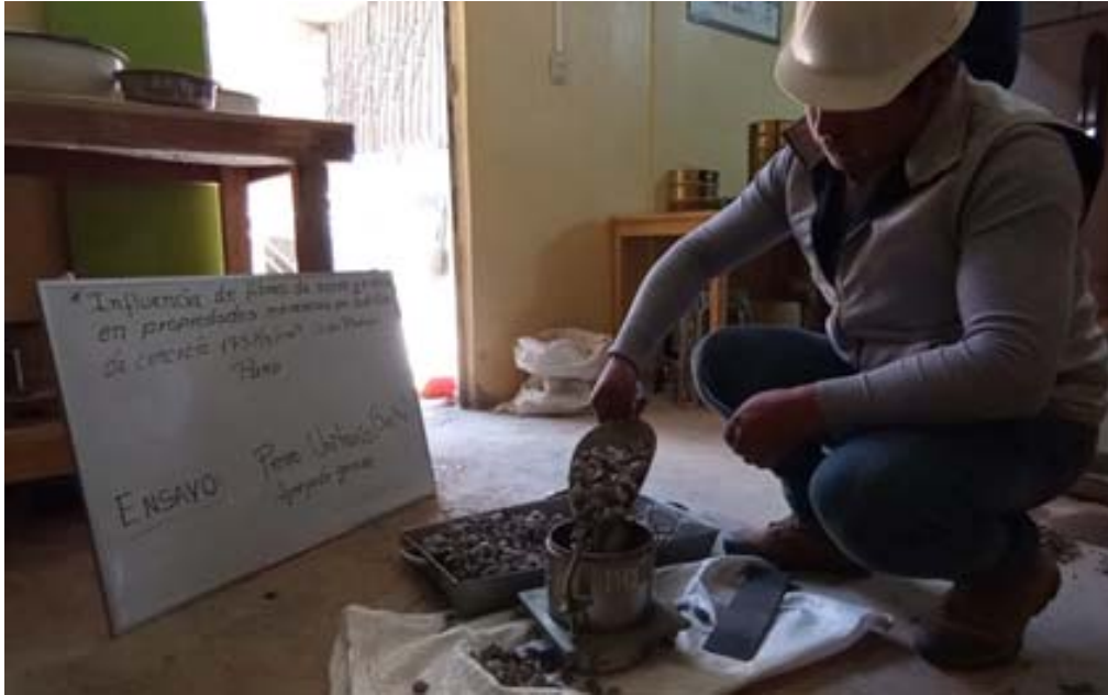
Fotografía 9. “Ensayo de Peso unitario suelto del Agregado Grueso”
