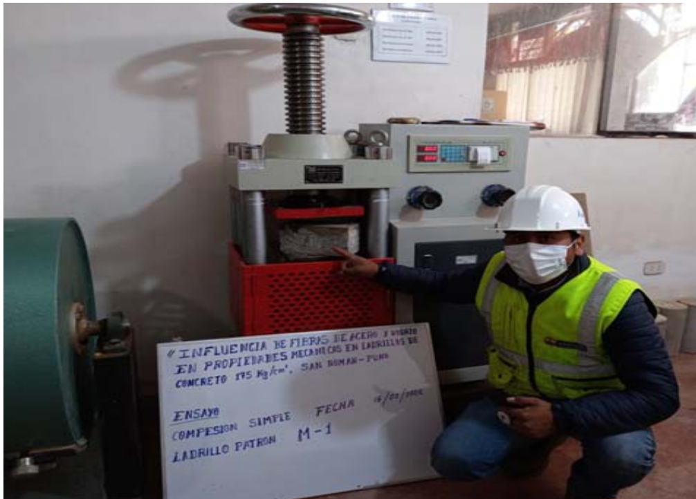
Fotografía 37. “Ensayo de compresión simple de las unidades de ladrillo a los 7 días”
