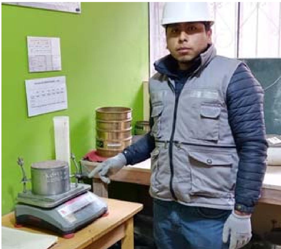
Fotografía 16. “Proceso de pesado de la muestra de Agregado Fino con el molde para el ensayo de Peso unitario suelto del Agregado Fino”
