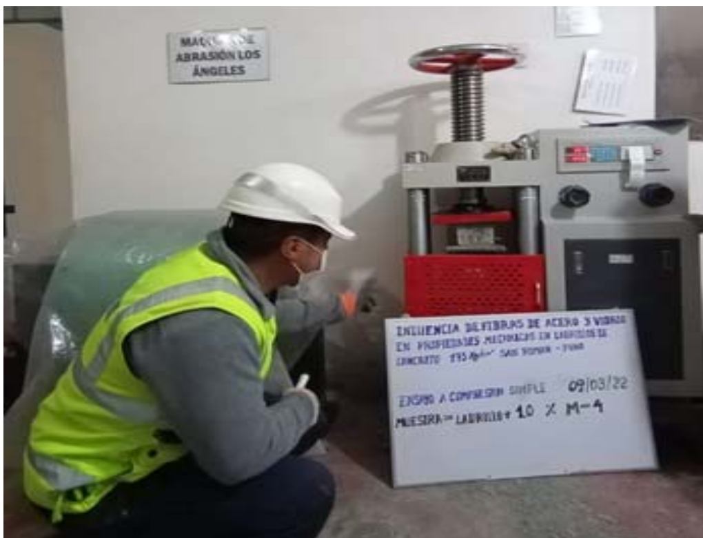
Fotografía 42. “Ensayo de compresión simple de las unidades de ladrillo a los 28 días”
