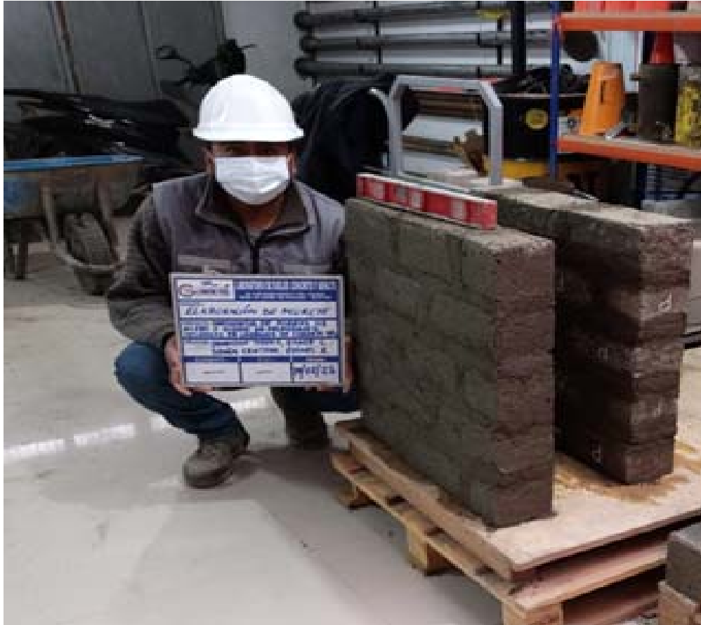
Fotografía 33. “Elaboración de muretes de ladrillos de concreto para la adición de las distintas proporciones de fibras”
