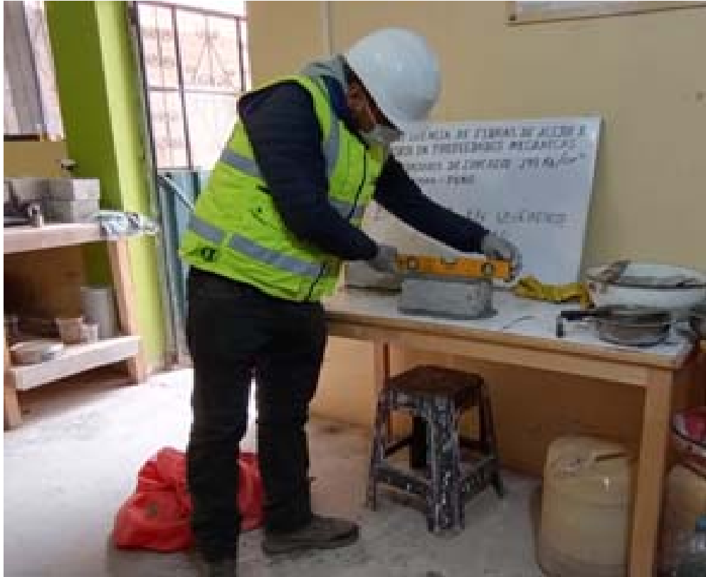
Fotografía 35. “Refrentado de las unidades de ladrillo de concreto”
