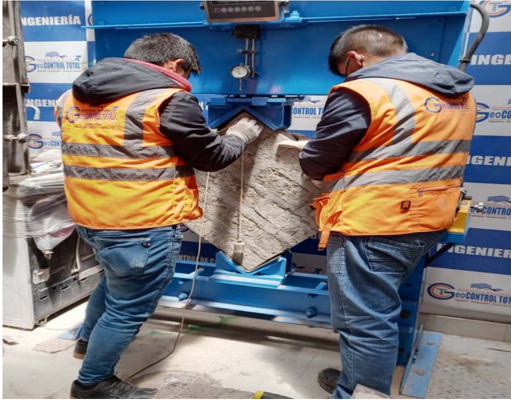
Fotografía 47. “Preparación para el ensayo a compresión diagonal en muretes de ladrillos de concreto a los 28 días”
