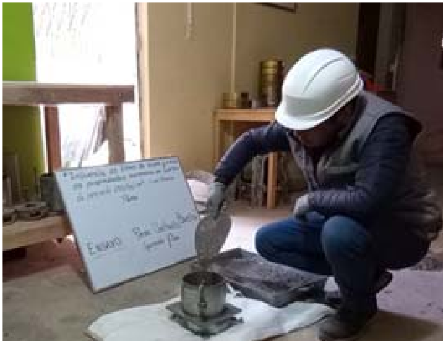
Fotografía 14. “Proceso de colocado de la muestra de Agregado Fino en el molde para el ensayo de Peso unitario suelto del Agregado Fino”
