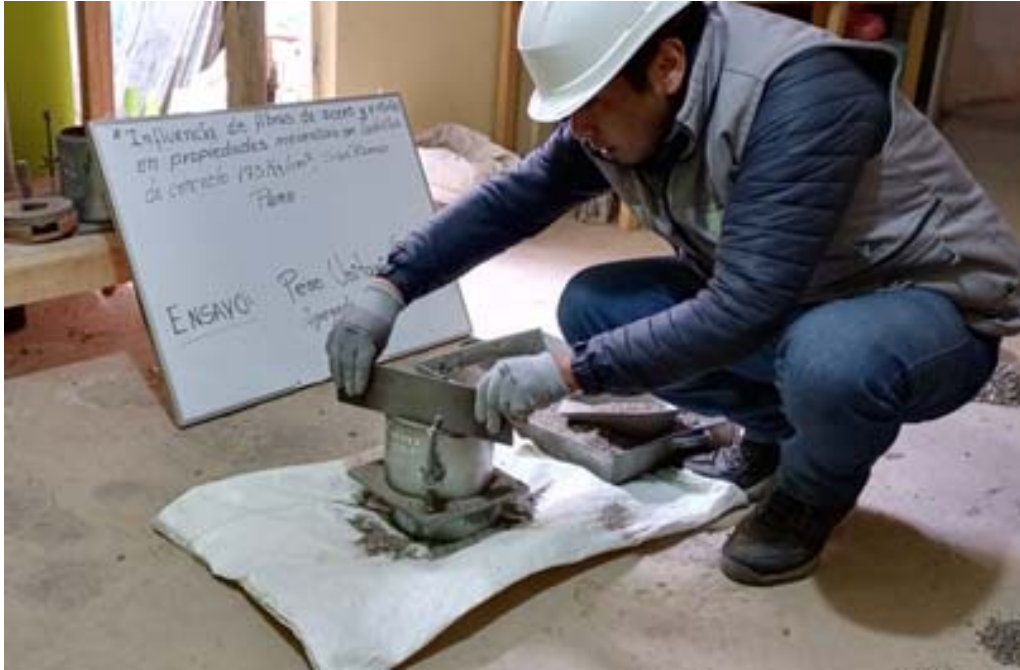
Fotografía 15. “Proceso de enrasado de la muestra de Agregado Fino en el molde para el ensayo de Peso unitario suelto del Agregado Fino”
