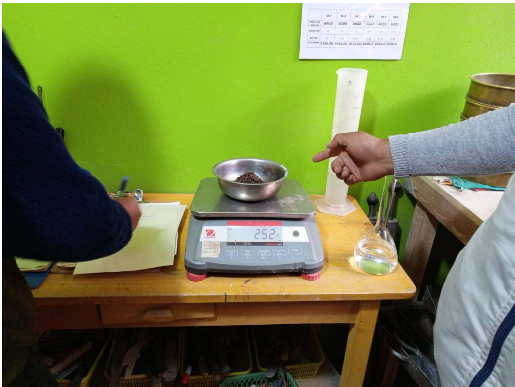
Fotografía 20. “Pesado de la muestra de agregado fino para el Ensayo de absorción del agregado fino”
