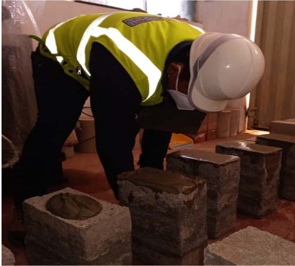
Fotografía 43. “Refrentado de las pilas de ladrillos de concreto”
