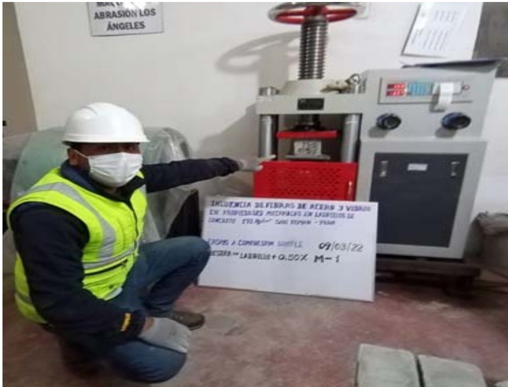
Fotografía 41. “Ensayo de compresión simple de las unidades de ladrillo a los 28 días”
