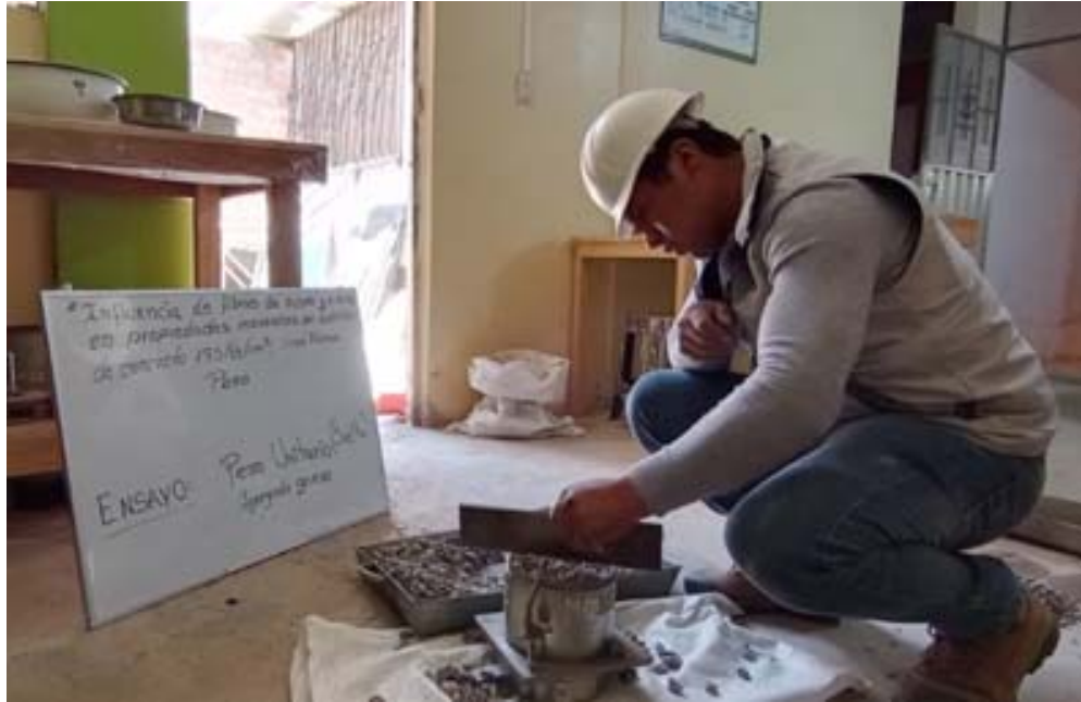
Fotografía 13. “Proceso de enrasado en el ensayo de Peso unitario varillado del Agregado Grueso”
