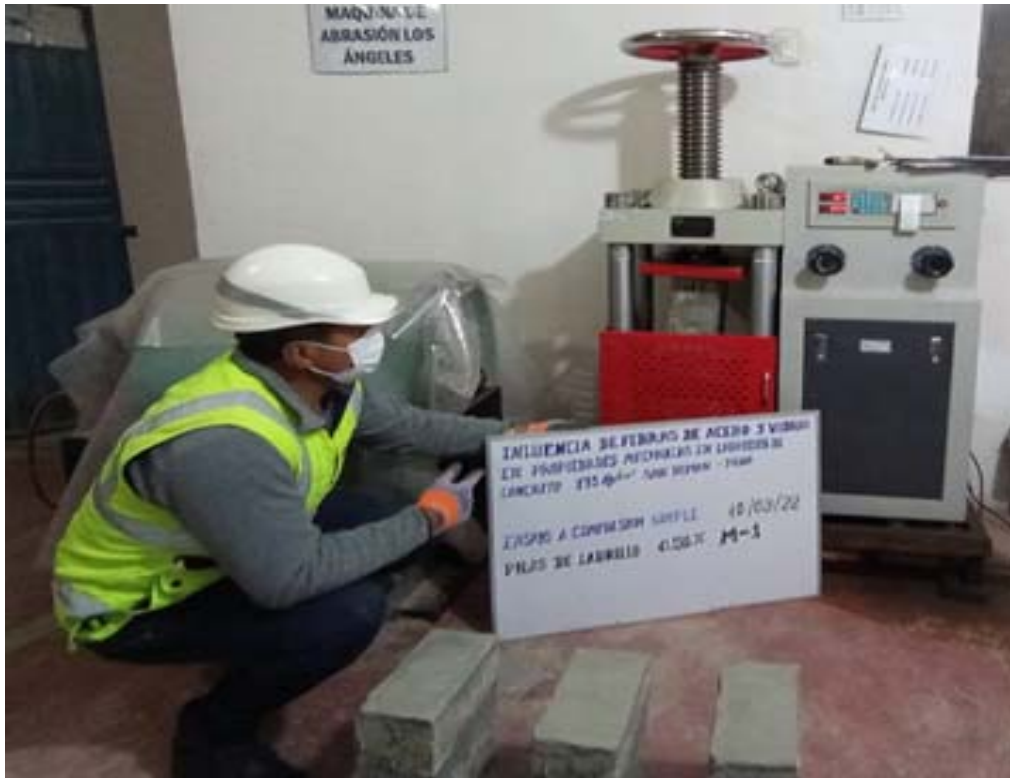
Fotografía 45. “Ensayo de compresión axial en prismas o pilas de ladrillos de concreto a los 28 días”
