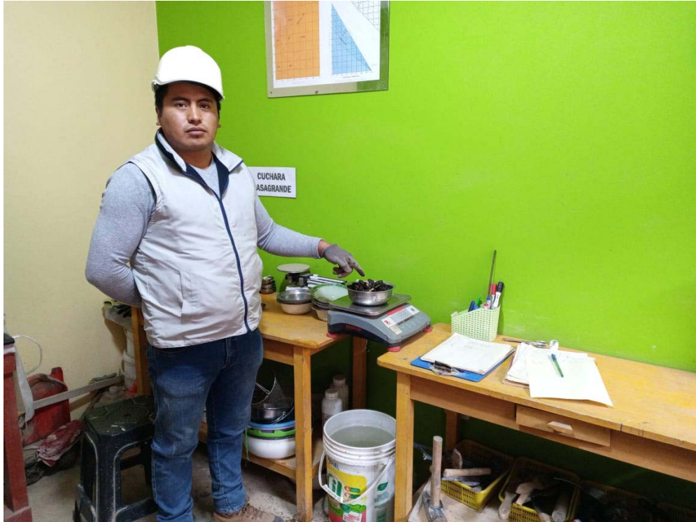
Fotografía 21. “Pesado de la muestra saturada superficialmente seca en el aire para el ensayo de absorción y gravedad específica del agregado grueso”
