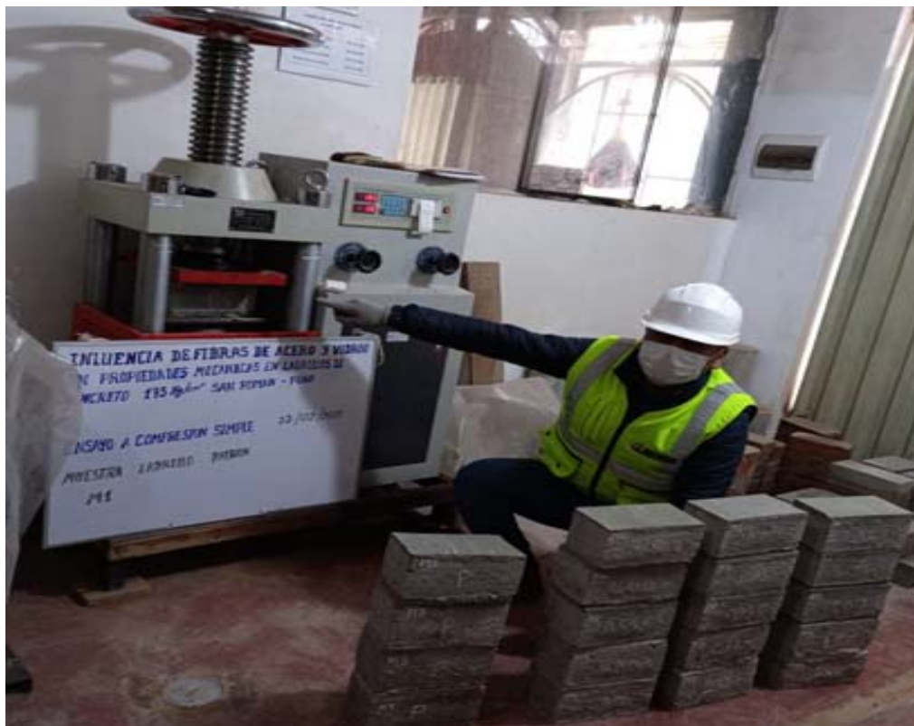
Fotografía 40. “Ensayo de compresión simple de las unidades de ladrillo a los 14 días”
