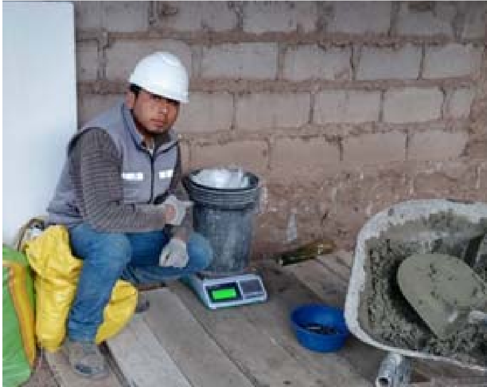
Fotografía 28. “Pesado de la fibra de vidrio”
