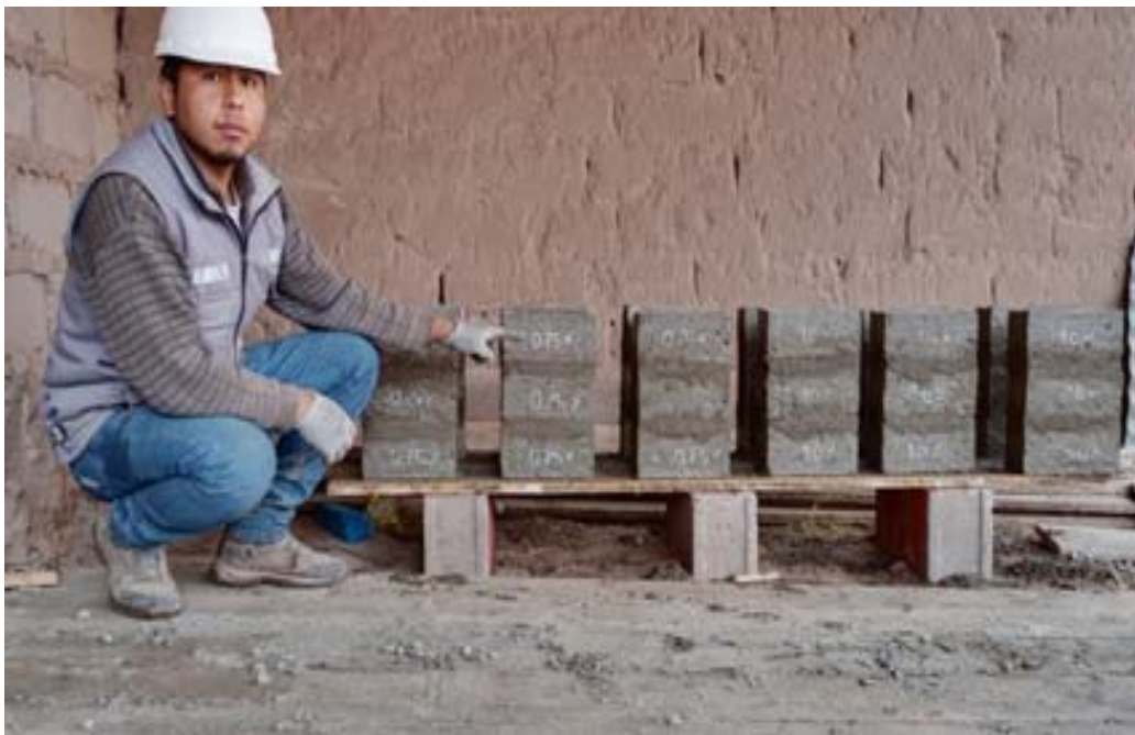
Fotografía 32. “Elaboración final de las prismas o pilas de ladrillos de concreto para la adición de las distintas proporciones de fibras”
