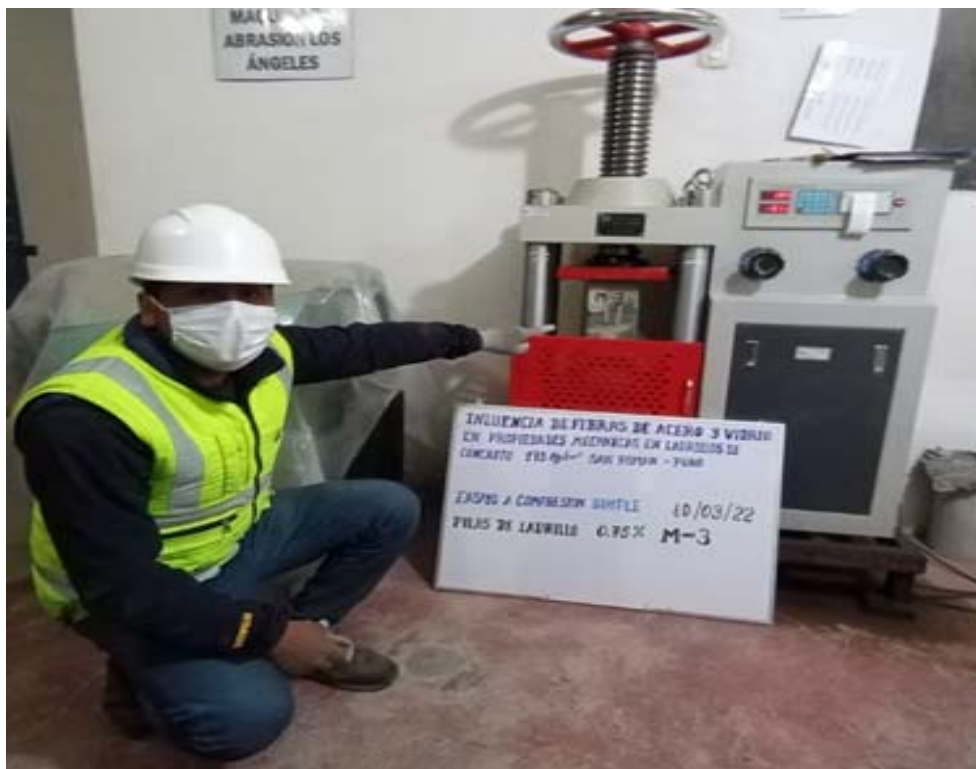
Fotografía 46. “Ensayo de compresión axial en prismas o pilas de ladrillos de concreto a los 28 días”
