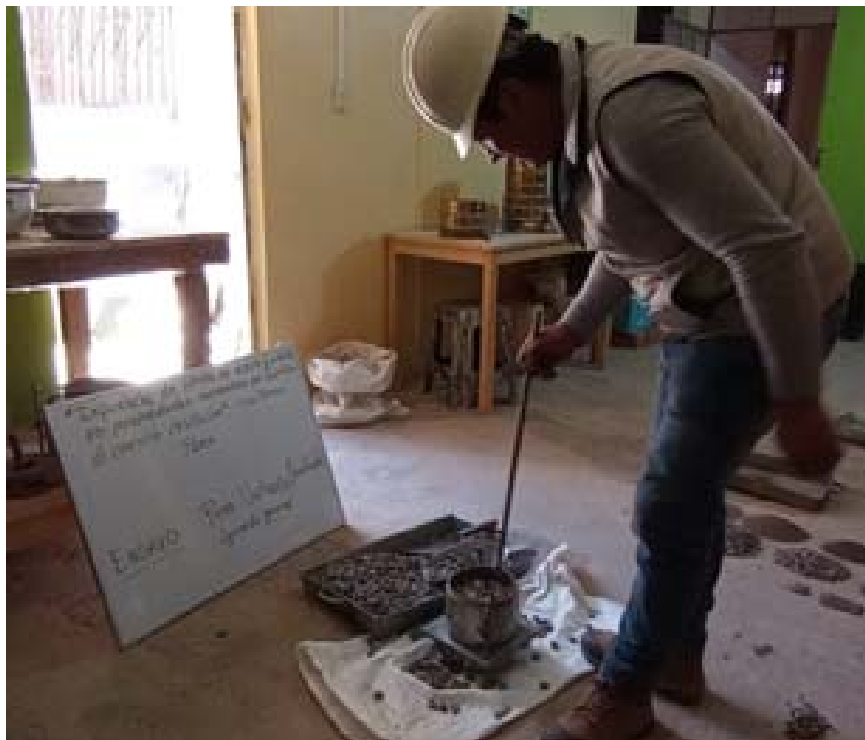
Fotografía 12. “Ensayo para determinar el Peso unitario varillado del Agregado Grueso”
