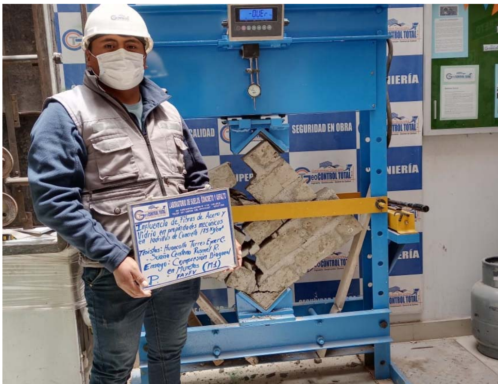
Fotografía 49. “Rotura a compresión diagonal en muretes de ladrillos de concreto a los 28 días”
