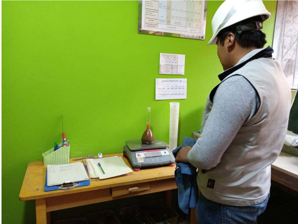
Fotografía 23. “Pesado de la muestra más agua y frasco para el ensayo de absorción y gravedad específica del agregado fino”
