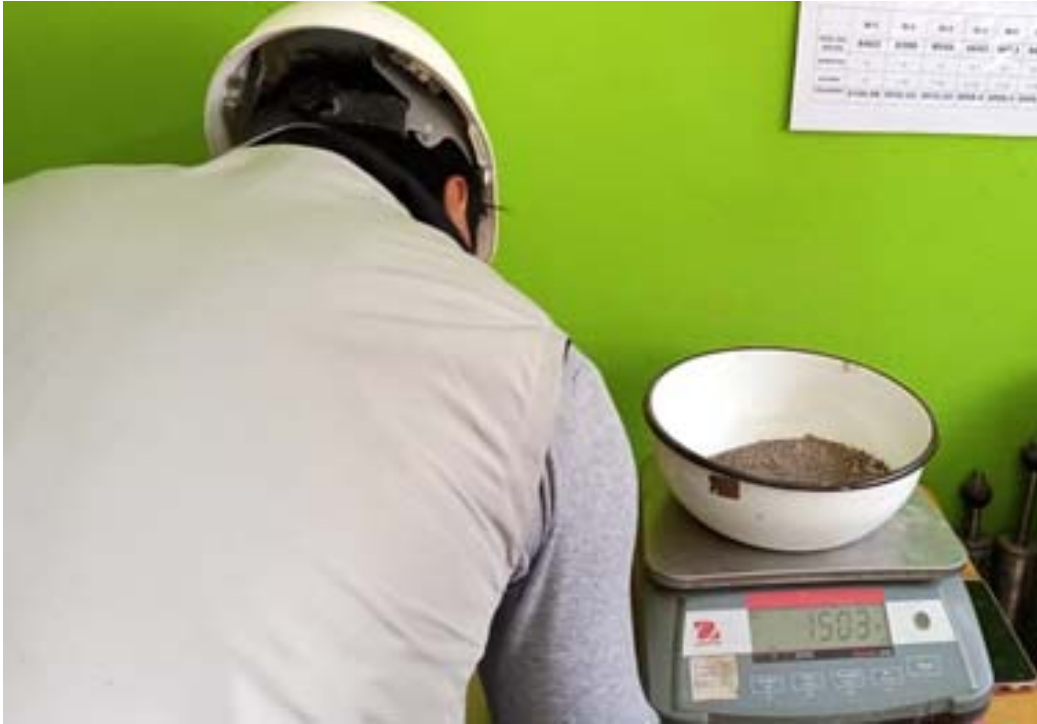
Fotografía 5. “Peso seco de la muestra de Agregado Fino”
