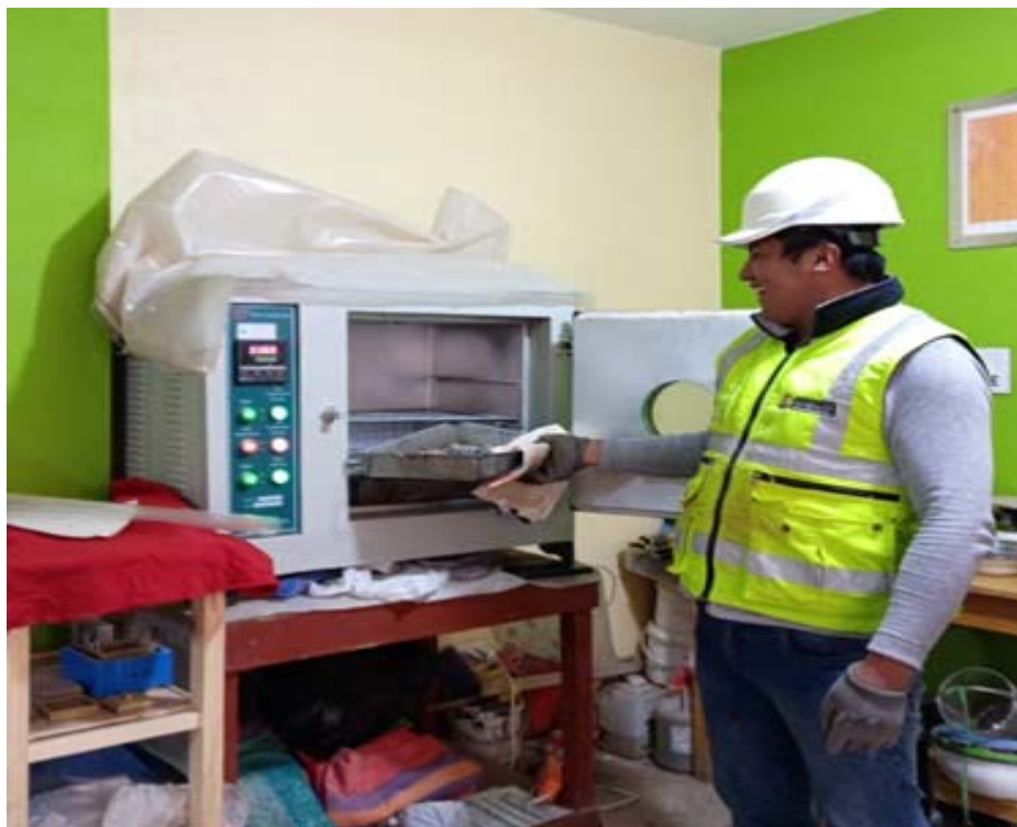
Fotografía 4. “Retirado del horno de las muestras de AF y AG (Agregado fino y agregado grueso)”
